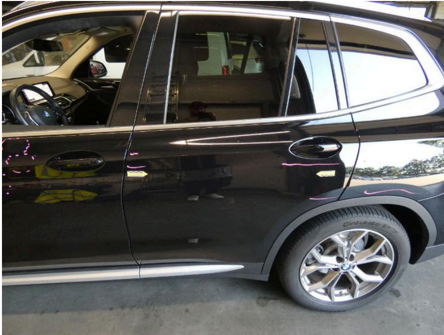
Bild 19 linke Seite Tür hinten (links) verkratzt
