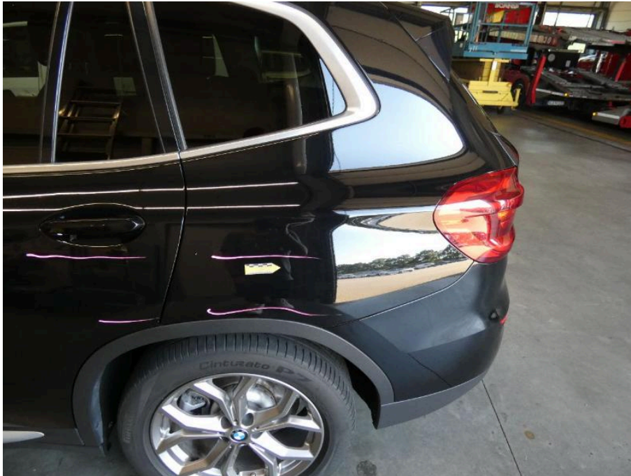
Bild 17 linke Seite Seitenwand (links) verkratzt
