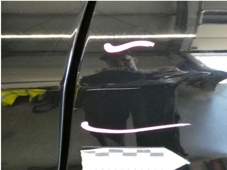
Bild 20 linke Seite Tür hinten (links) verkratzt
