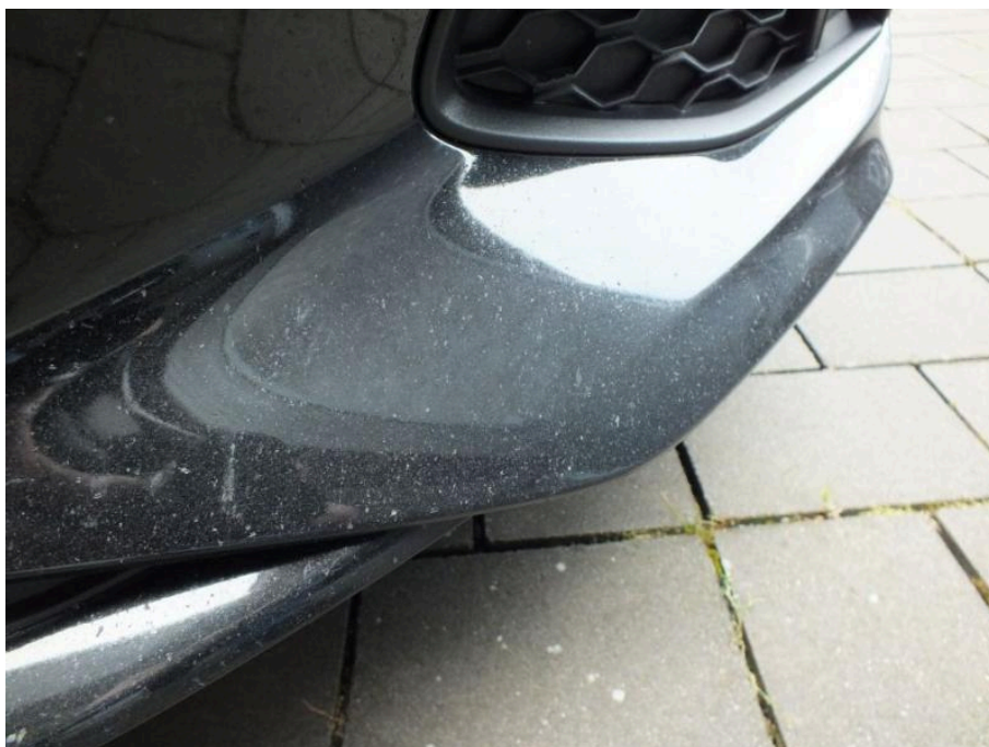
Bild 24 Fahrzeugfront Stoßfänger Steinschlag / -schläge
