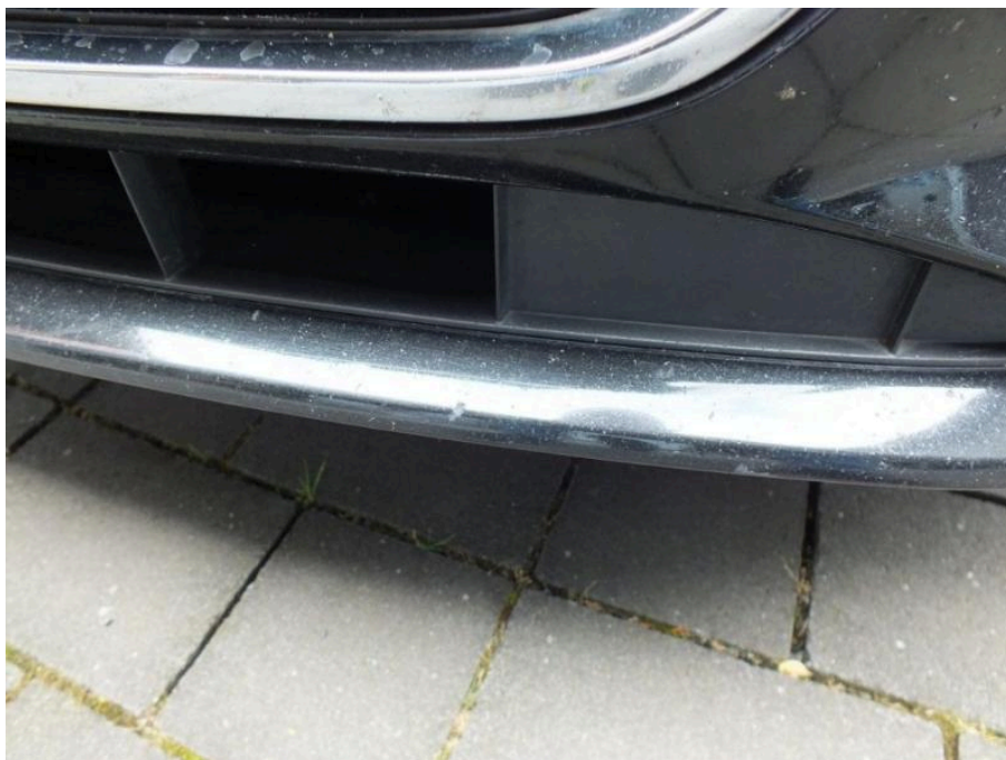
Bild 25 Fahrzeugfront Stoßfänger Steinschlag / -schläge
