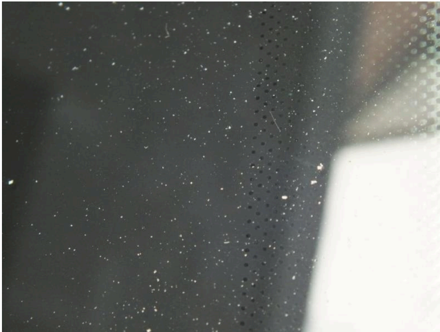
Bild 20 Fahrzeugfront Frontscheibe Steinschlag / -schläge
