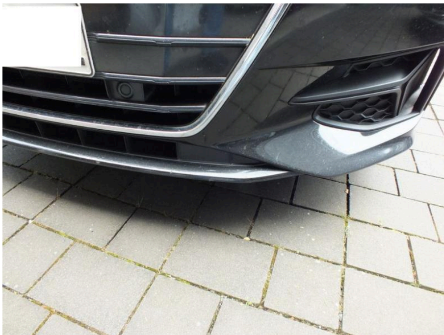
Bild 23 Fahrzeugfront Stoßfänger Steinschlag / -schläge
