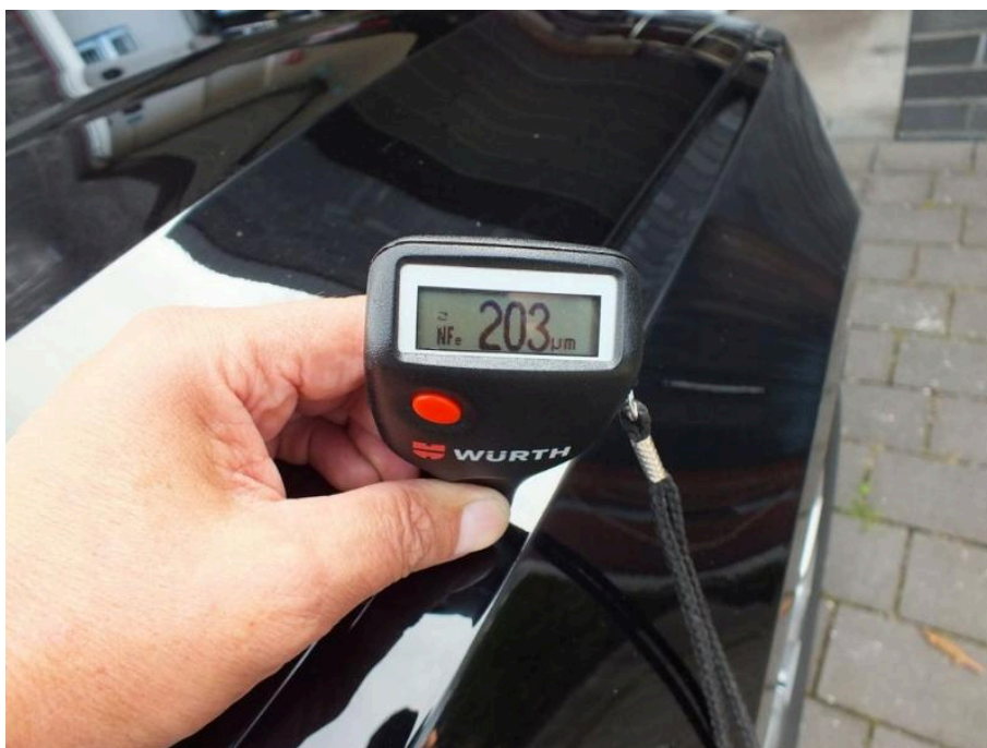
Bild 32: Kotflügel rechts erhöht gemessene Lackschichtstärke
