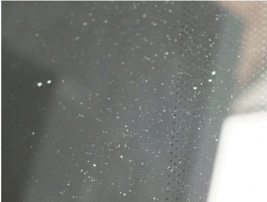
Bild 19 Fahrzeugfront Frontscheibe Steinschlag / -schläge
