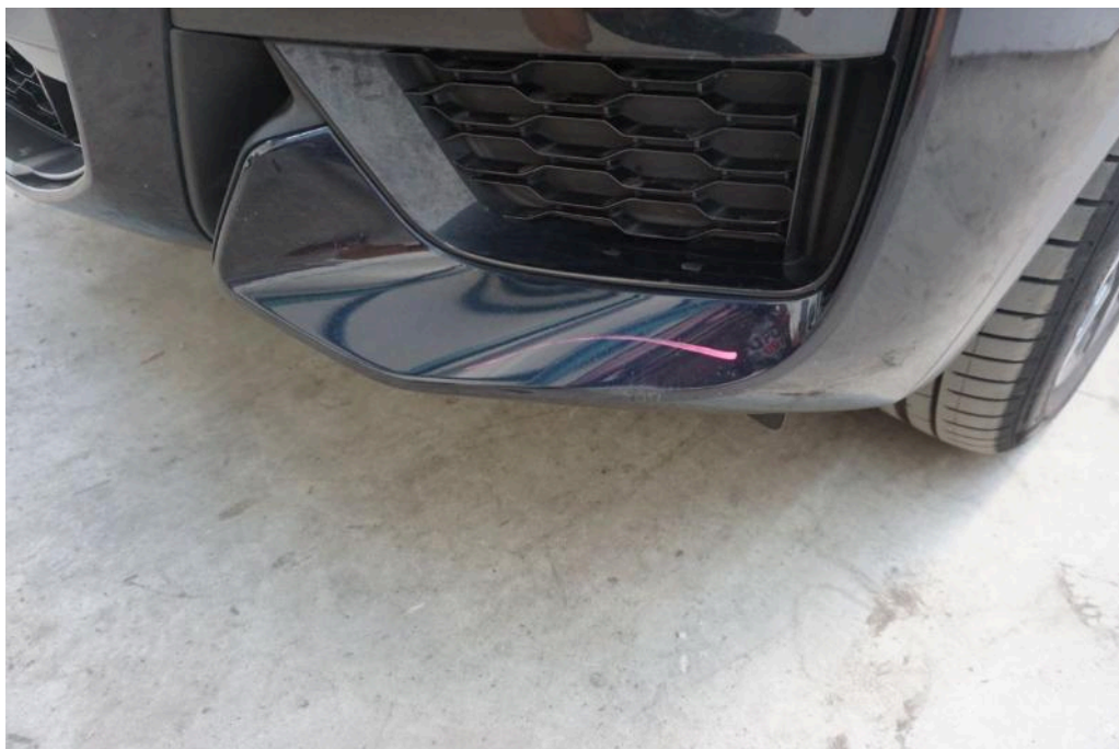
Bild 19 Fahrzeugfront Stoßfänger verschürft Materialabtrag
