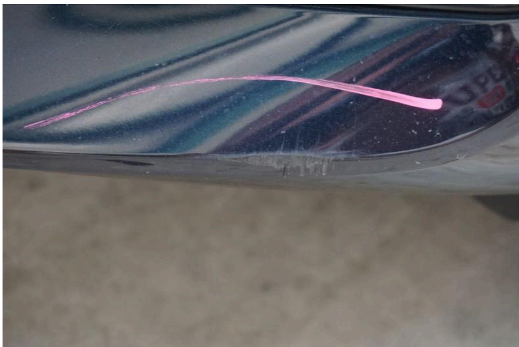
Bild 20 Fahrzeugfront Stoßfänger verschürft Materialabtrag
