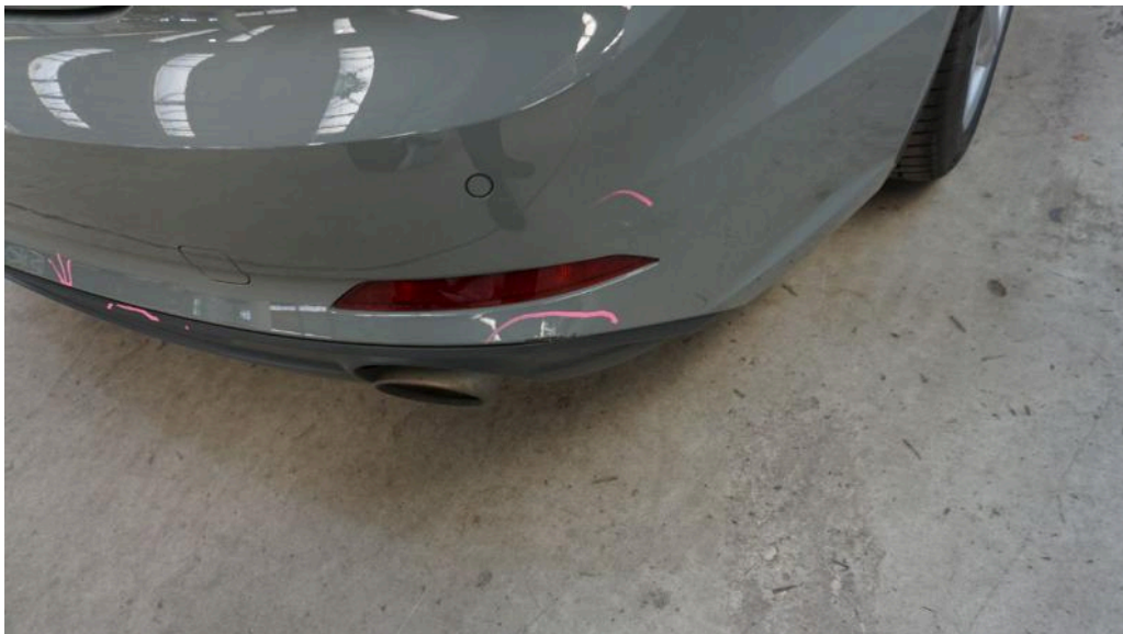
Bild 50 Fahrzeugheck Stoßfänger (hinten) Die Stoßstange ist leicht verformt und im kannten Bereich mit starkem Materialabtrag. Diffusor lackieren angestoßen
