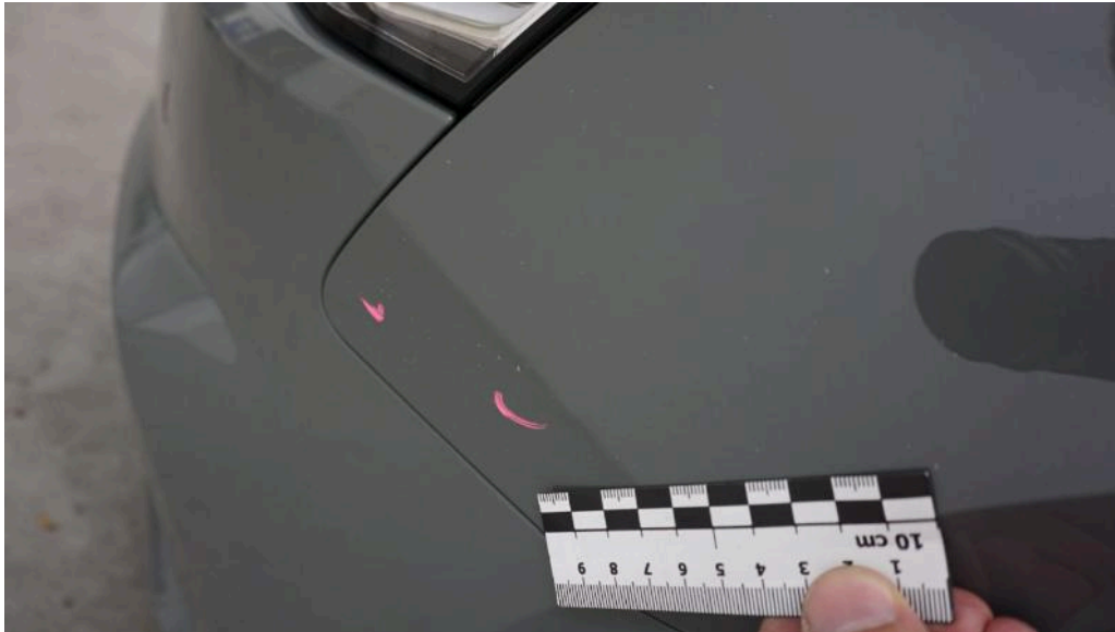
Bild 31 linke Seite Kotflügel vorne (links) Steinschlag / -schläge
