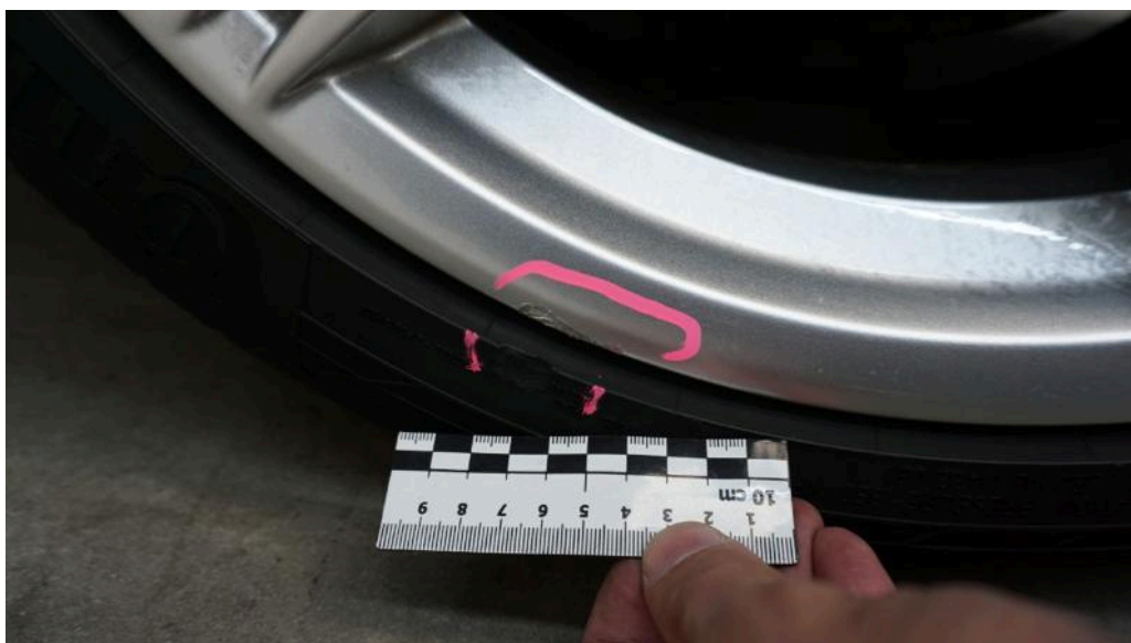
Bild 34 Vorderachse Felge links (vorne) verschürt, Vorderachse Reifen links (vorne) eingeschnitten
