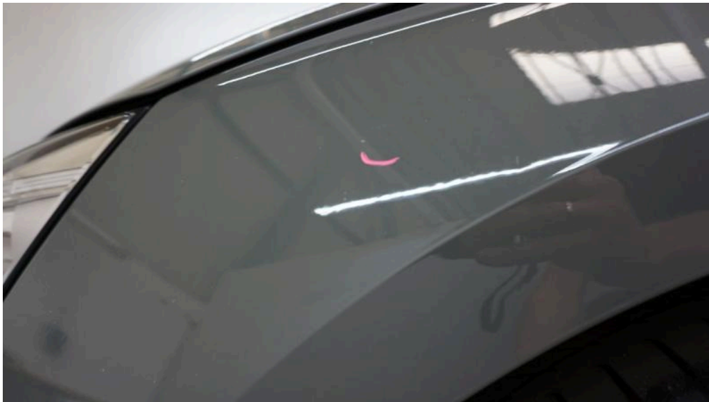
Bild 32 linke Seite Kotflügel vorne (links) Steinschlag / -schläge
