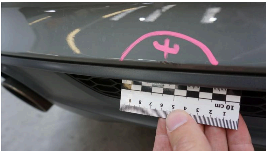
Bild 44 Fahrzeugheck Stoßfänger (hinten) Die Stoßstange ist leicht verformt und im kannten Bereich mit starkem Materialabtrag. Diffusor lackieren angestoßen
