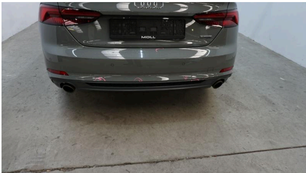
Bild 43 Fahrzeugheck Stoßfänger (hinten) Die Stoßstange ist leicht verformt und im kannten Bereich mit starkem Materialabtrag. Diffusor lackieren angestoßen
