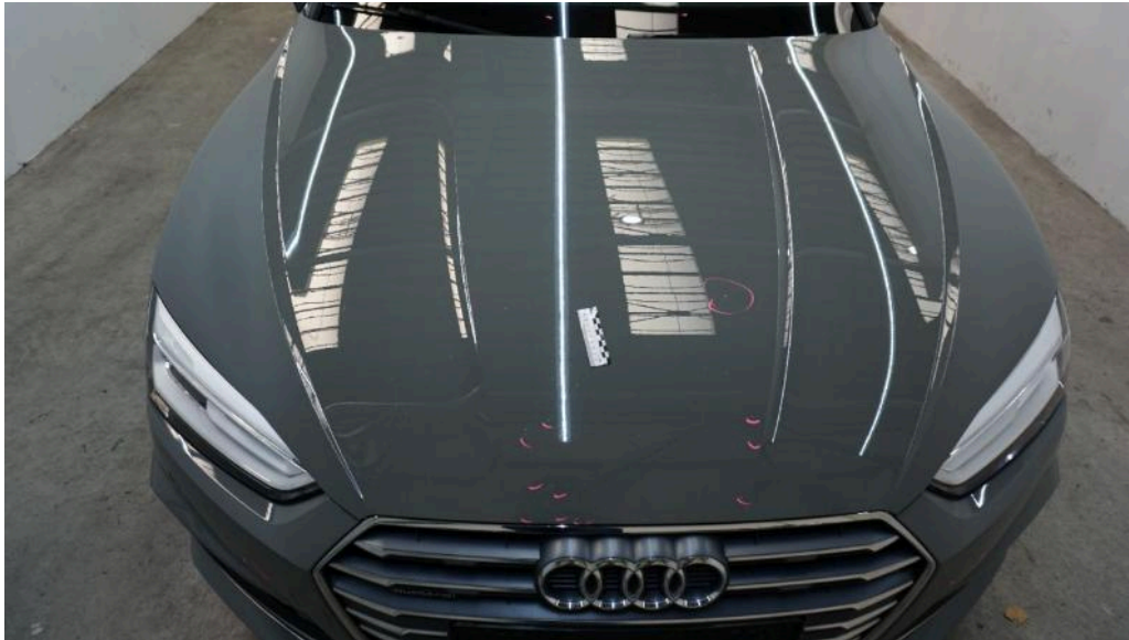
Bild 17 Fahrzeugfront Motorhaube Steinschlag / -schläge
