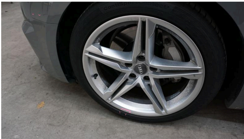
Bild 33 Vorderachse Felge links (vorne) verschürt, Vorderachse Reifen links (vorne) eingeschnitten
