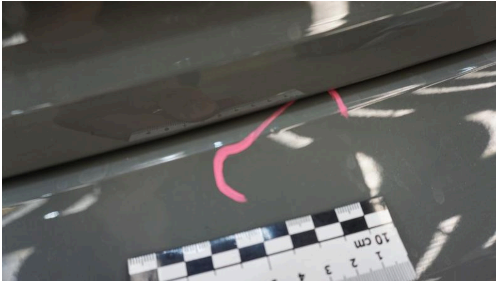
Bild 49 Fahrzeugheck Stoßfänger (hinten) Die Stoßstange ist leicht verformt und im kannten Bereich mit starkem Materialabtrag. Diffusor lackieren angestoßen
