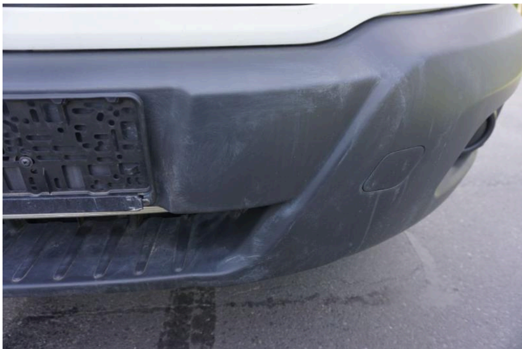
Bild 19 Fahrzeugfront Stoßfänger (vorne) verkratzt
