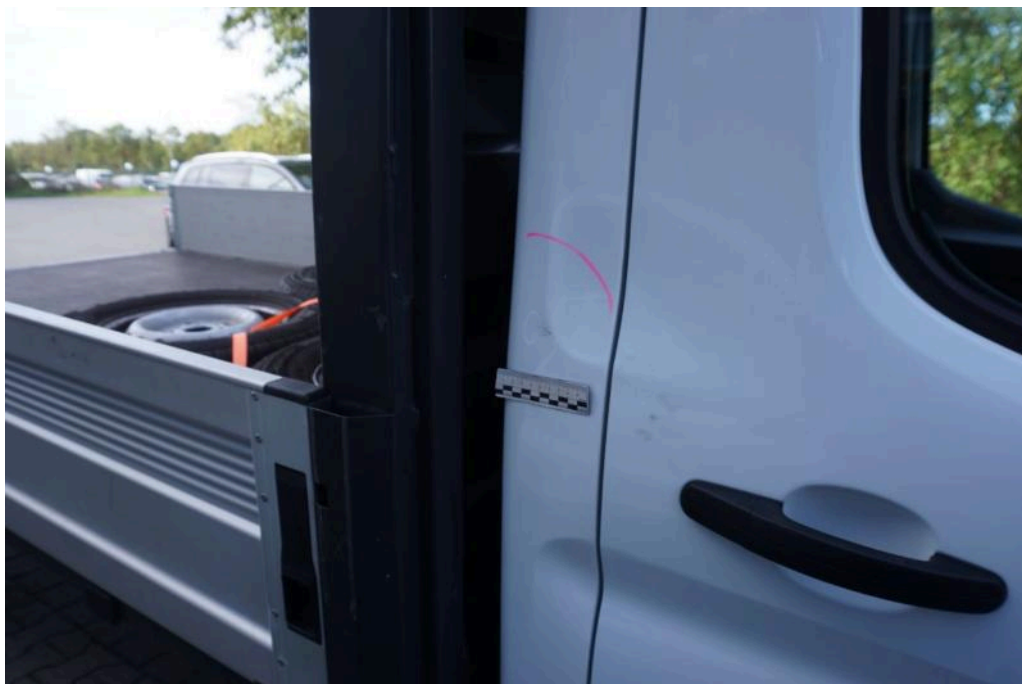
Bild 17 rechte Seite B-Säule Delle
