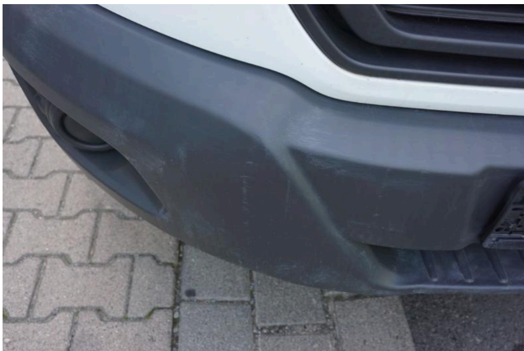
Bild 20 Fahrzeugfront Stoßfänger (vorne) verkratzt
