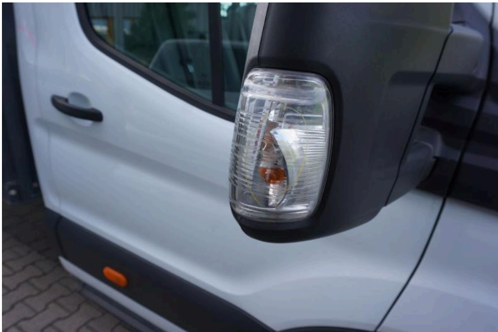
Bild 22 rechte Seite Blinkerglas Aussenspiegel verkratzt
