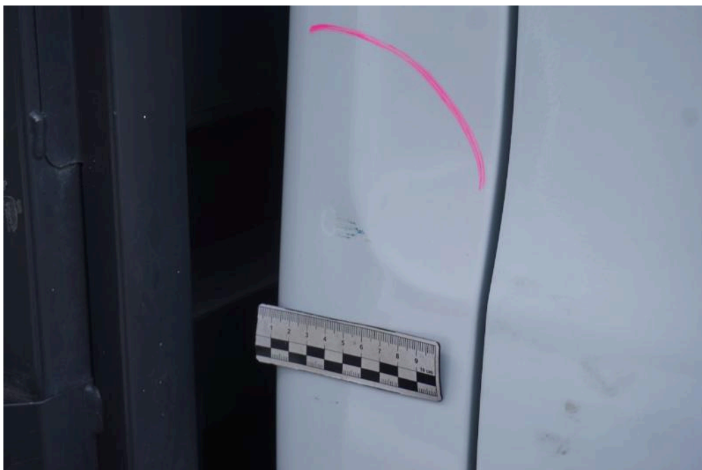
Bild 18 rechte Seite B-Säule Delle
