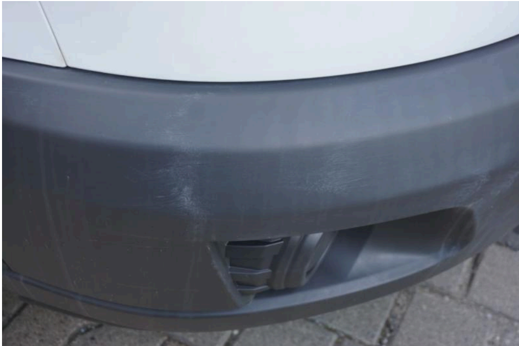
Bild 21 Fahrzeugfront Stoßfänger (vorne) verkratzt
