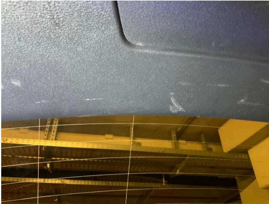
Bild 45 Innenraum Heckklappe (Innenverkleidung) verschürt
