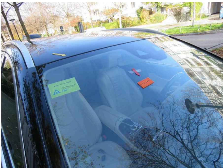
Bild 40 Fahrzeugfront Frontscheibe gerissen / eingerissen
