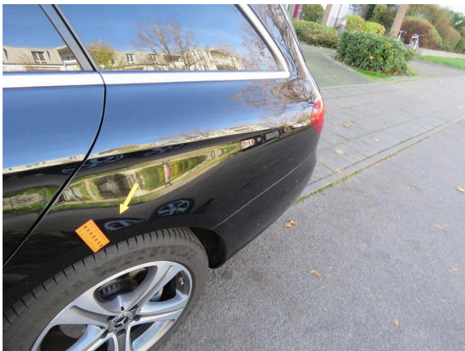
Bild 32 linke Seite Seitenteil links (hinten) Kratzer
