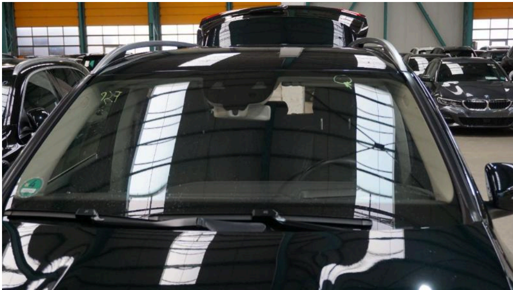
Bild 20 Fahrzeugfront Frontscheibe Steinschlag
