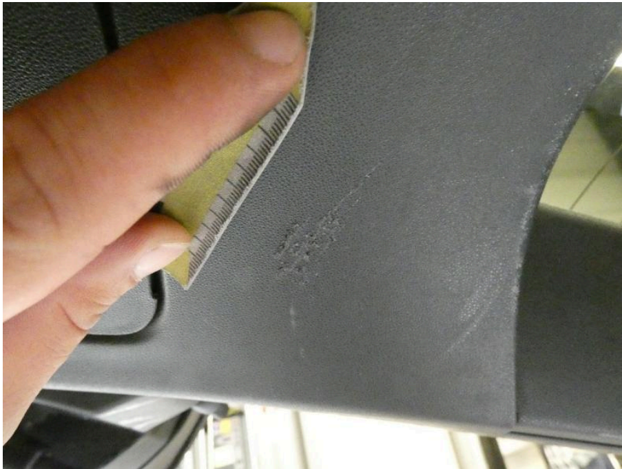
Bild 22 Innenraum Heckklappe (Innenverkleidung) verkratzt
