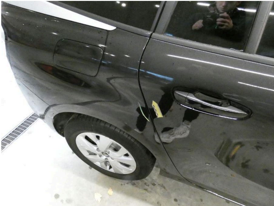
Bild 46 rechte Seite Seitenwand (rechts) verkratzt
