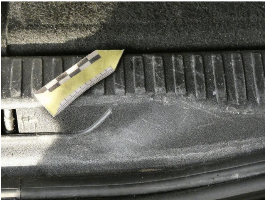
Bild 24 Innenraum Kofferraum Ladekante verkratzt
