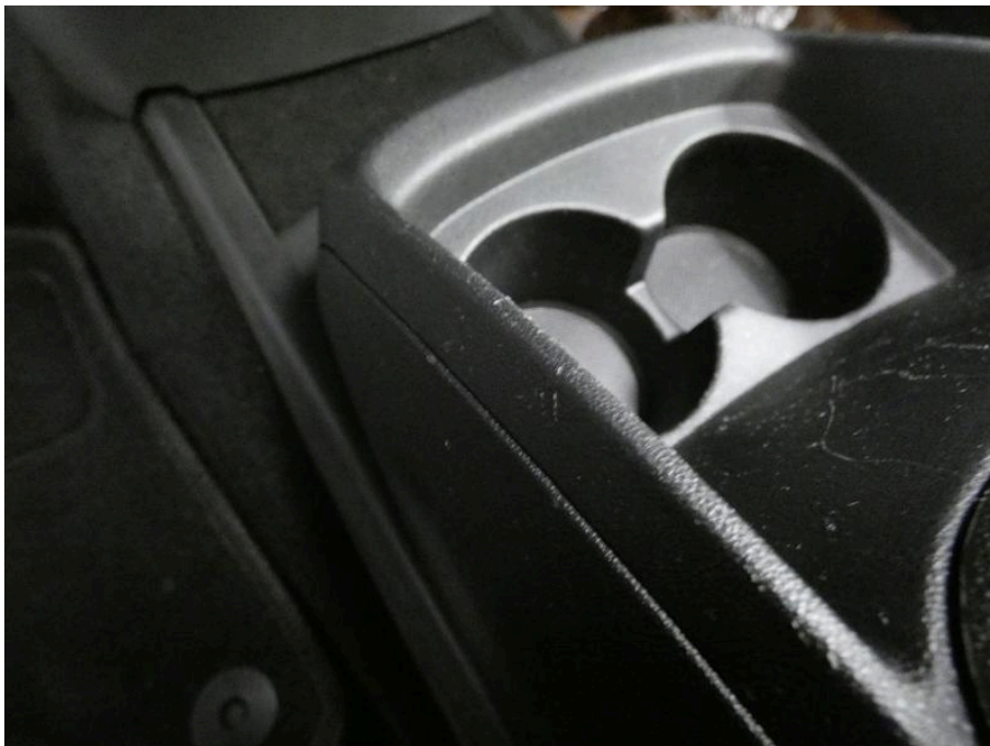
Bild 20 Innenraum Mittelkonsole (vorne) verkratzt
