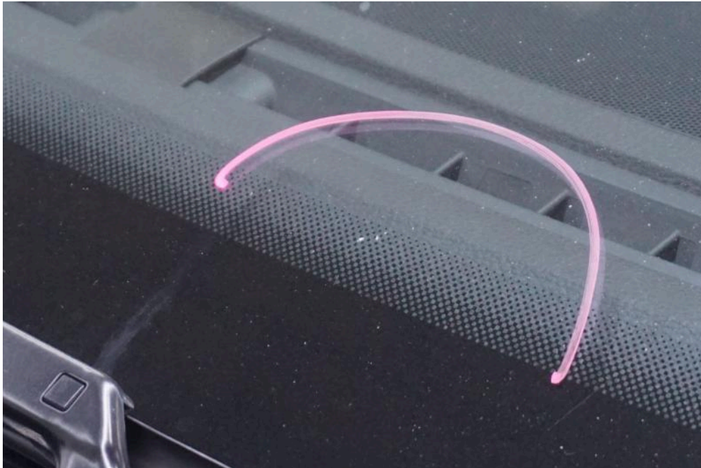
Bild 21 Fahrzeugfront Frontscheibe Steinschlag / -schläge
