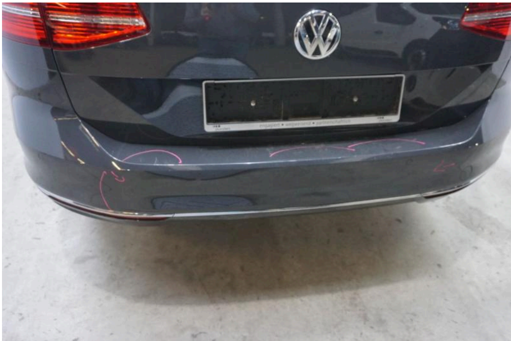
Bild 22 Fahrzeugheck Stoßfänger (hinten) eingedrückt verformt
