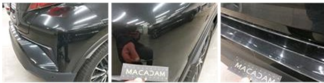
Door panel RR, Scratch(es), Replace
