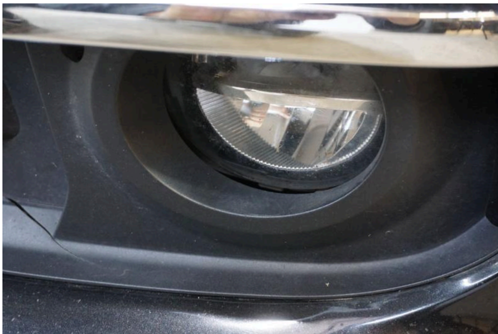
Bild 21 Fahrzeugfront Stoßfänger (vorne) verform - Blende Nebelscheinwerfer links gerissen
