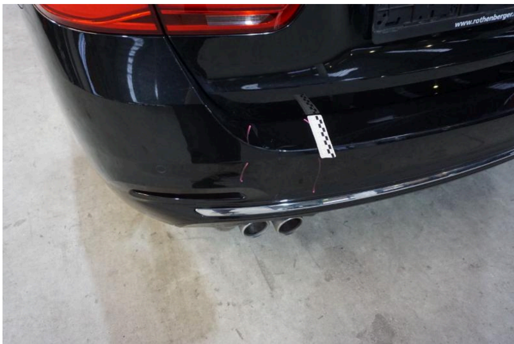
Bild 24 Fahrzeugheck Stoßfänger (hinten) gestaucht
