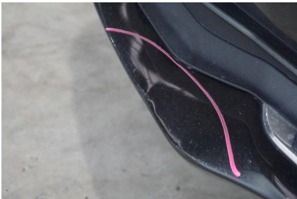
Bild 20 Fahrzeugfront Stoßfänger (vorne) verform - Blende Nebelscheinwerfer links gerissen
