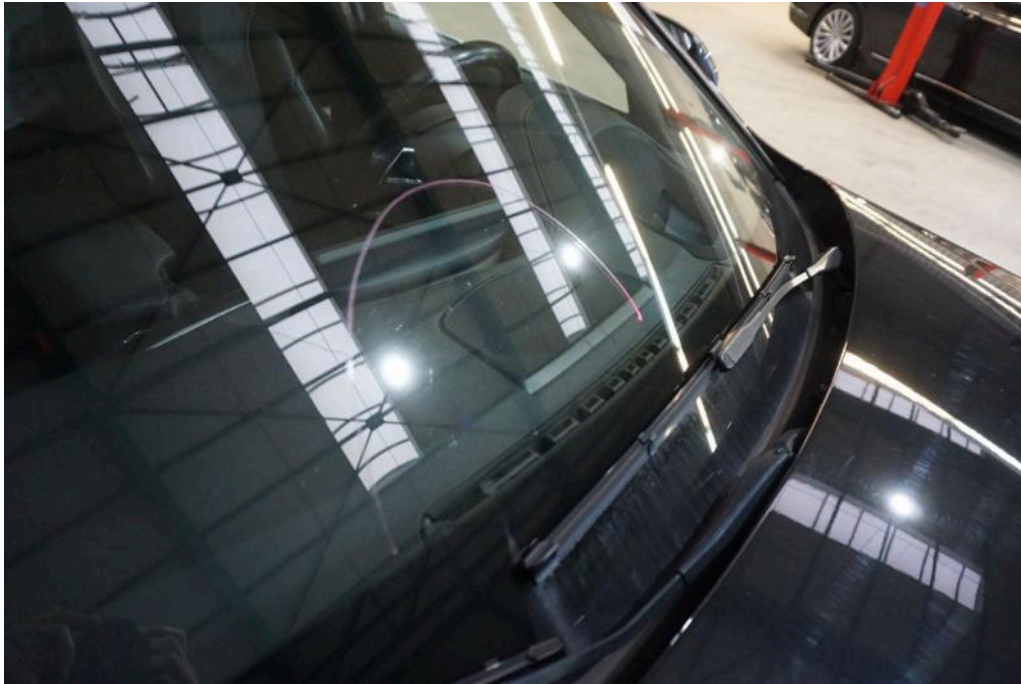
Bild 27 Fahrzeugfront Frontscheibe Steinschlag
