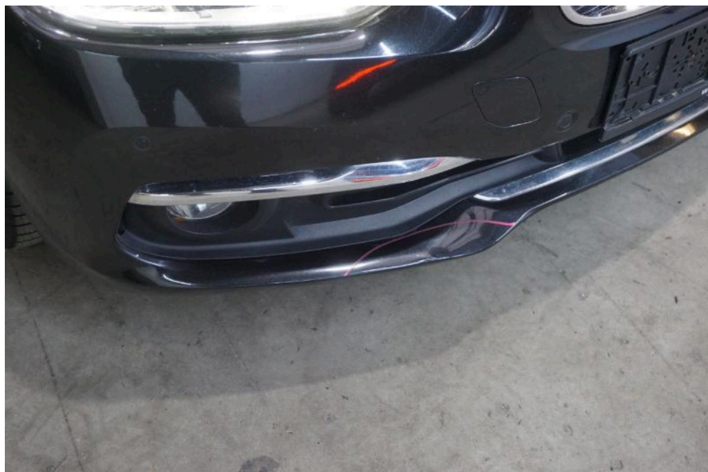
Bild 18 Fahrzeugfront Stoßfänger (vorne) verform - Blende Nebelscheinwerfer links gerissen
