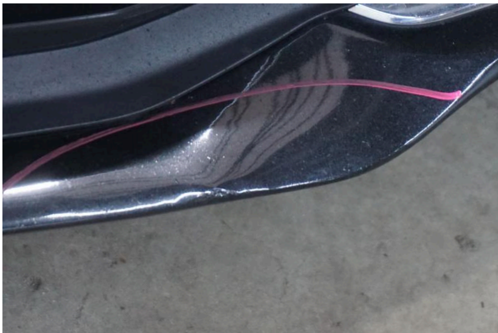
Bild 19 Fahrzeugfront Stoßfänger (vorne) verform - Blende Nebelscheinwerfer links gerissen
