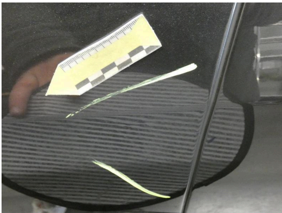
Bild 28 linke Seite Kotflügel links Lackmängel (Läufer und Staubeinschlüsse) unsachgemäße Reparatur
