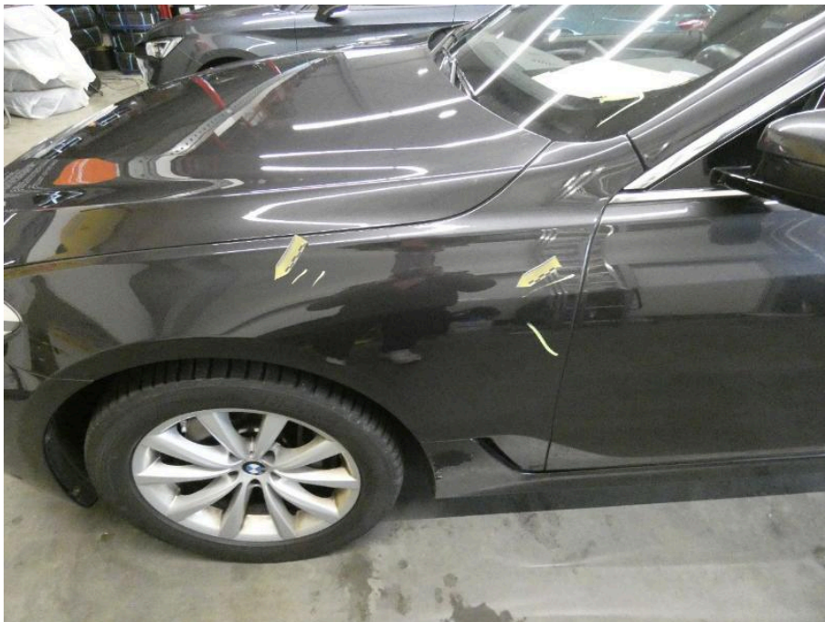
Bild 26 linke Seite Kotflügel links Lackmängel (Läufer und Staubeinschlüsse) unsachgemäße Reparatur
