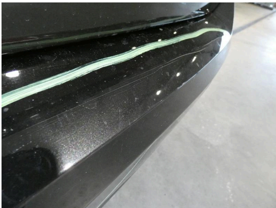
Bild 22 Fahrzeugheck Stoßfänger (hinten) verformt
