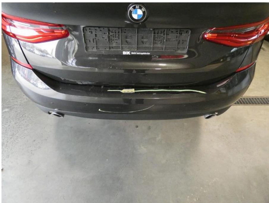
Bild 20 Fahrzeugheck Stoßfänger (hinten) verformt
