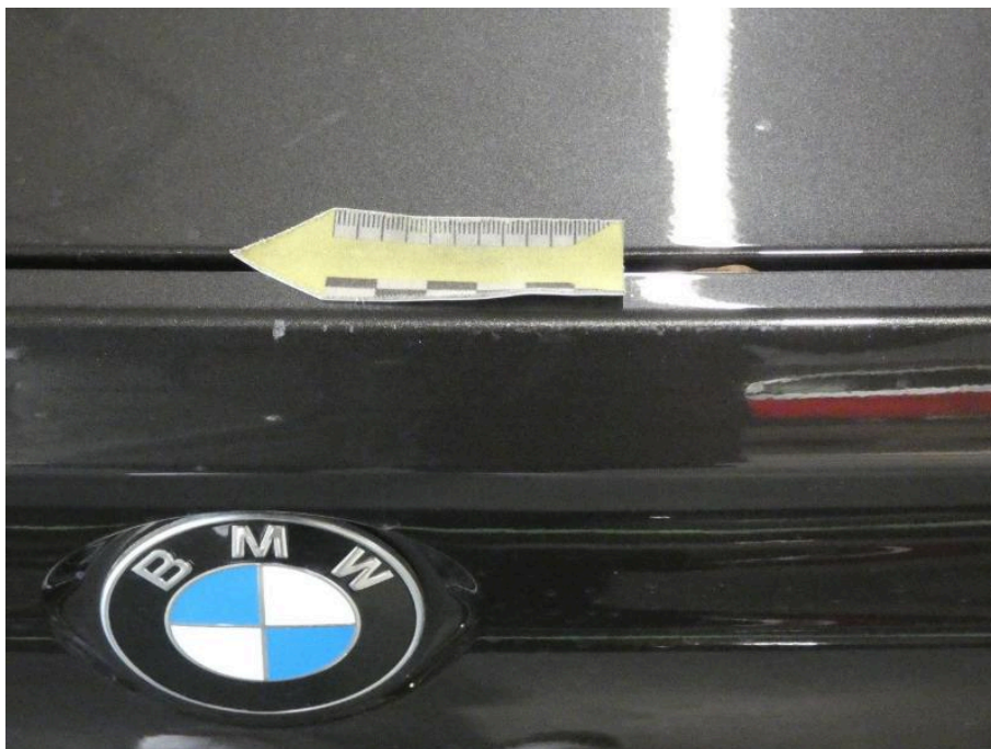
Bild 19 Fahrzeugheck Kofferdeckel / Heckklappe verkratzt
