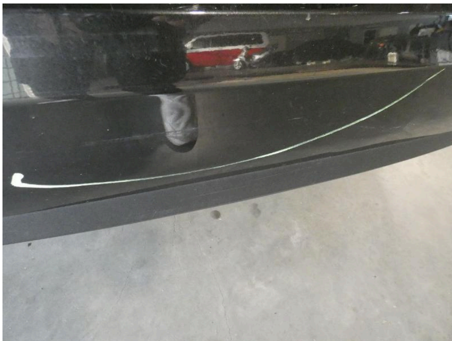
Bild 23 Fahrzeugheck Stoßfänger (hinten) verformt
