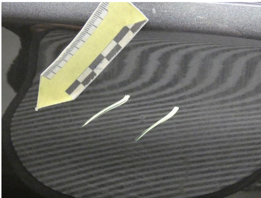
Bild 27 linke Seite Kotflügel links Lackmängel (Läufer und Staubeinschlüsse) unsachgemäße Reparatur
