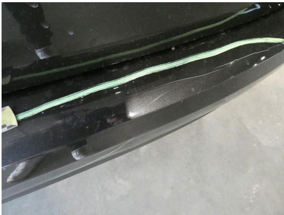
Bild 21 Fahrzeugheck Stoßfänger (hinten) verformt
