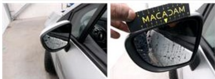
Door RR, Scratch(es), Acceptable
