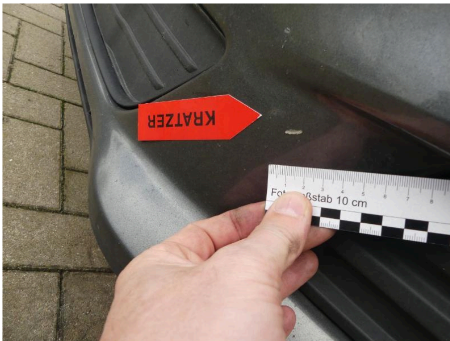
Bild 29 Fahrzeugfront Stoßfänger vorne Kratzer
