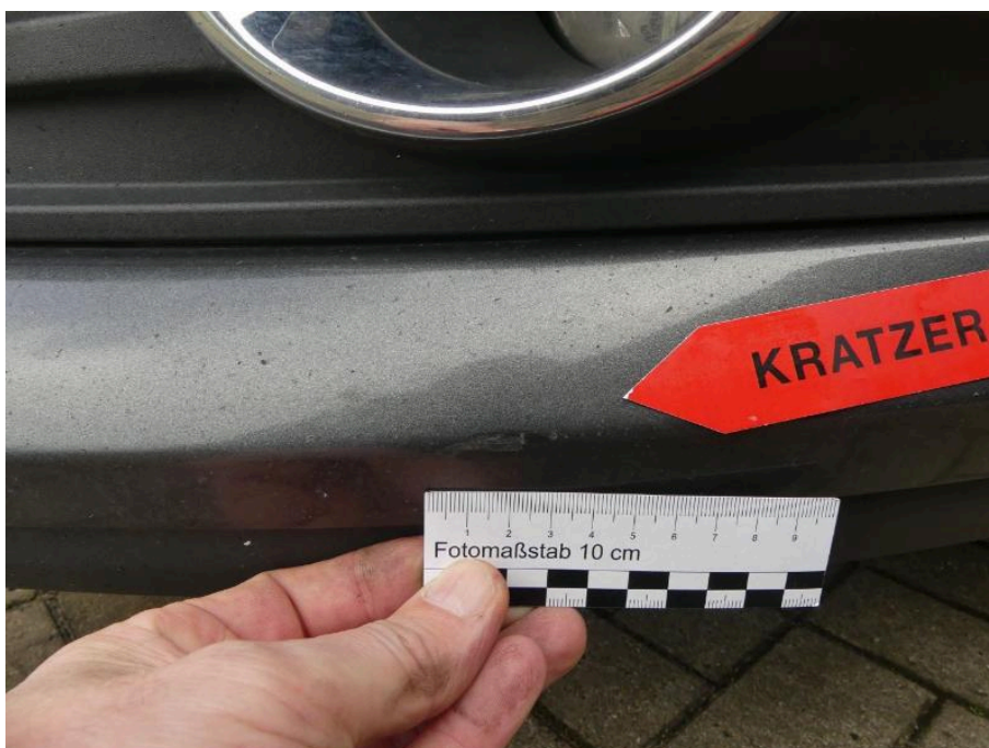
Bild 30 Fahrzeugfront Stoßfänger vorne Kratzer
