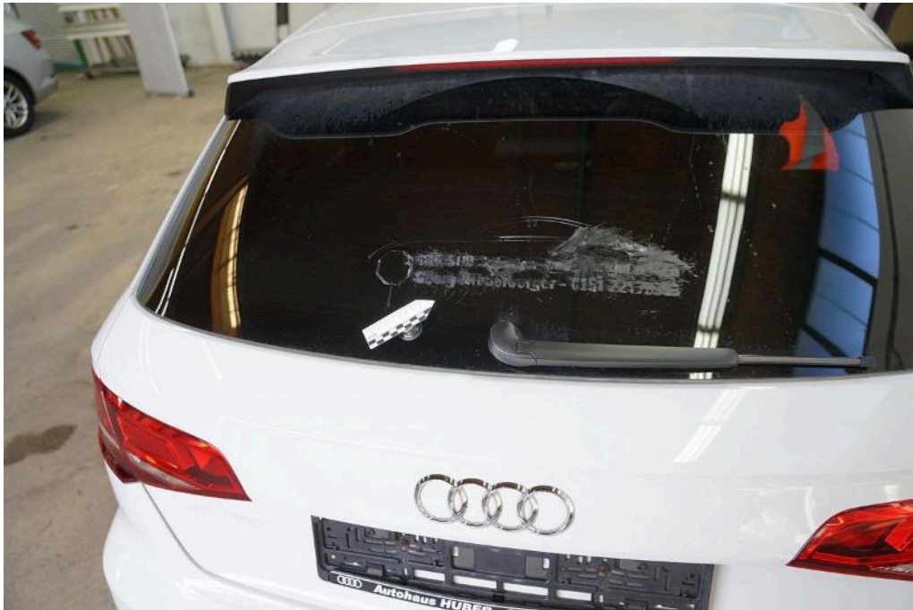
Bild 20 Fahrzeugheck Heckscheibe verkratzt
