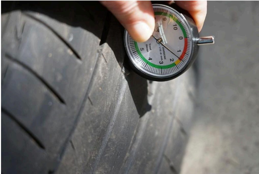
Bild 19 Fahrzeugzubehör 2. Reifensatz Sommerreifen Verschleißgrenze erreicht
