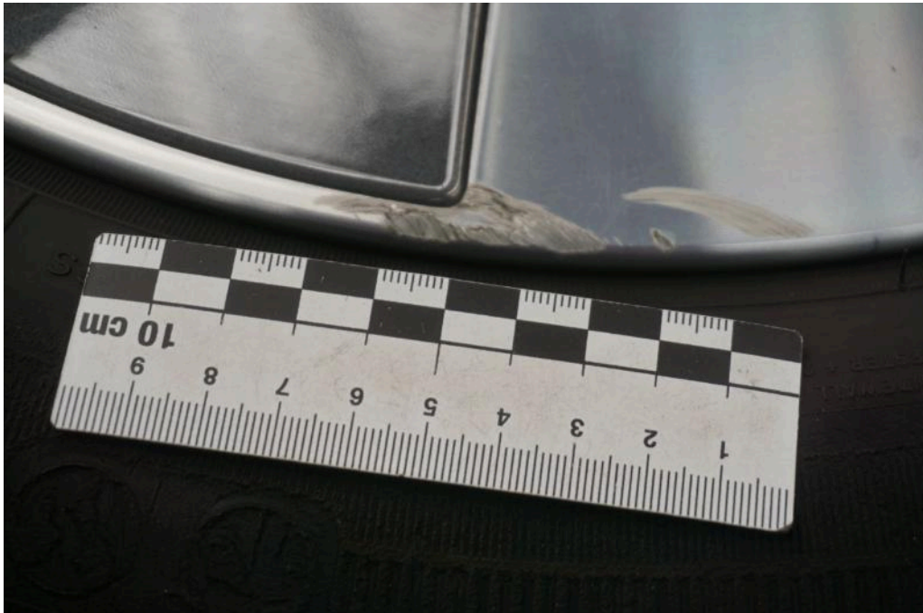
Bild 24 Fahrzeug Sommerreifen im FZ Felge 1. Stück Materialabtrag
