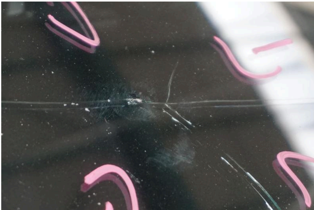
Bild 28 Fahrzeugfront Windschutzscheibe gerissen / eingerissen
