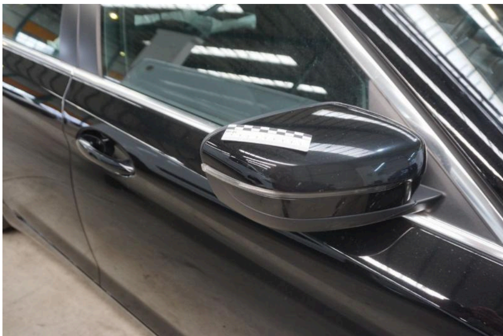
Bild 32 rechte Seite Außenspiegel rechts verkratzt
