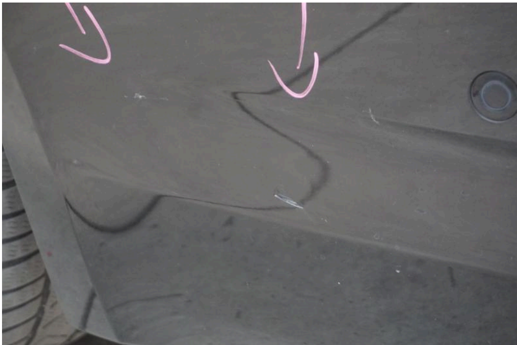
Bild 26 Fahrzeugheck Stoßfänger hinten zerkratzt
