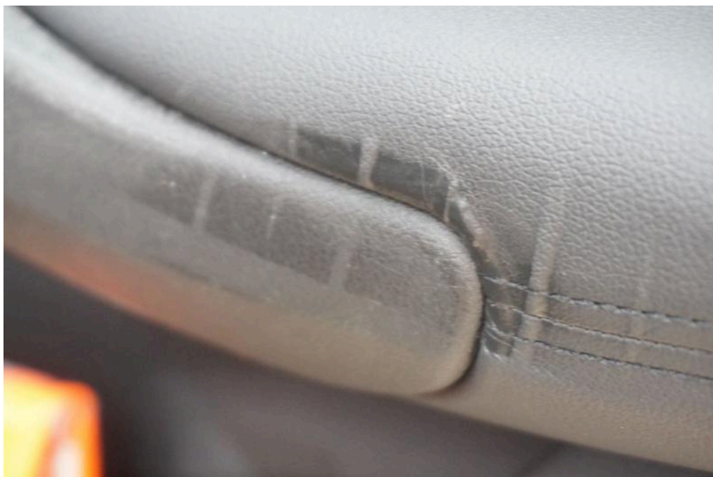
Bild 18 Innenraum Türinnenverkleidung hinten rechts Armlehne rechts und links hinten Druckstelle durch Reifen
