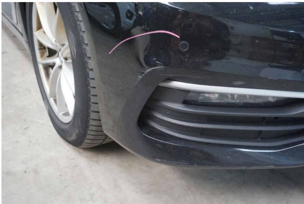
Bild 35 Fahrzeugfront Stoßfänger vorne verkratzt
