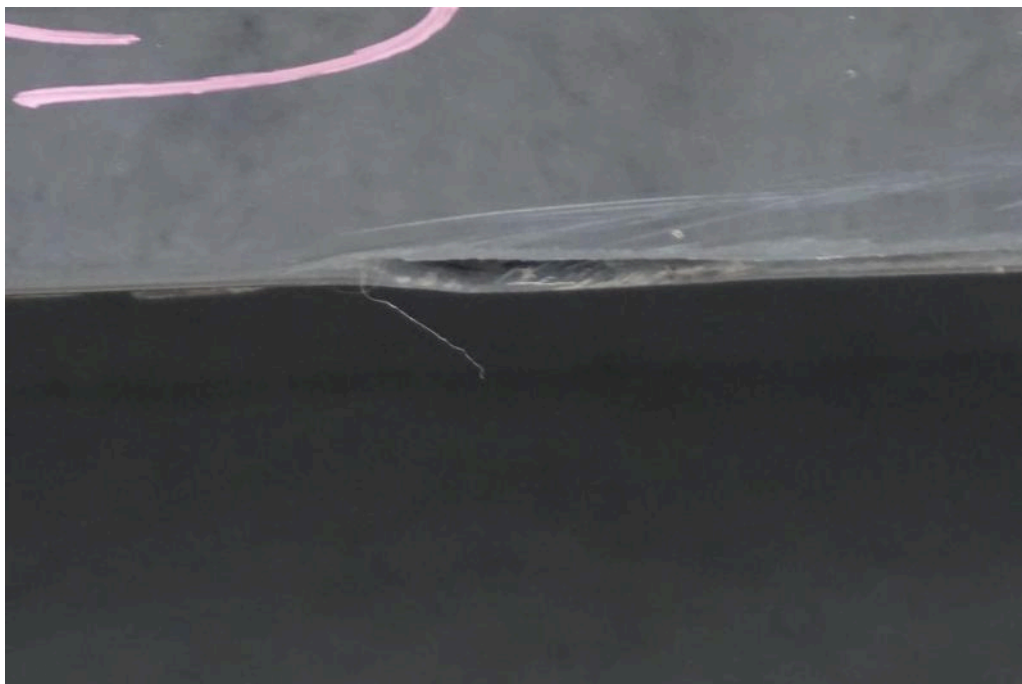
Bild 31 rechte Seite Schwellerverkleidung rechts gerissen / eingerissen
