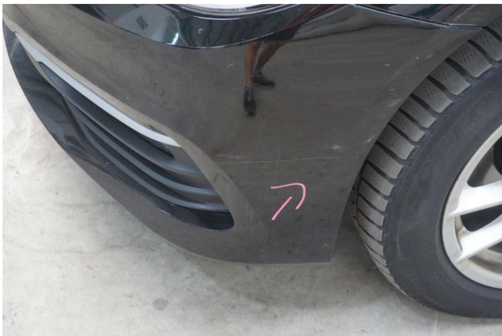
Bild 36 Fahrzeugfront Stoßfänger vorne verkratzt
