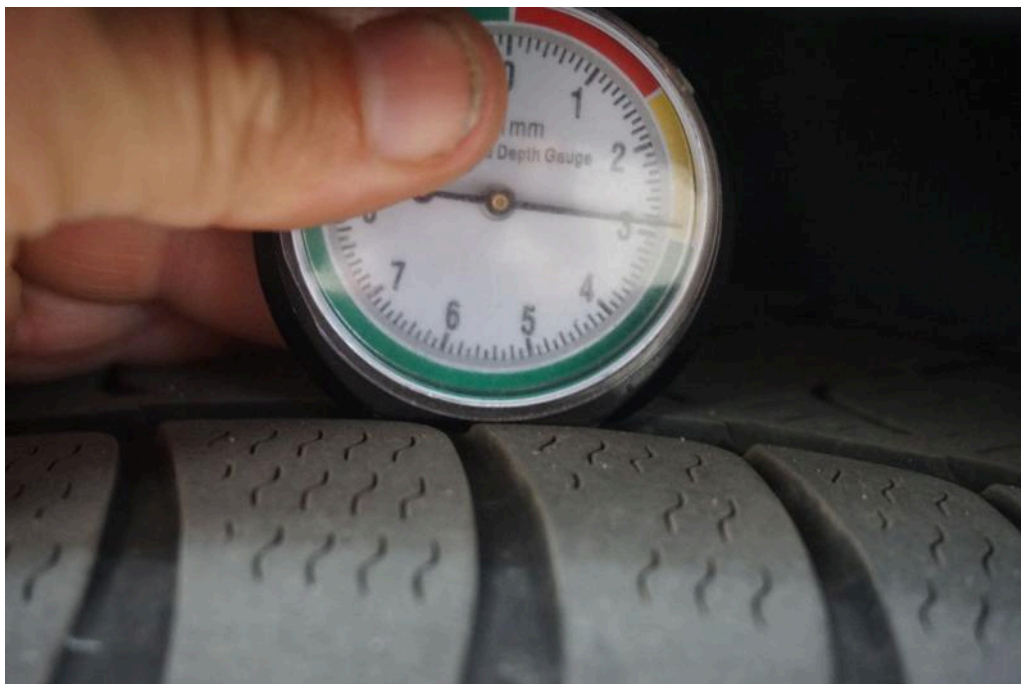
Bild 21 Hinterachse Reifen hinten rechts Reifen hinten links unter Mindestprofiltiefe
