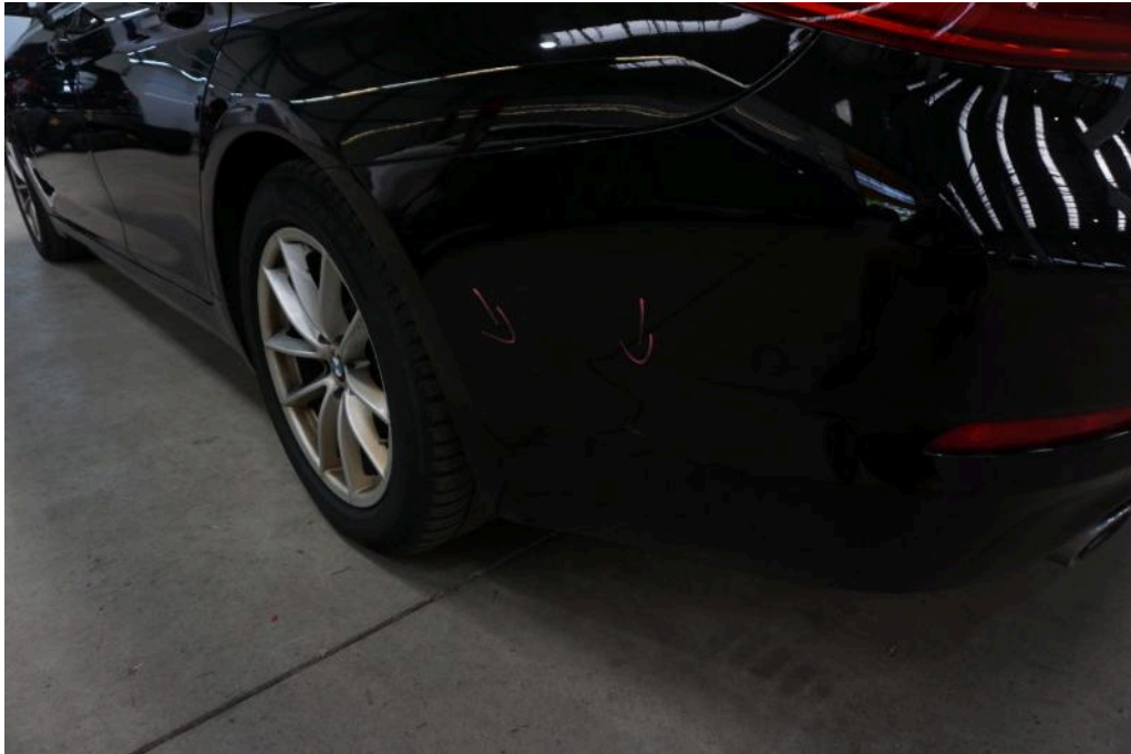
Bild 25 Fahrzeugheck Stoßfänger hinten zerkratzt
