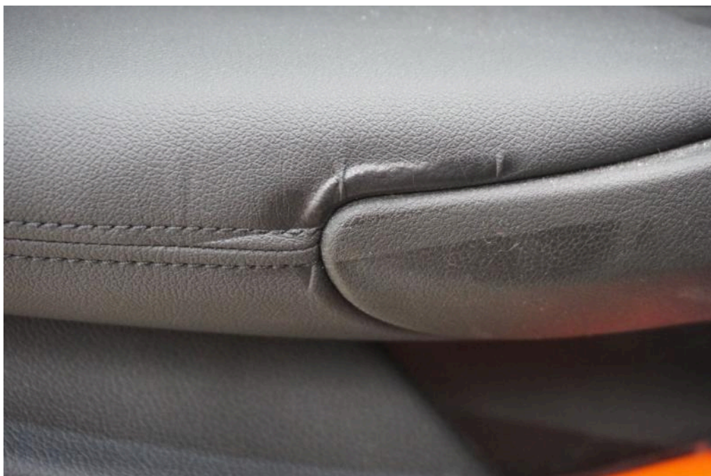
Bild 20 Innenraum Türinnenverkleidung hinten rechts Armlehne rechts und links hinten Druckstelle durch Reifen
