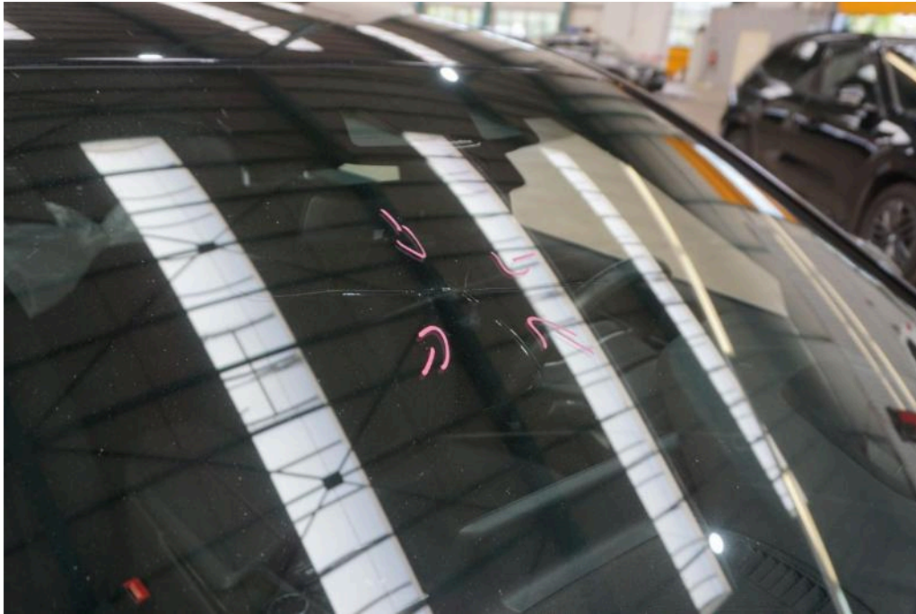
Bild 27 Fahrzeugfront Windschutzscheibe gerissen / eingerissen
