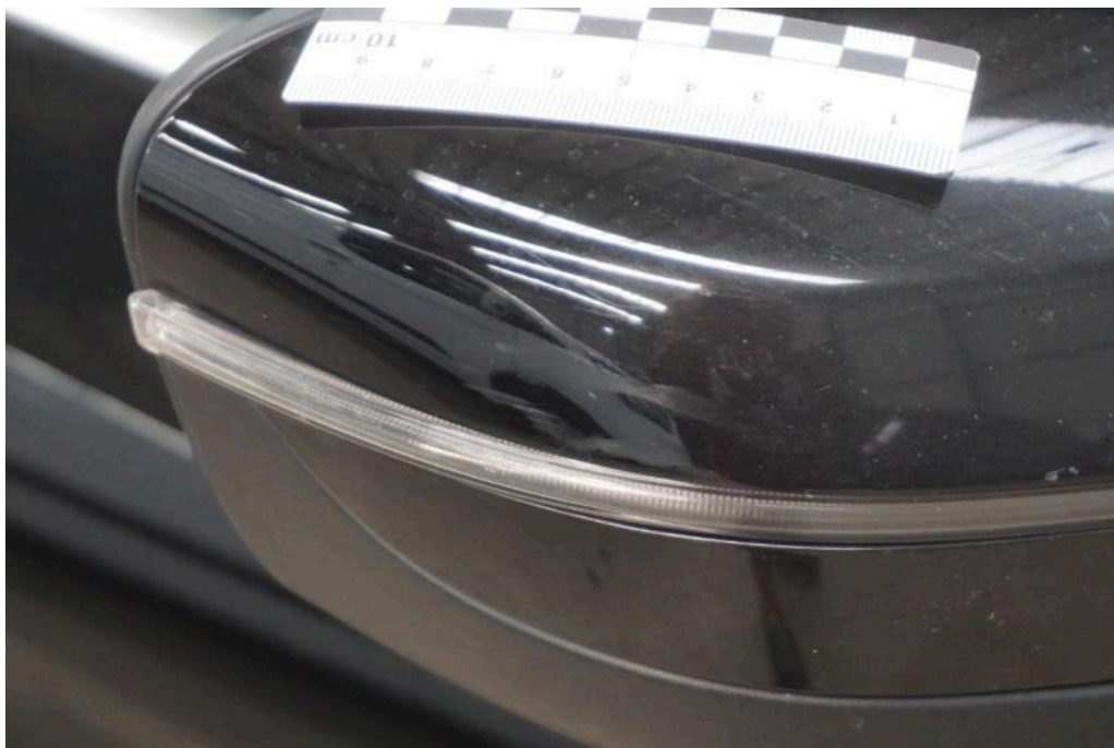
Bild 33 rechte Seite Außenspiegel rechts verkratzt
