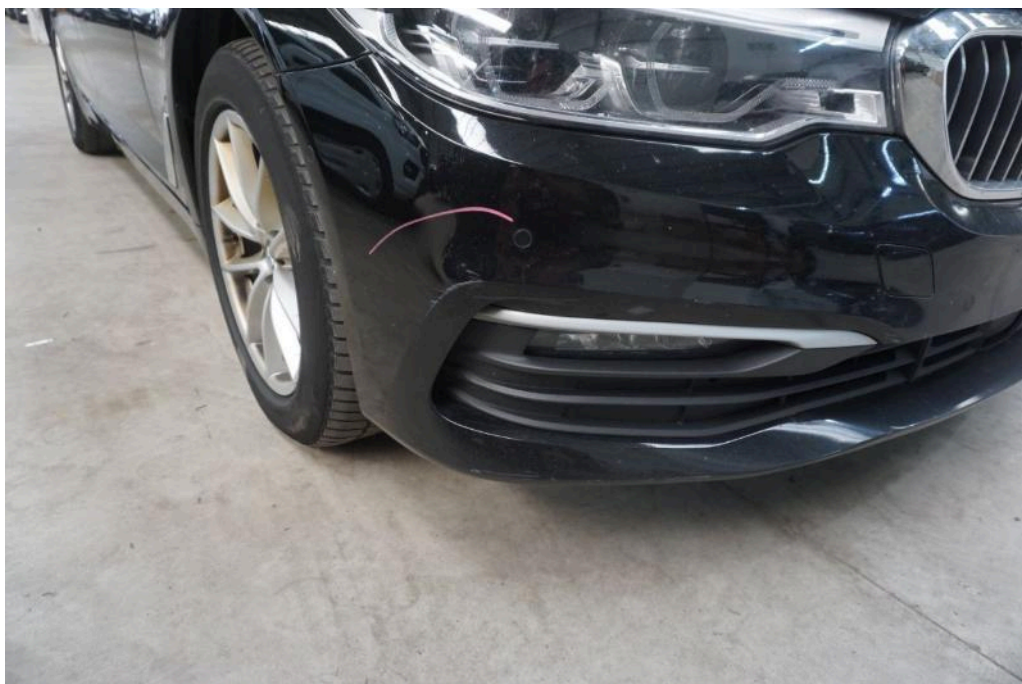
Bild 34 Fahrzeugfront Stoßfänger vorne verkratzt
