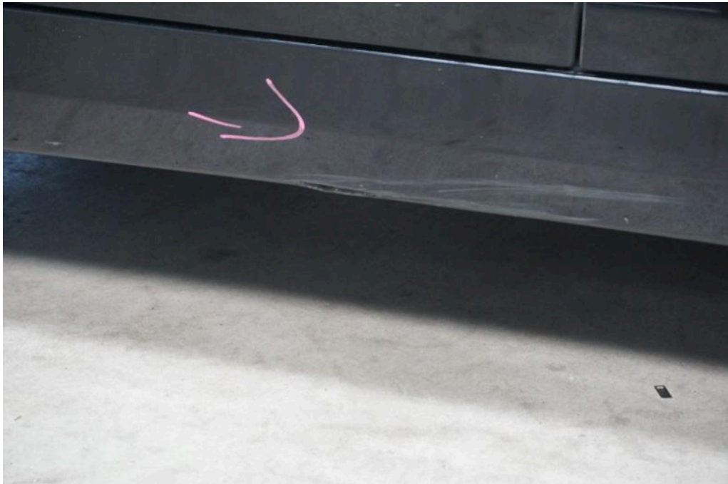
Bild 30 rechte Seite Schwellerverkleidung rechts gerissen / eingerissen
