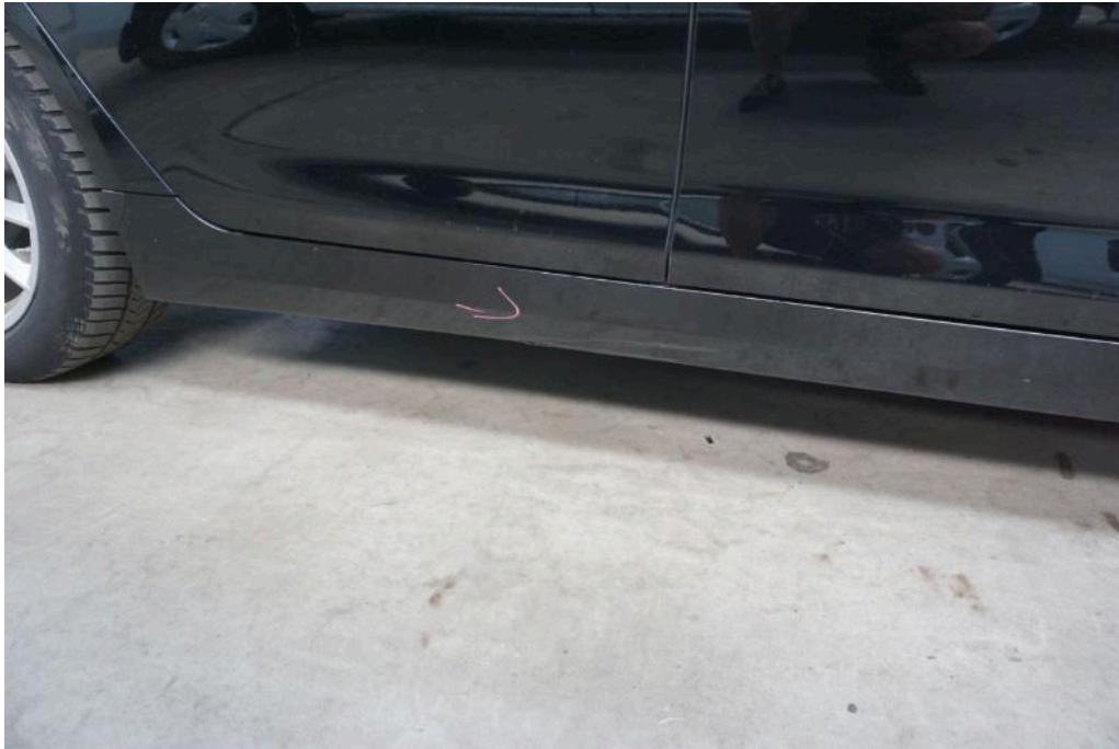
Bild 29 rechte Seite Schwellerverkleidung rechts gerissen / eingerissen
