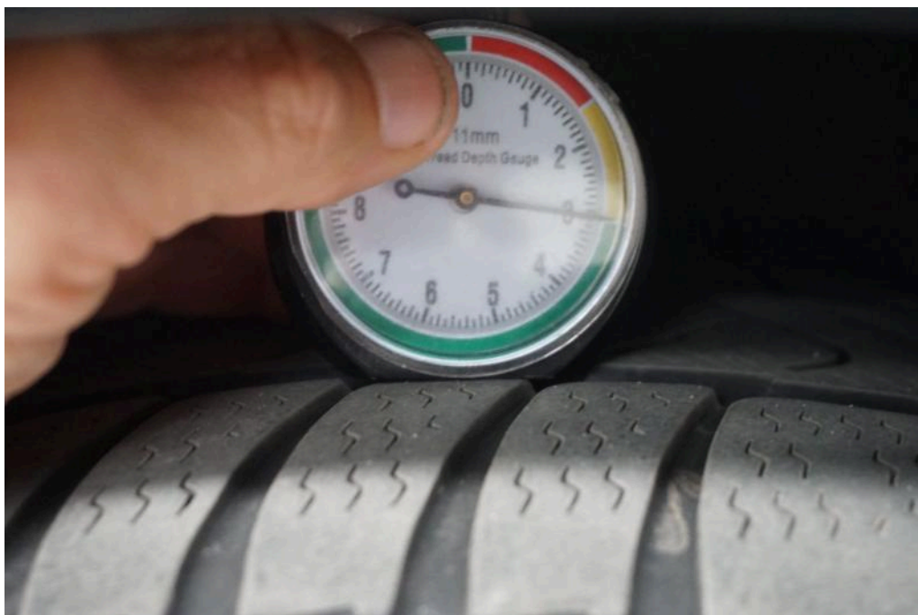
Bild 22 Hinterachse Reifen hinten rechts Reifen hinten links unter Mindestprofiltiefe
