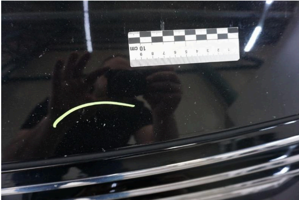
Bild 19 Fahrzeugfront Motorhaube Steinschlag / -schläge
