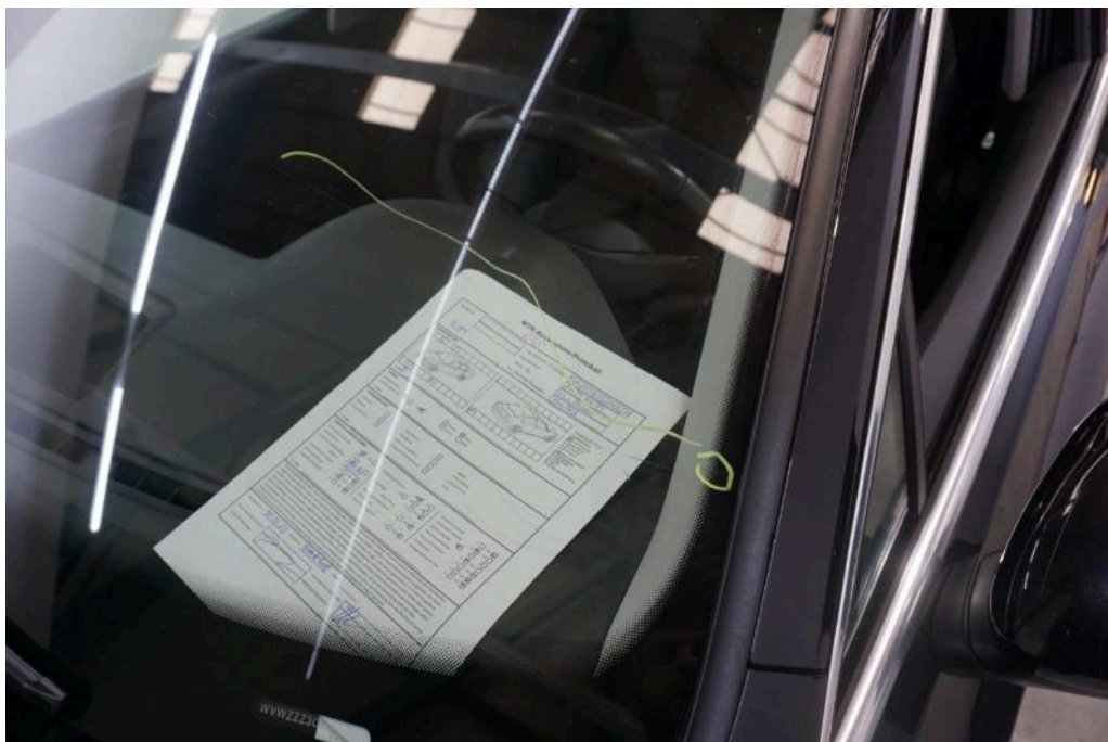
Bild 31 Fahrzeugfront Windschutzscheibe gerissen / eingerissen
