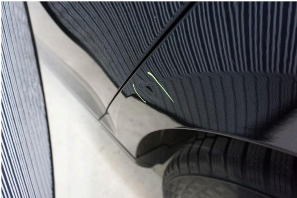
Bild 26 linke Seite Seitenwand hinten links Kratzer Delle
