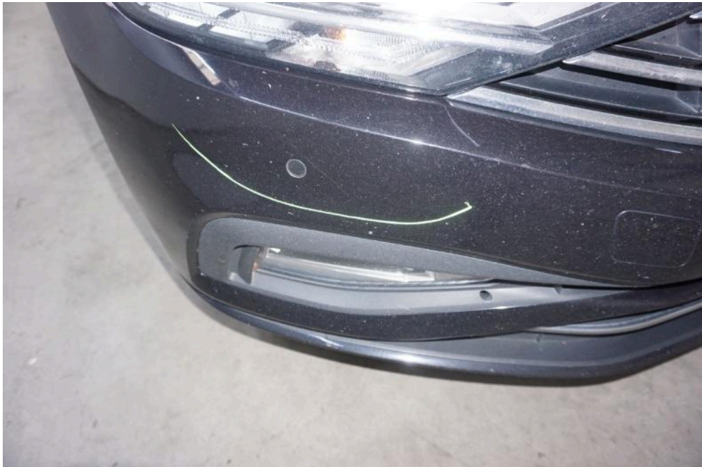
Bild 20 Fahrzeugfront Stoßfänger vorne Steinschlag / -schläge
