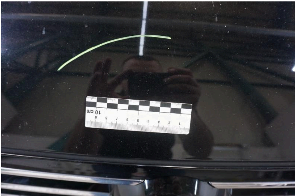
Bild 18 Fahrzeugfront Motorhaube Steinschlag / -schläge
