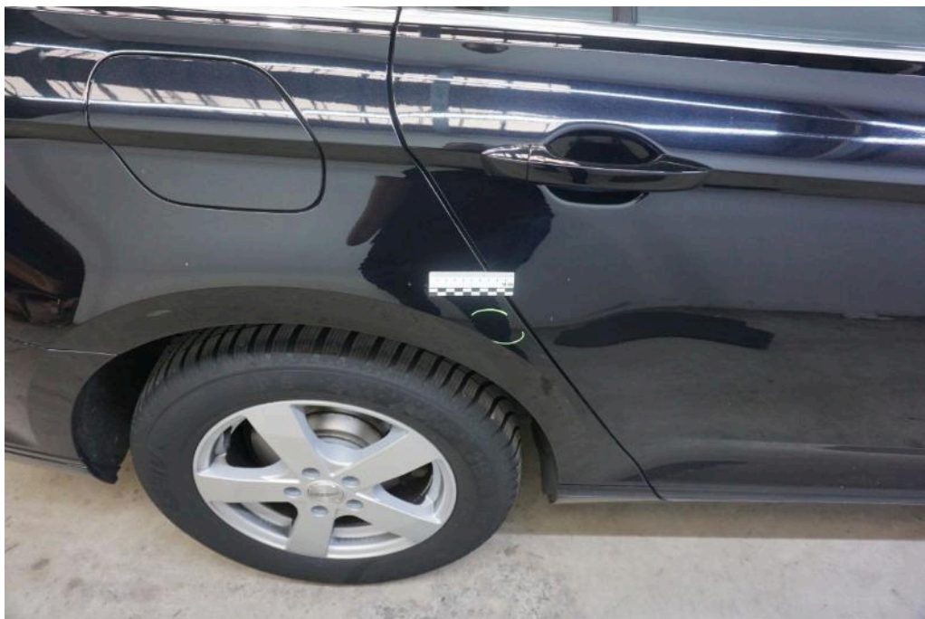
Bild 23 rechte Seite Seitenwand hinten rechts Delle
