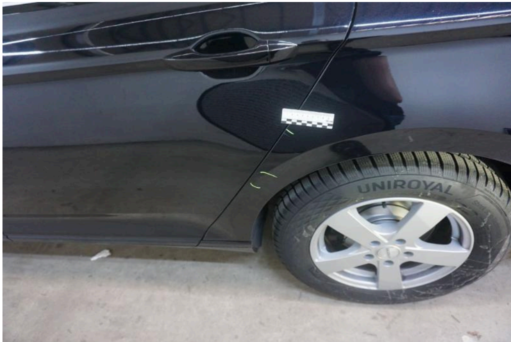
Bild 25 linke Seite Seitenwand hinten links Kratzer Delle
