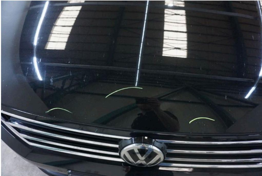
Bild 17 Fahrzeugfront Motorhaube Steinschlag / -schläge
