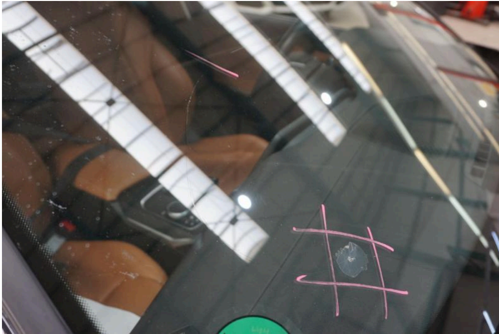
Bild 25 Fahrzeugfront Windschutzscheibe gerissen / eingerissen
