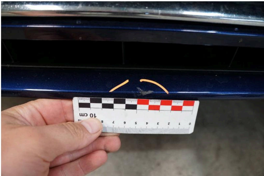
Bild 20 Fahrzeugfront Stoßfänger vorne Kratzer
