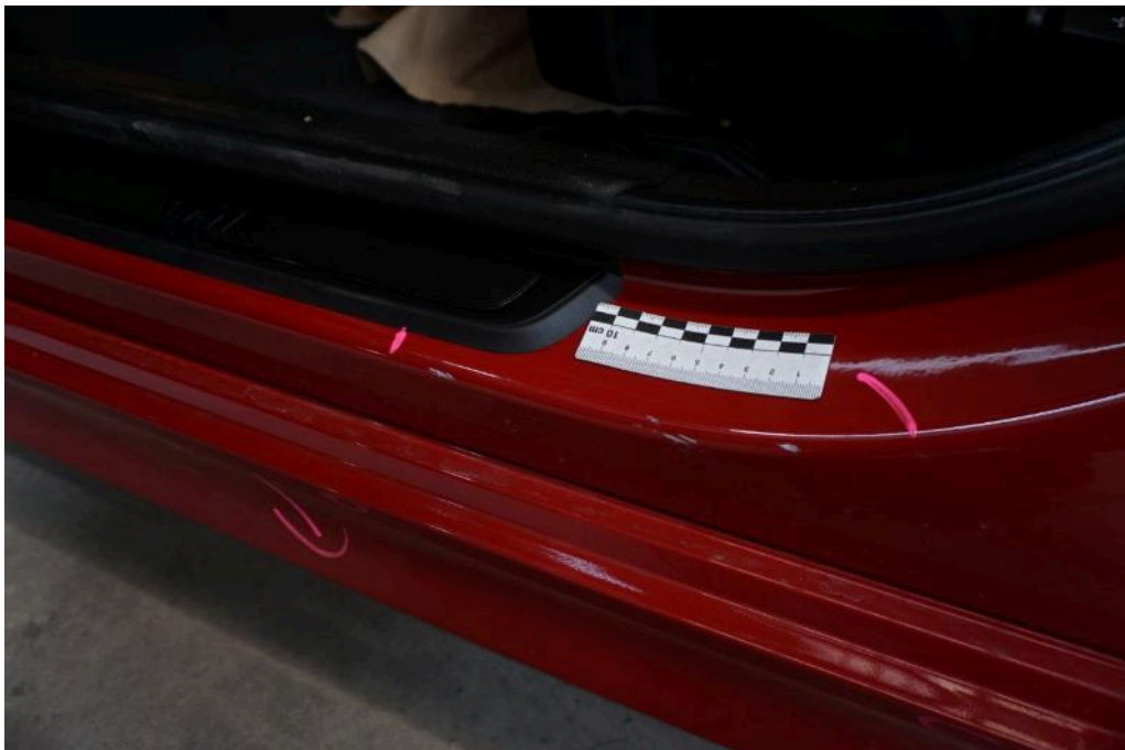
Bild 32 linke Seite B-Säule links Kratzer
