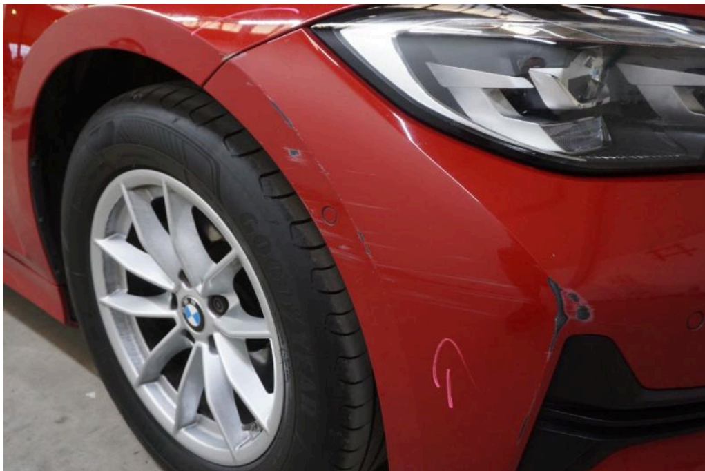
Bild 20 Fahrzeugfront Stoßfänger vorne Kotflügel vorne rechts zerkratzt, verschürft - Kostenerweiterung möglich verschürft
