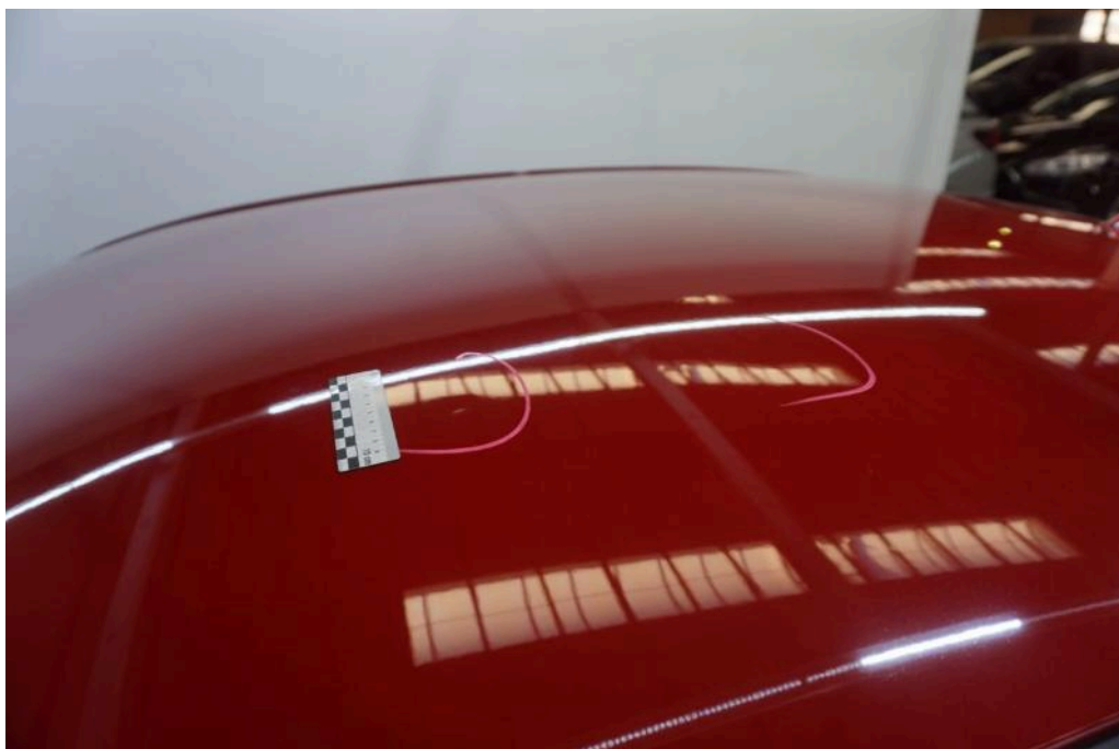
Bild 30 Dach Dachhaut Dellen
