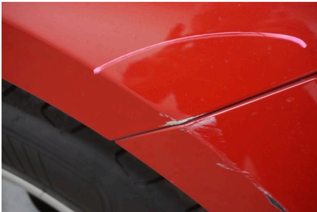
Bild 22 Fahrzeugfront Stoßfänger vorne Kotflügel vorne rechts zerkratzt, verschürft - Kostenerweiterung möglich verschürft
