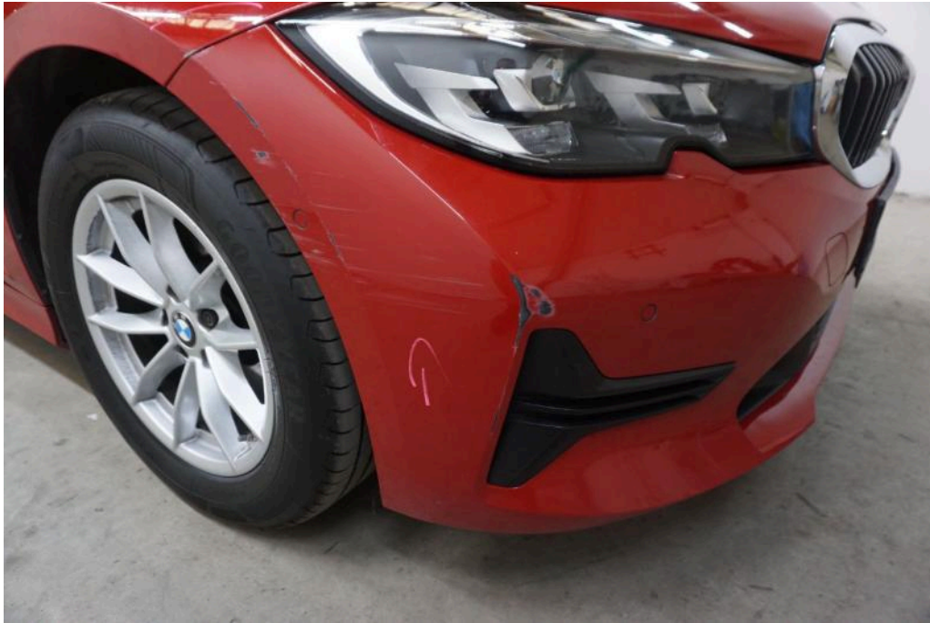
Bild 19 Fahrzeugfront Stoßfänger vorne Kotflügel vorne rechts zerkratzt, verschürft - Kostenerweiterung möglich verschürft
