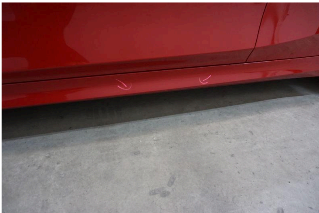
Bild 28 linke Seite Schwellerverkleidung links verschürft
