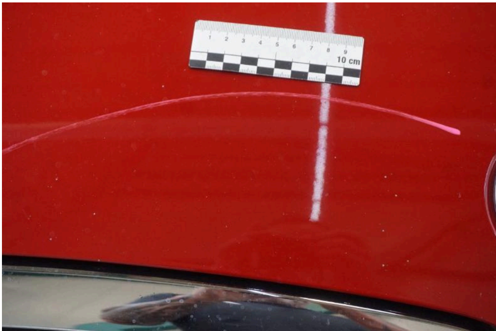
Bild 18 Fahrzeugfront Motorhaube Steinschlag / -schläge
