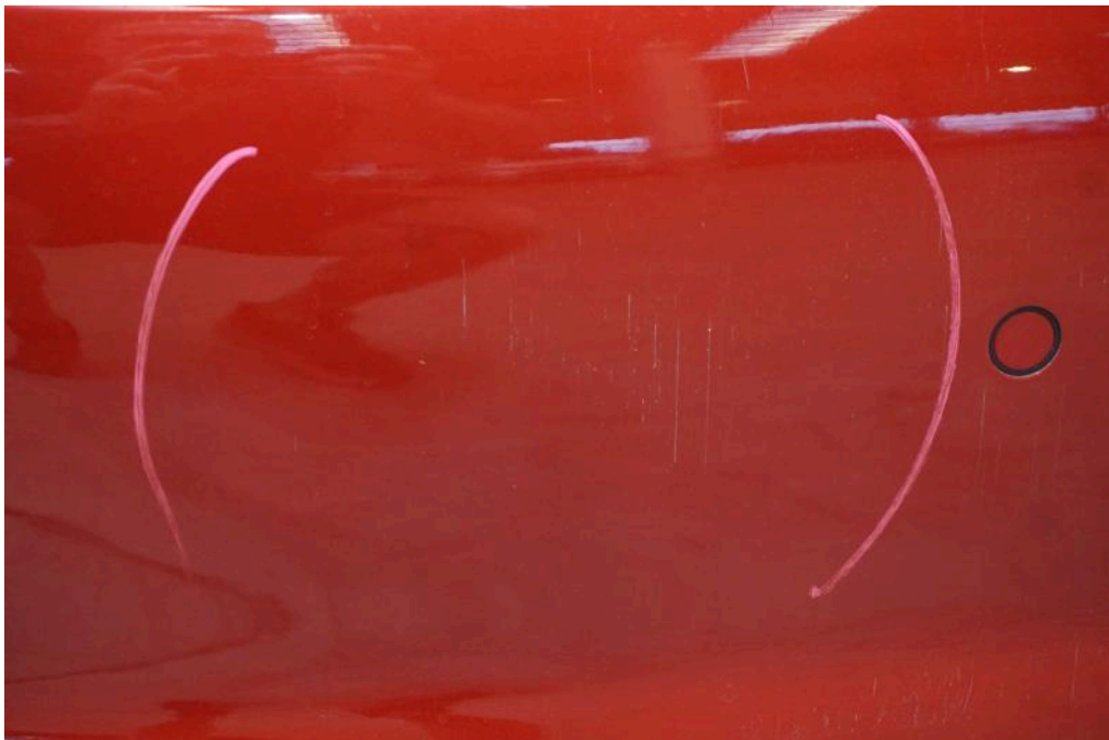
Bild 26 Fahrzeugheck Stoßfänger hinten verkratzt
