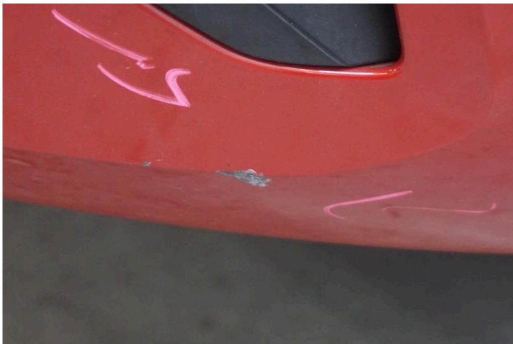
Bild 27 Fahrzeugheck Stoßfänger hinten verkratzt
