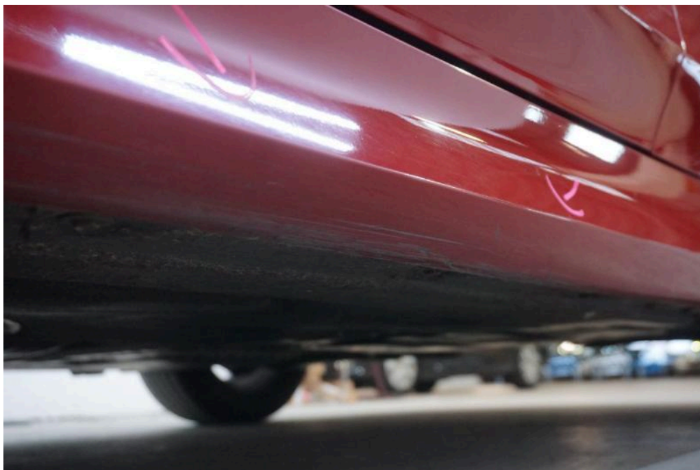
Bild 29 linke Seite Schwellerverkleidung links verschürft
