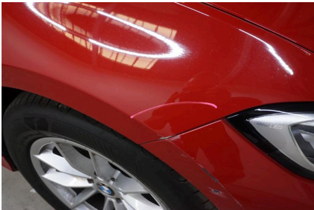
Bild 21 Fahrzeugfront Stoßfänger vorne Kotflügel vorne rechts zerkratzt, verschürft - Kostenerweiterung möglich verschürft
