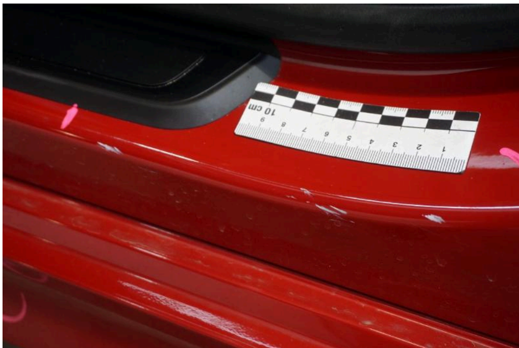
Bild 33 linke Seite B-Säule links Kratzer
