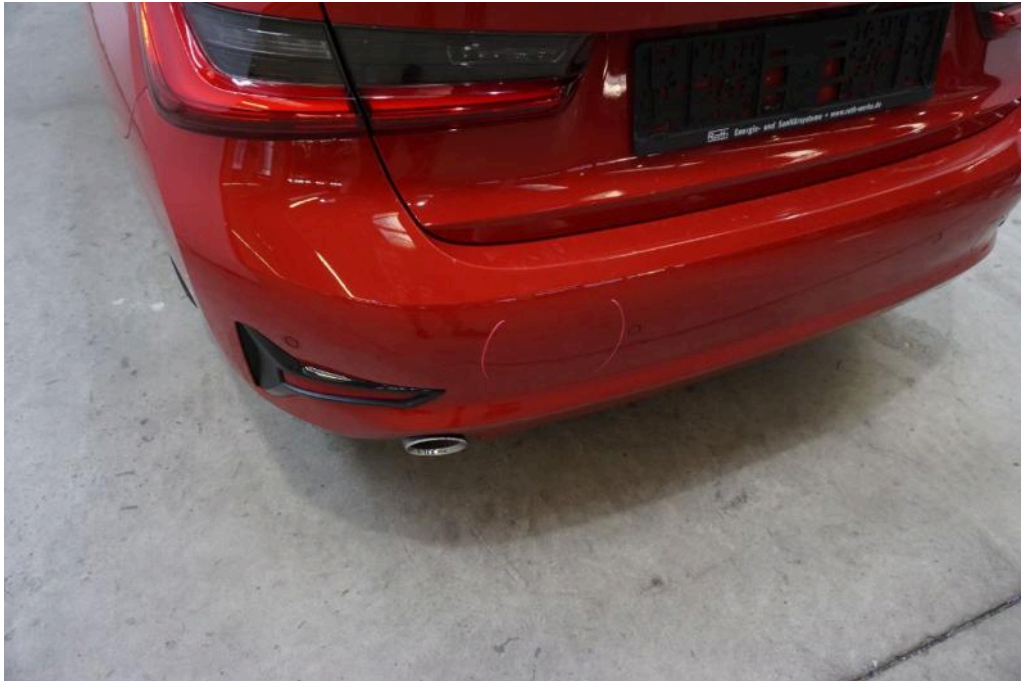
Bild 25 Fahrzeugheck Stoßfänger hinten verkratzt
