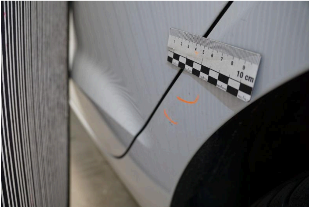
Bild 31 linke Seite Seitenwand hinten links Dellen
