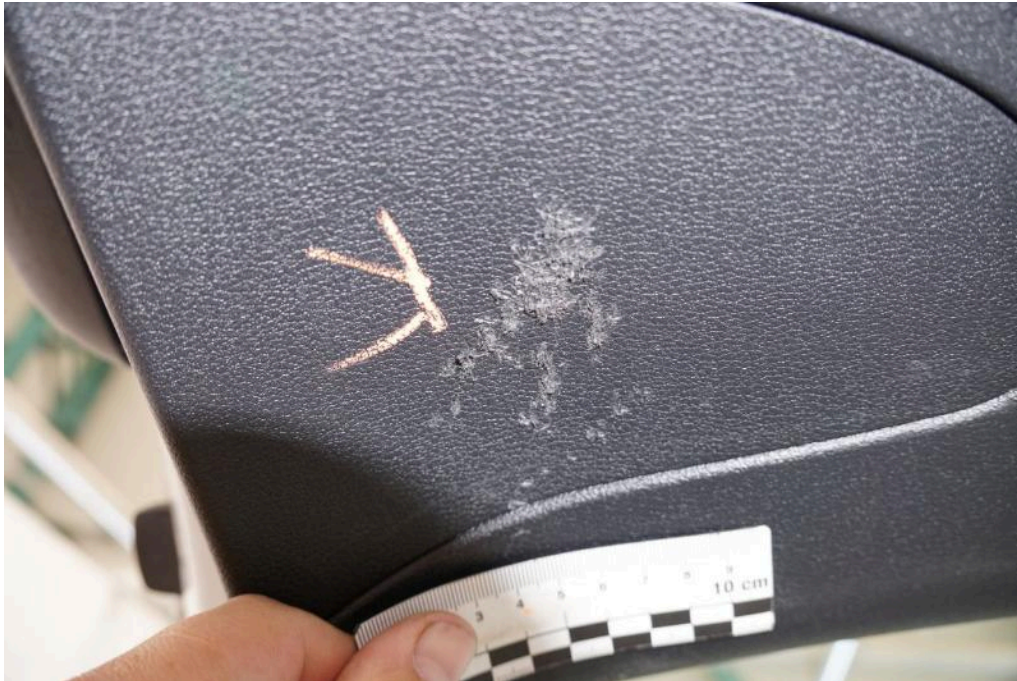
Bild 33 Innenraum Heckklappenverkleidung innen verkratzt
