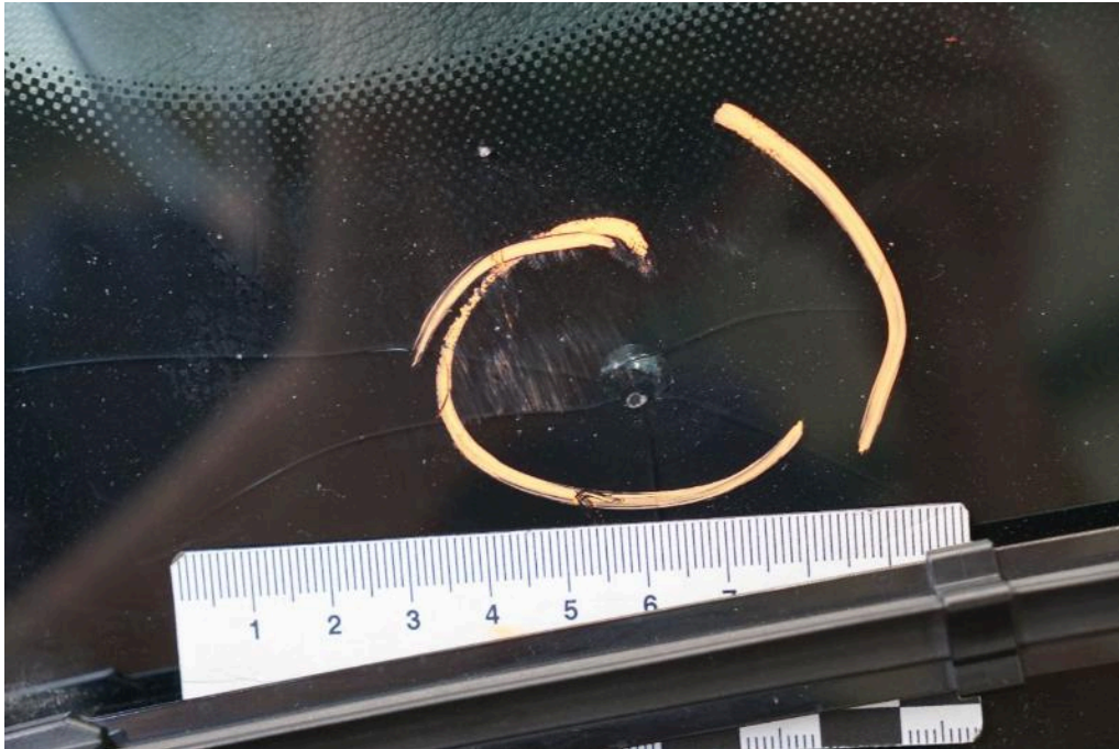
Bild 23 Fahrzeugfront Windschutzscheibe gerissen / eingerissen
