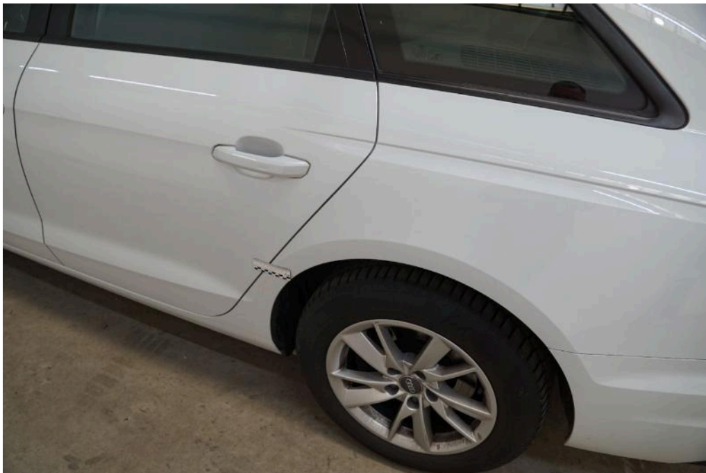
Bild 30 linke Seite Seitenwand hinten links Dellen
