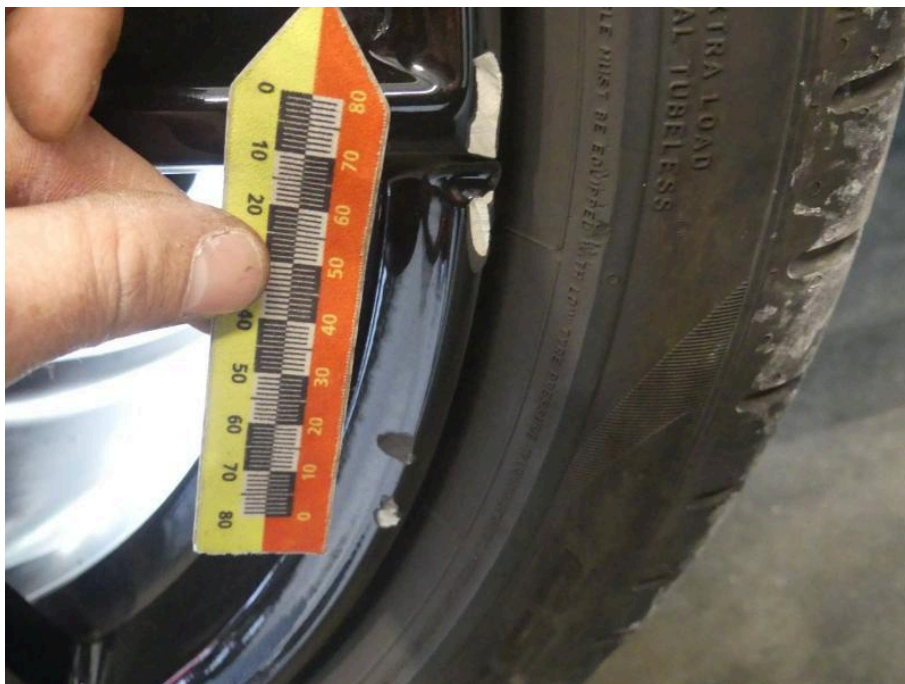
Bild 19 Hinterachse Alufelge hinten rechts Materialabtrag
