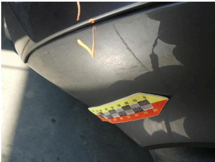
Bild 29 Fahrzeugheck Stoßfänger hinten verkratzt
