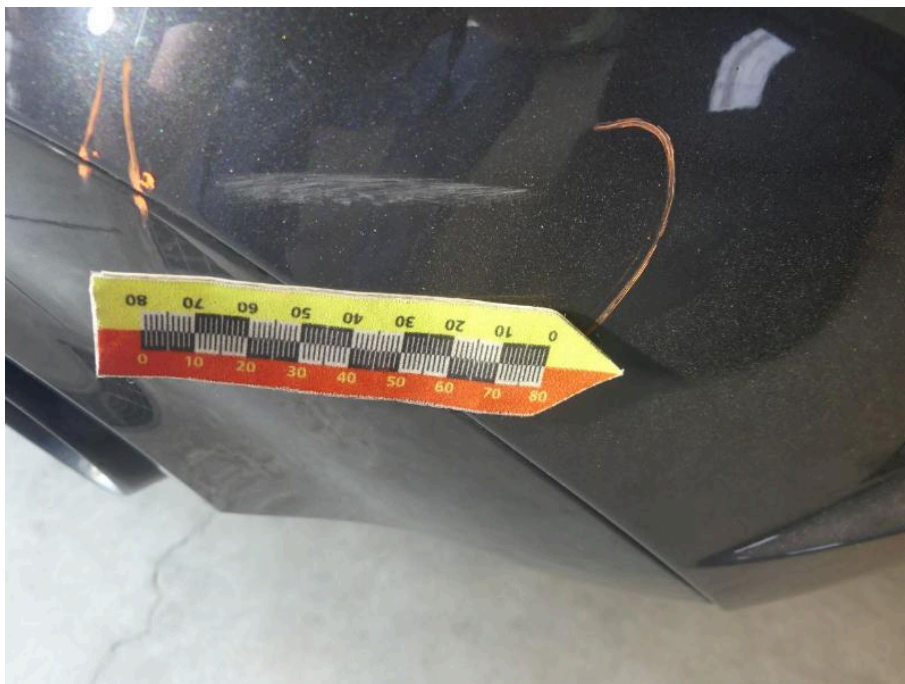
Bild 27 Fahrzeugheck Stoßfänger hinten verkratzt
