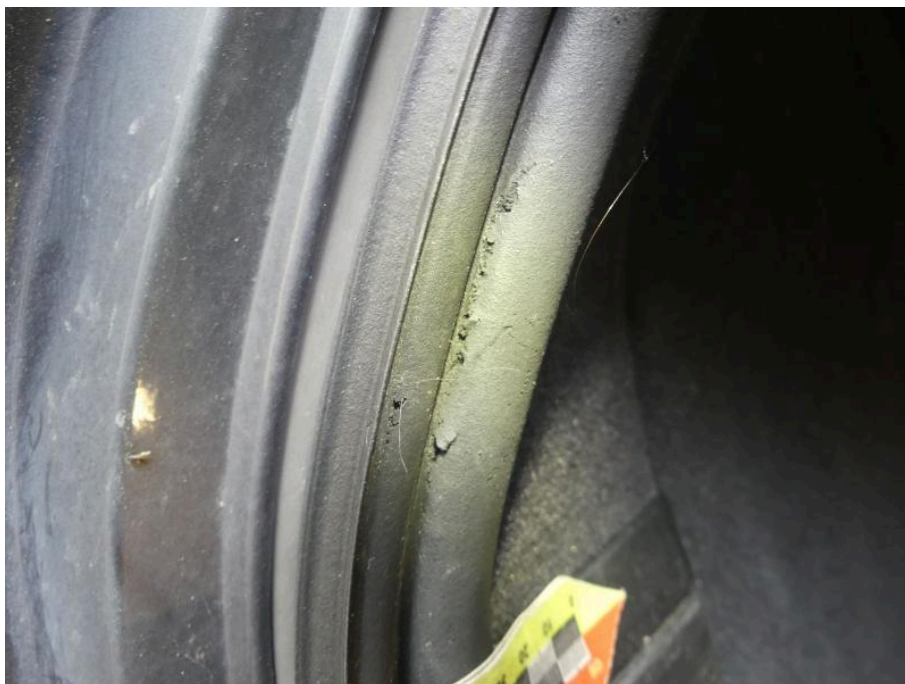
Bild 25 Fahrzeugheck Heckklappendichtung gerissen / eingerissen
