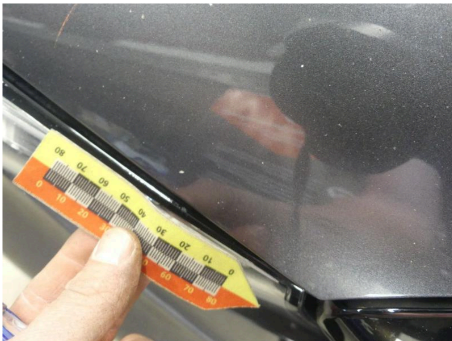
Bild 37 Fahrzeugfront Motorhaube Steinschlag / -schläge
