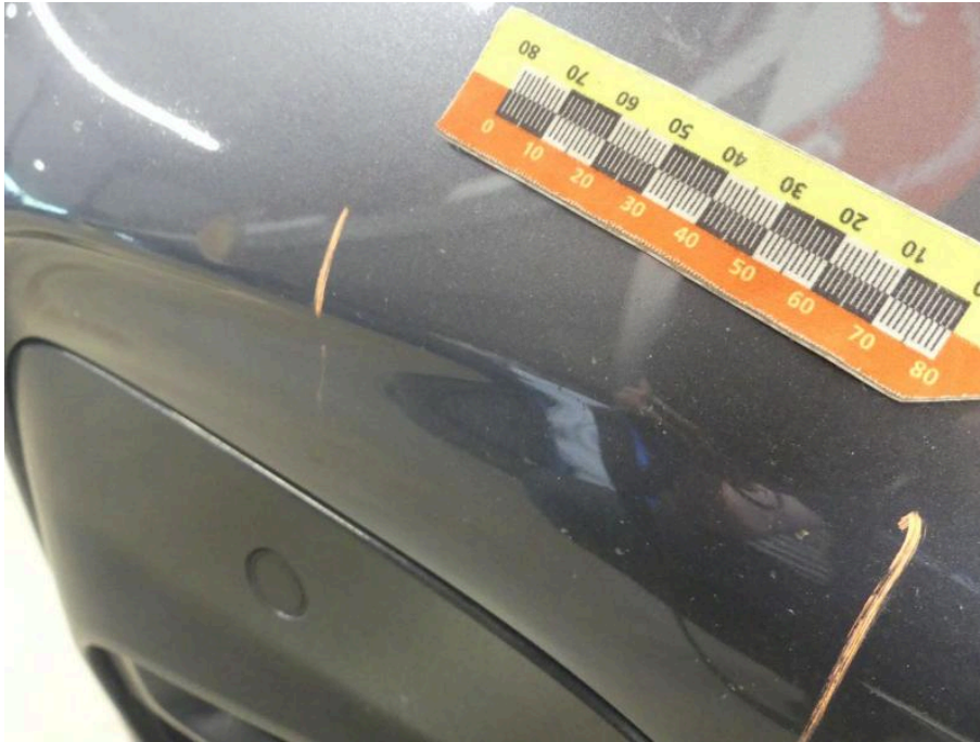
Bild 39 Fahrzeugfront Stoßfänger vorne Steinschlag / -schläge
