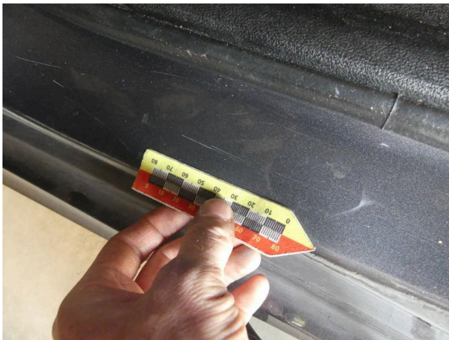
Bild 21 Innenraum Einstieg hinten links verkratzt
