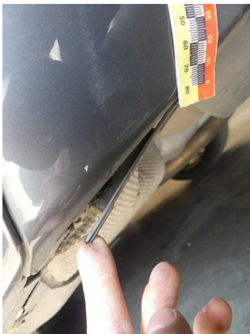
Bild 30 Fahrzeugheck Stoßfänger hinten verkratzt
