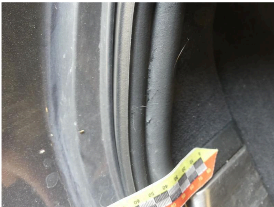
Bild 24 Fahrzeugheck Heckklappendichtung gerissen / eingerissen
