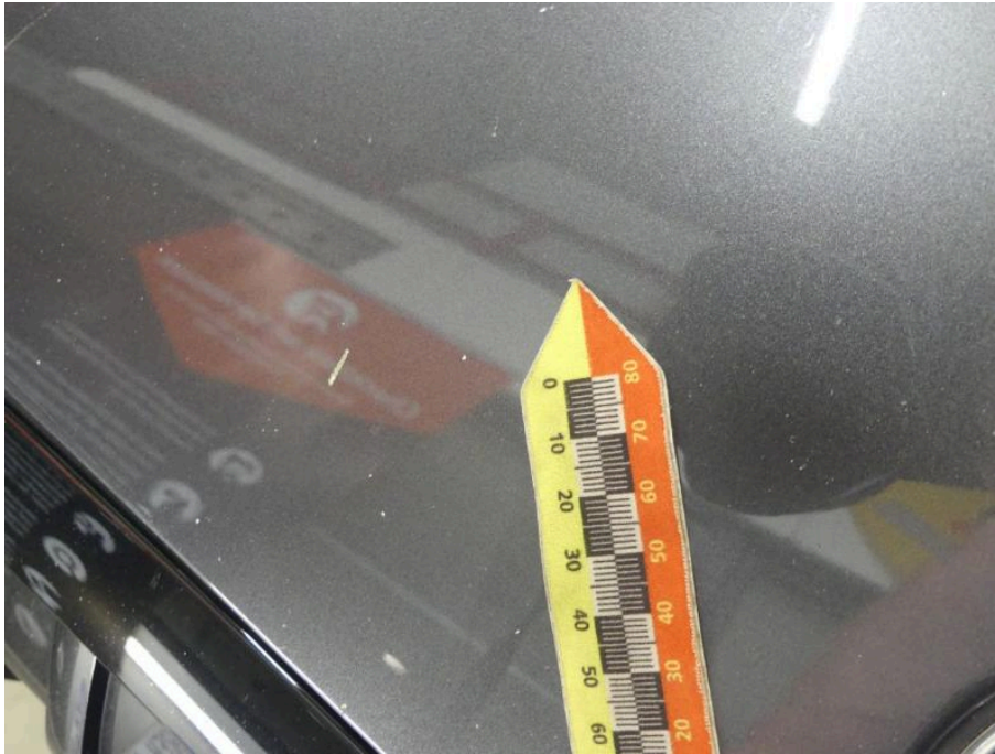
Bild 35 Fahrzeugfront Motorhaube Steinschlag / -schläge
