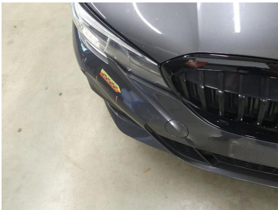
Bild 38 Fahrzeugfront Stoßfänger vorne Steinschlag / -schläge
