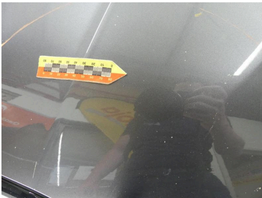
Bild 34 Fahrzeugfront Motorhaube Steinschlag / -schläge
