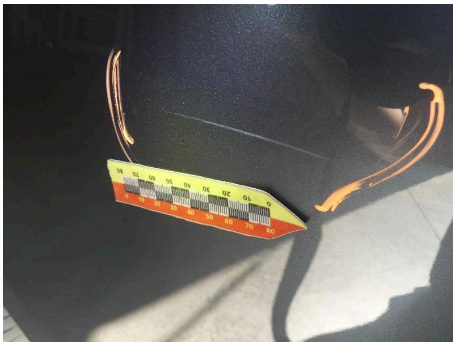
Bild 32 Fahrzeugheck Stoßfänger hinten verkratzt
