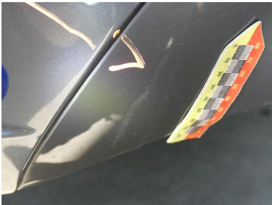
Bild 31 Fahrzeugheck Stoßfänger hinten verkratzt
