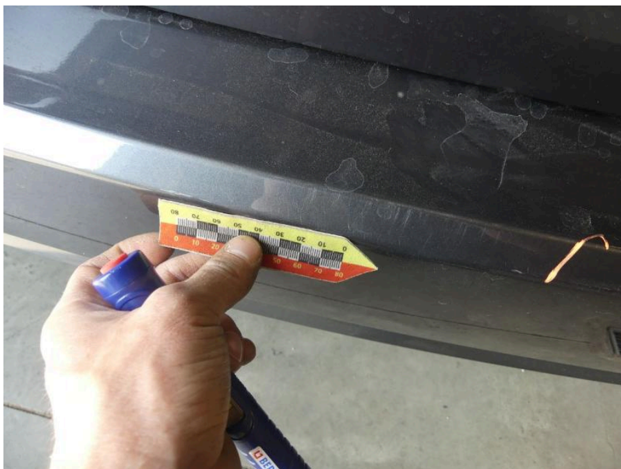
Bild 28 Fahrzeugheck Stoßfänger hinten verkratzt
