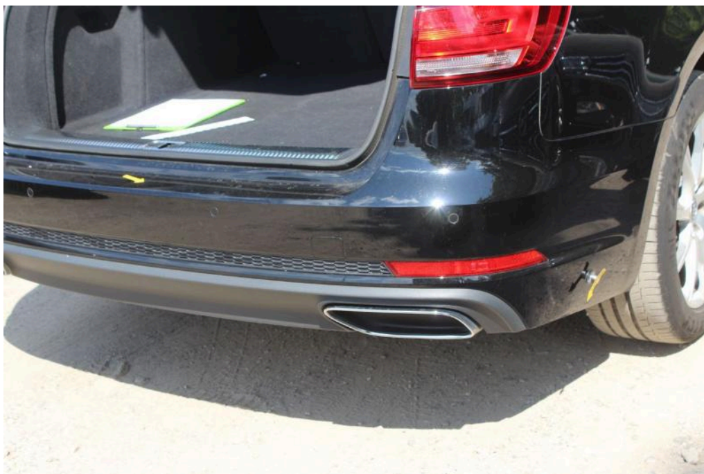
Bild 30 Fahrzeugheck Stoßfänger hinten zerkratzt
