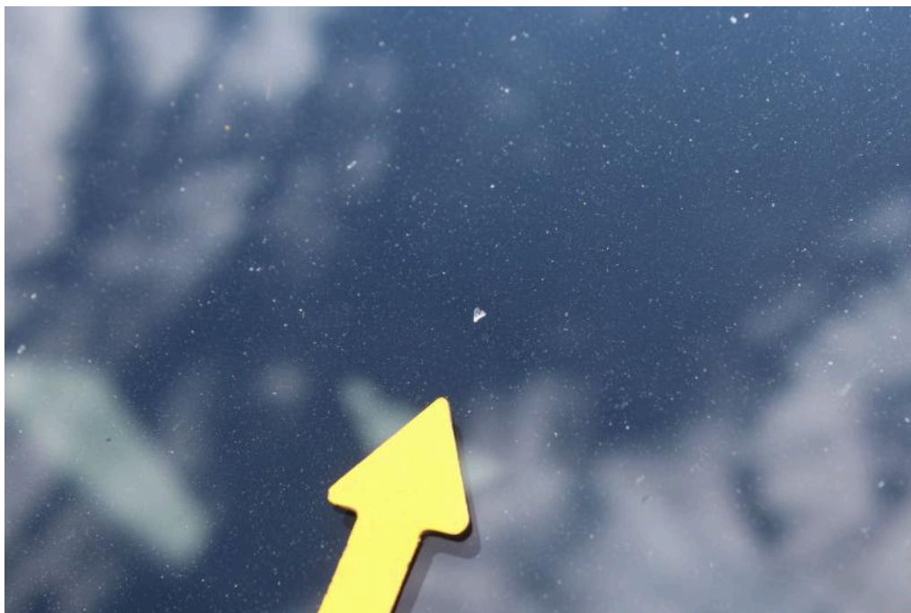
Bild 29 Fahrzeugfront Frontscheibe mit Frontkamera Steinschlag / -schläge
