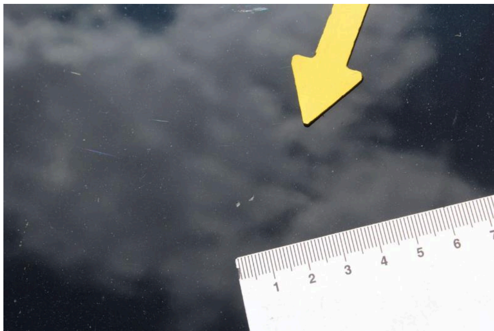
Bild 24 Fahrzeugfront Motorhaube Steinschlag / -schläge
