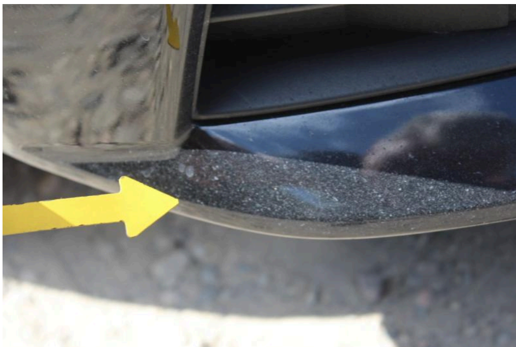
Bild 20 Fahrzeugfront Stoßfänger vorne Delle, Kratzer Steinschlag / -schläge
