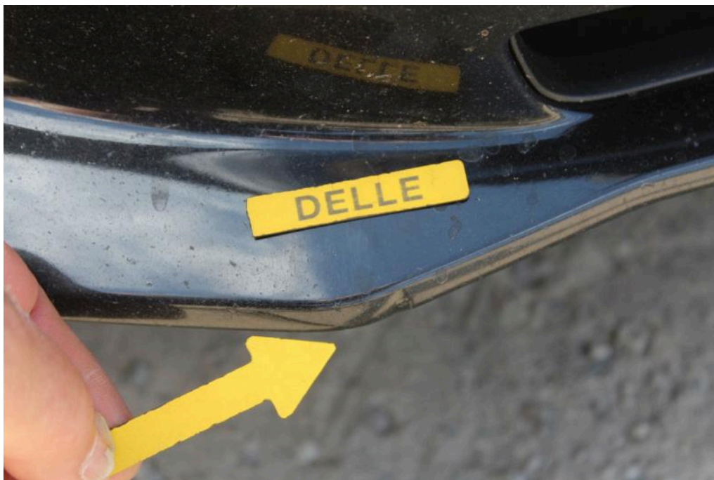
Bild 19 Fahrzeugfront Stoßfänger vorne Delle, Kratzer Steinschlag / -schläge
