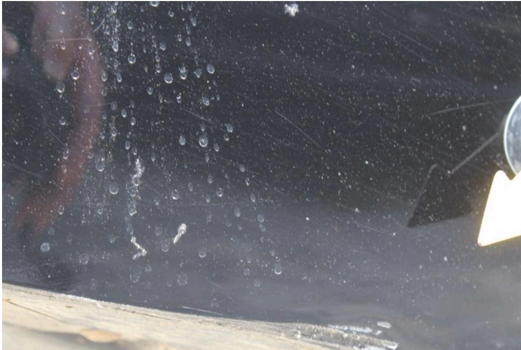
Bild 33 Fahrzeugheck Stoßfänger hinten zerkratzt
