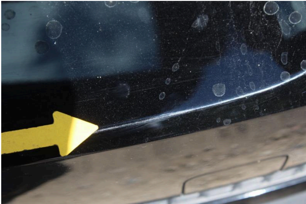
Bild 32 Fahrzeugheck Stoßfänger hinten zerkratzt
