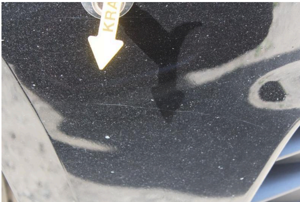
Bild 21 Fahrzeugfront Stoßfänger vorne Delle, Kratzer Steinschlag / -schläge
