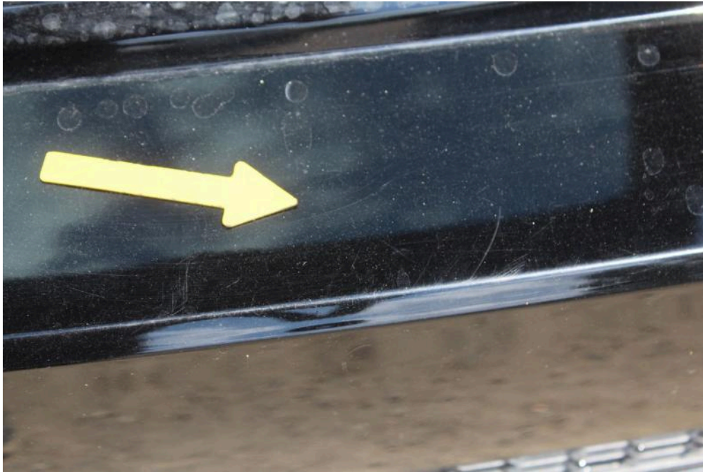
Bild 31 Fahrzeugheck Stoßfänger hinten zerkratzt
