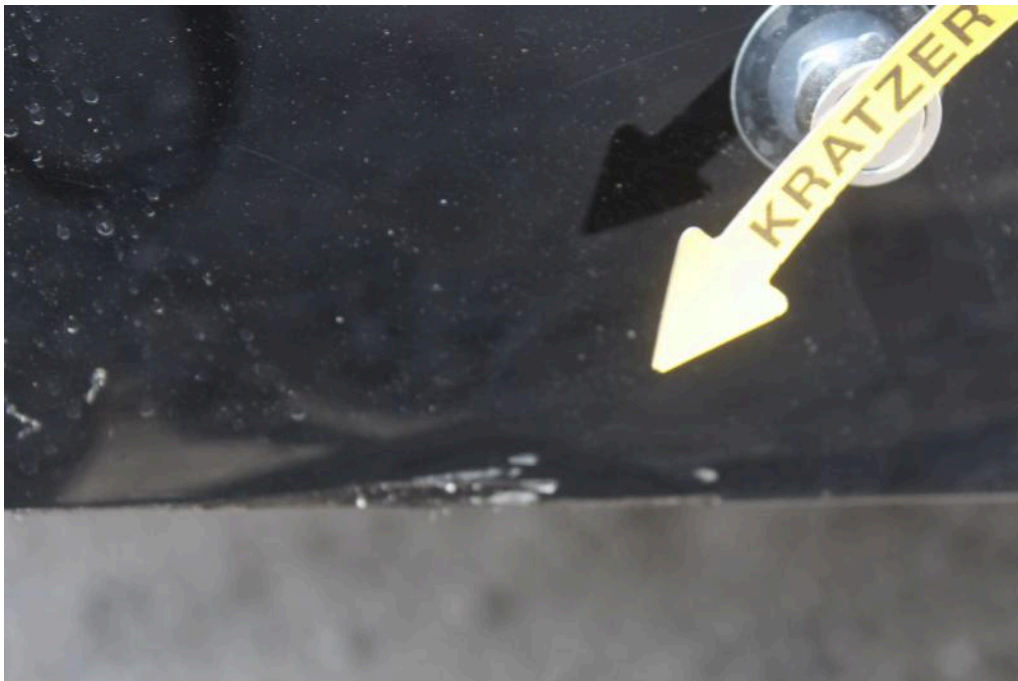
Bild 34 Fahrzeugheck Stoßfänger hinten zerkratzt
