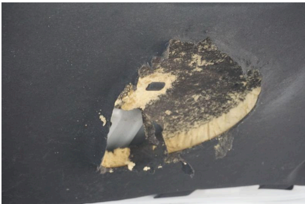
Bild 18 Fahrzeugfront Dämmung Motorhaube gerissen / eingerissen
