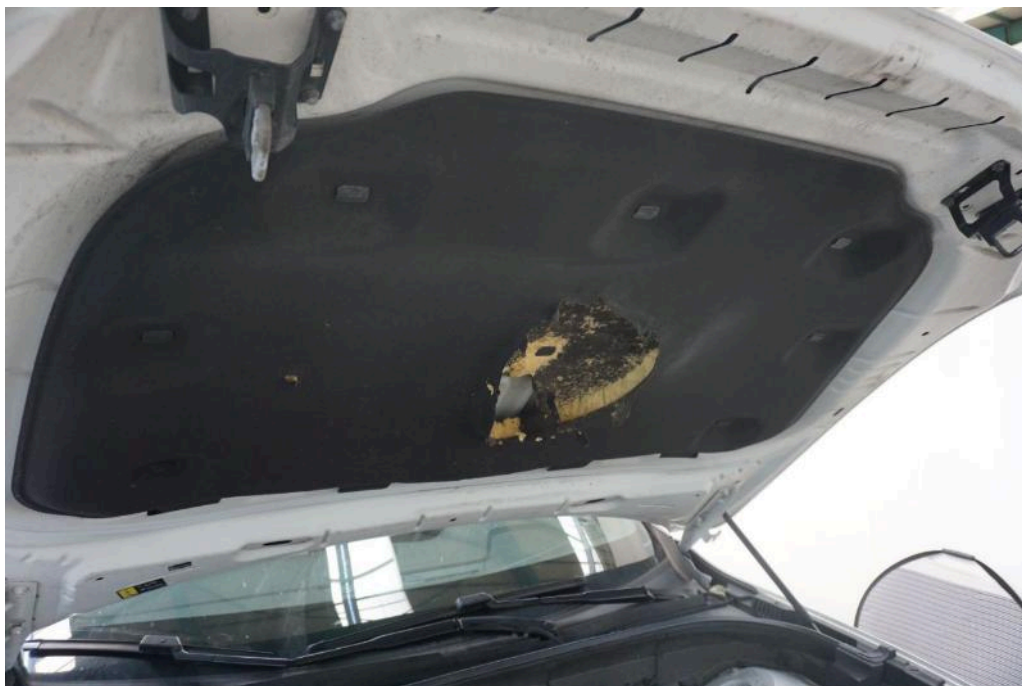
Bild 17 Fahrzeugfront Dämmung Motorhaube gerissen / eingerissen
