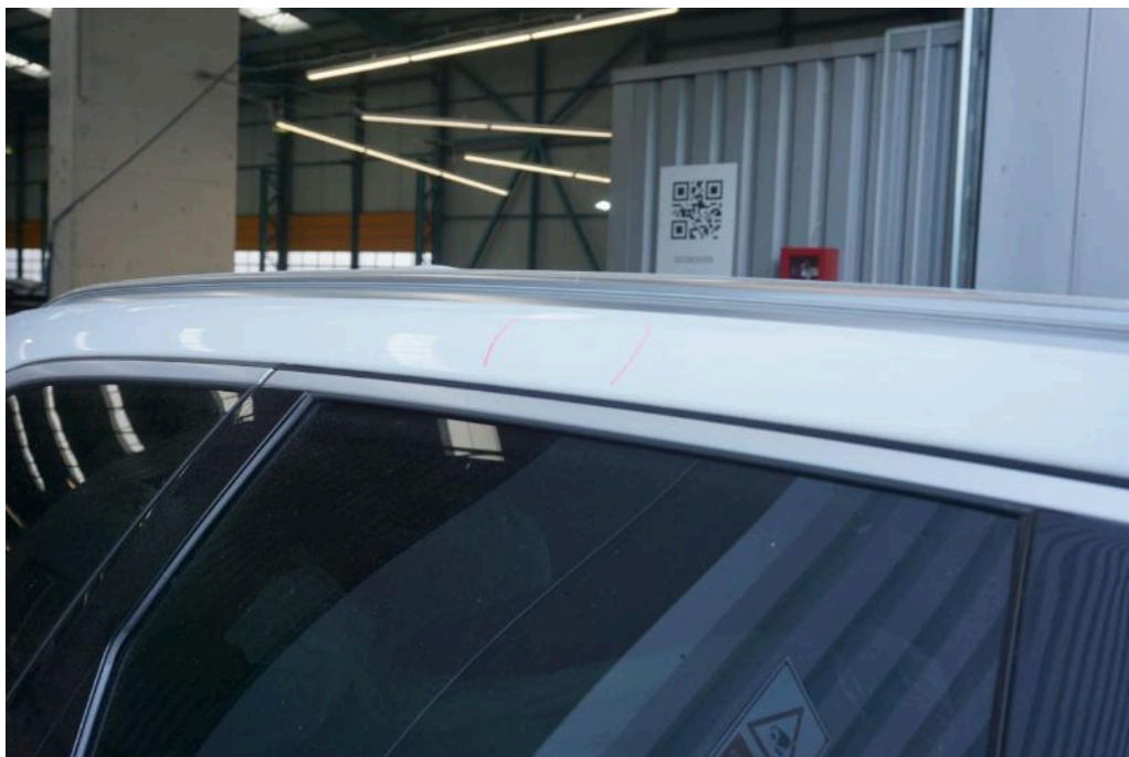
Bild 21 Dach Dachholm rechts Delle
