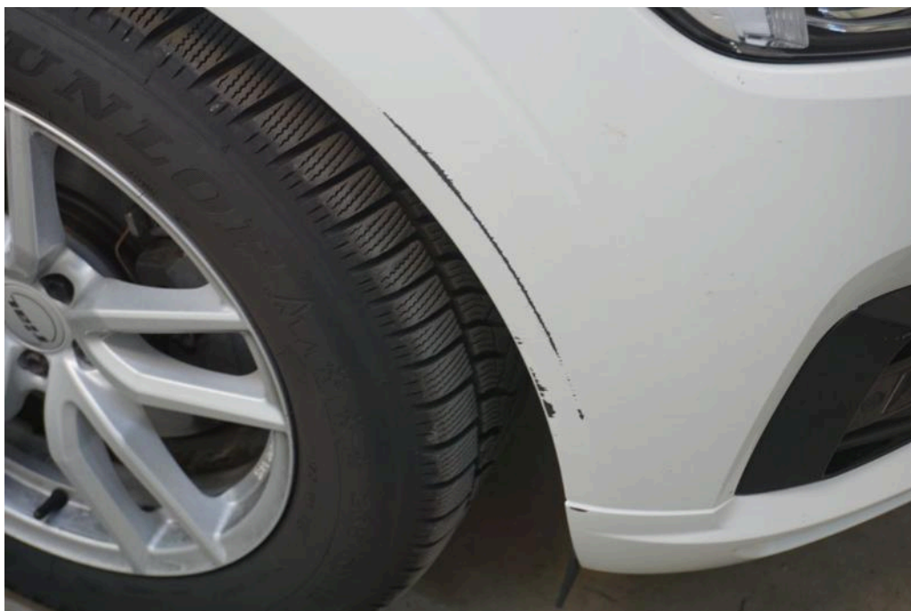
Bild 20 Fahrzeugfront Stoßfänger vorne verkratzt
