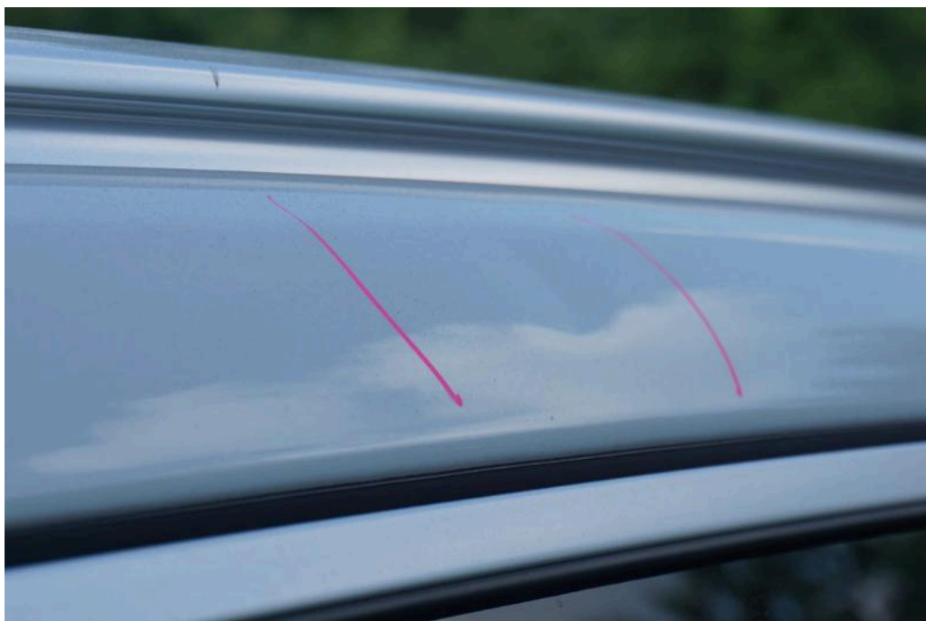
Bild 22 Dach Dachholm rechts Delle
