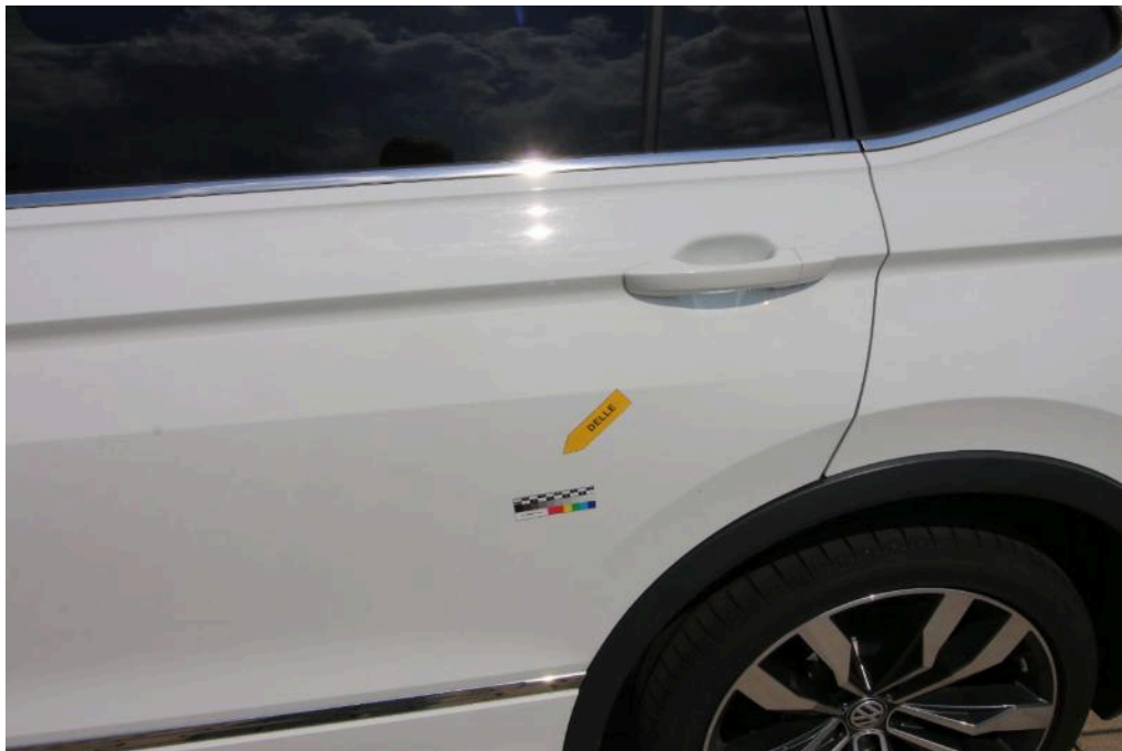
Bild 18 linke Seite Tür hinten links Delle
