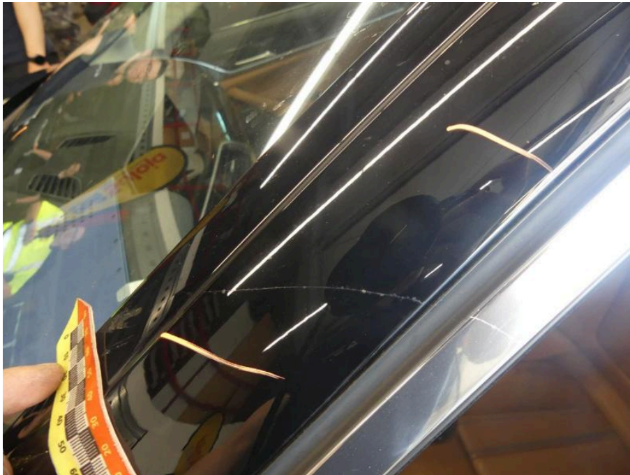
Bild 46 linke Seite A-Säule links Kratzer - lackieren - Türblende verkratzt verkratzt
