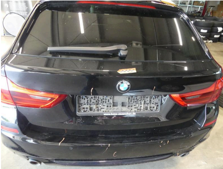
Bild 53 Fahrzeugheck Heckklappe verkratzt
