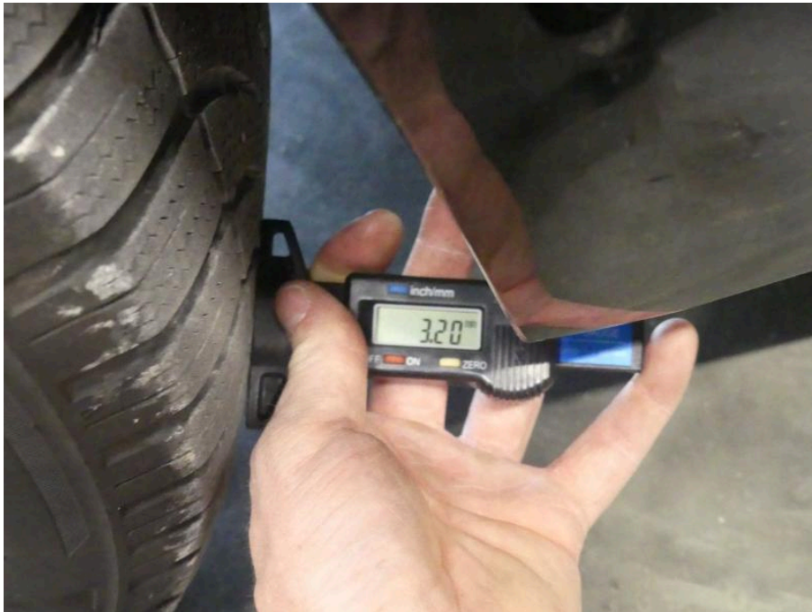
Bild 36 Fahrzeugheck Zwei Reifen Profiltiefe unter 4 mm – Vertragsgemäß verschlissen
