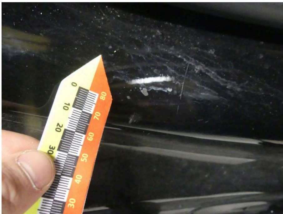
Bild 25 Fahrzeug Türeinstiege Gebrauchsspuren
