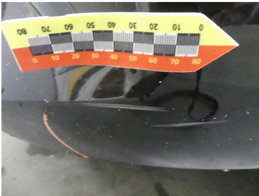
Bild 57 Fahrzeugfront Stoßfänger vorne verkratzt
