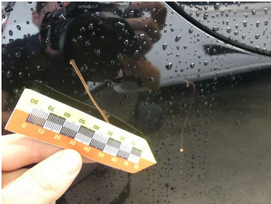
Bild 44 Fahrzeugheck Stoßfänger hinten verformt + verkratzt
