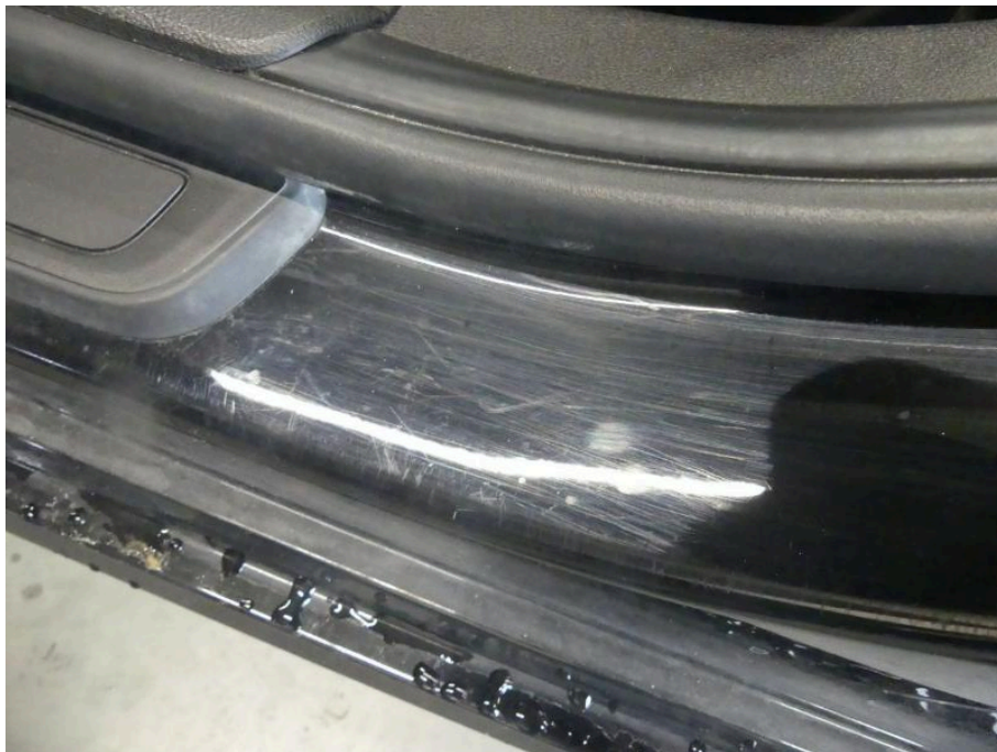
Bild 24 Fahrzeug Türeinstiege Gebrauchsspuren
