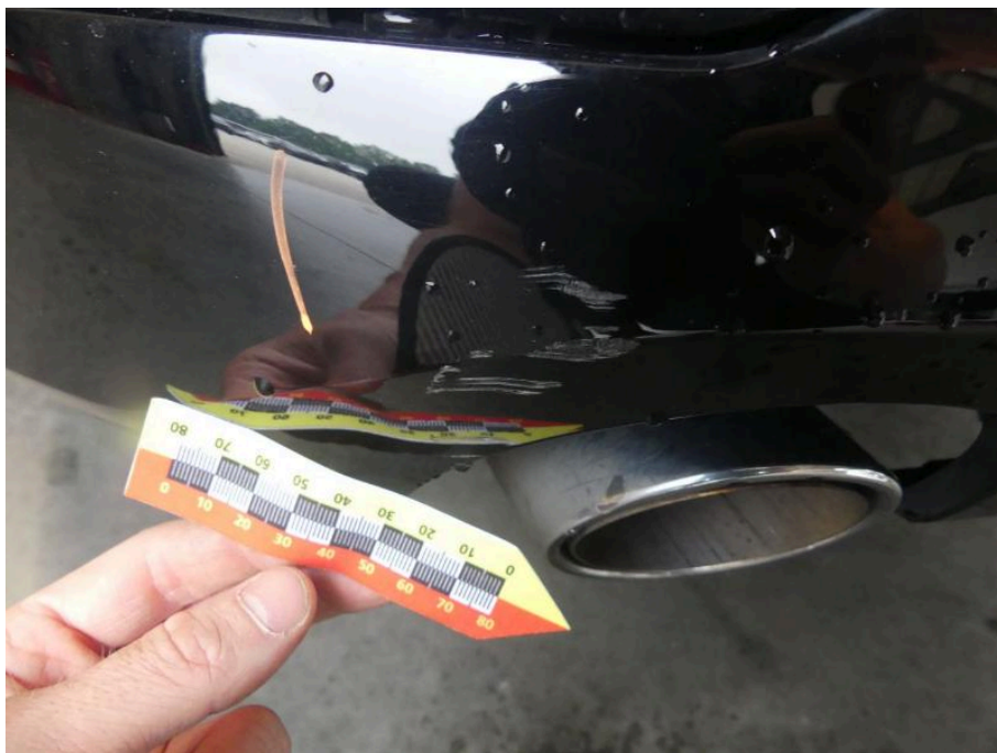
Bild 39 Fahrzeugheck Stoßfänger hinten verformt + verkratzt
