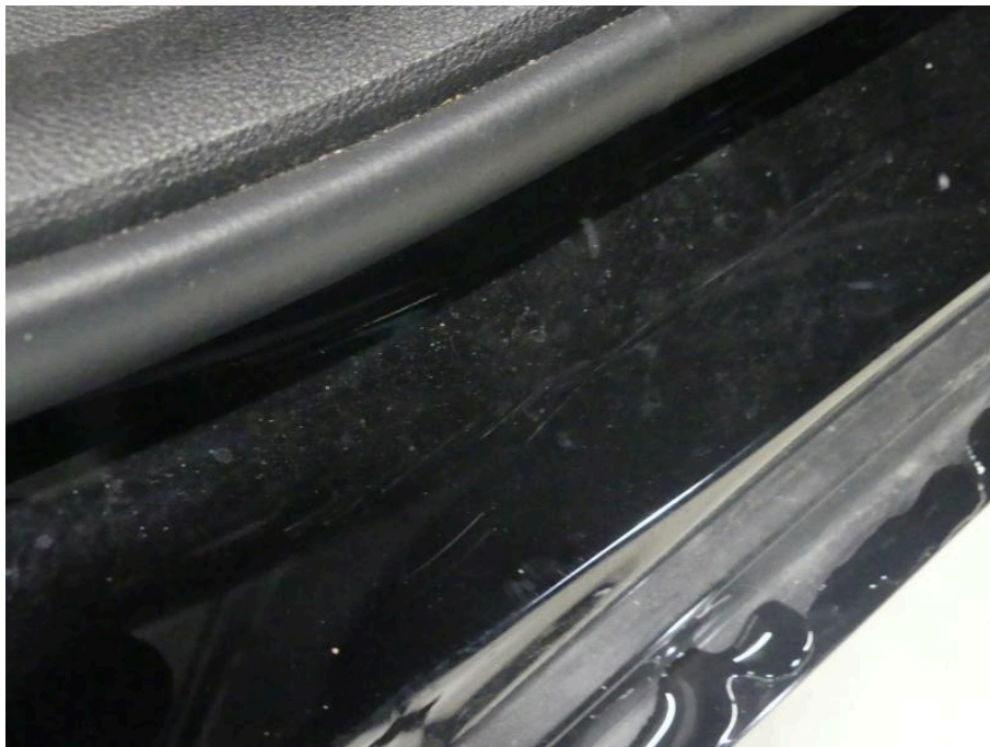
Bild 26 Fahrzeug Türeinstiege Gebrauchsspuren
