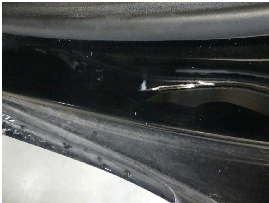
Bild 18 Fahrzeug Türeinstiege Gebrauchsspuren
