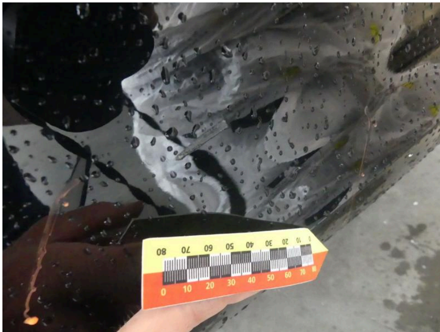
Bild 42 Fahrzeugheck Stoßfänger hinten verformt + verkratzt
