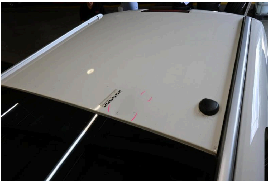
Bild 21 Dach Dachhaut mit Lackbeschädigung Dellen
