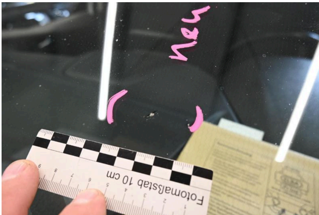
Bild 19 Fahrzeugfront Windschutzscheibe Steinschlag
