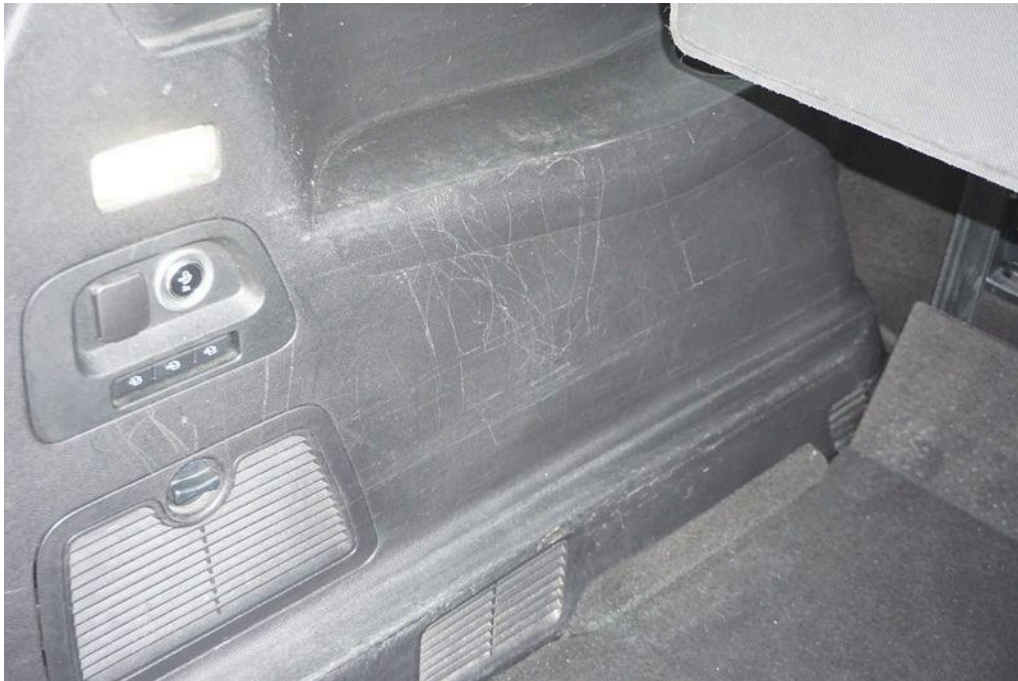
Bild 30 Innenraum Laderaum an Verkleidungen Gebrauchsspuren/ Nutzungsspuren erkennbar
