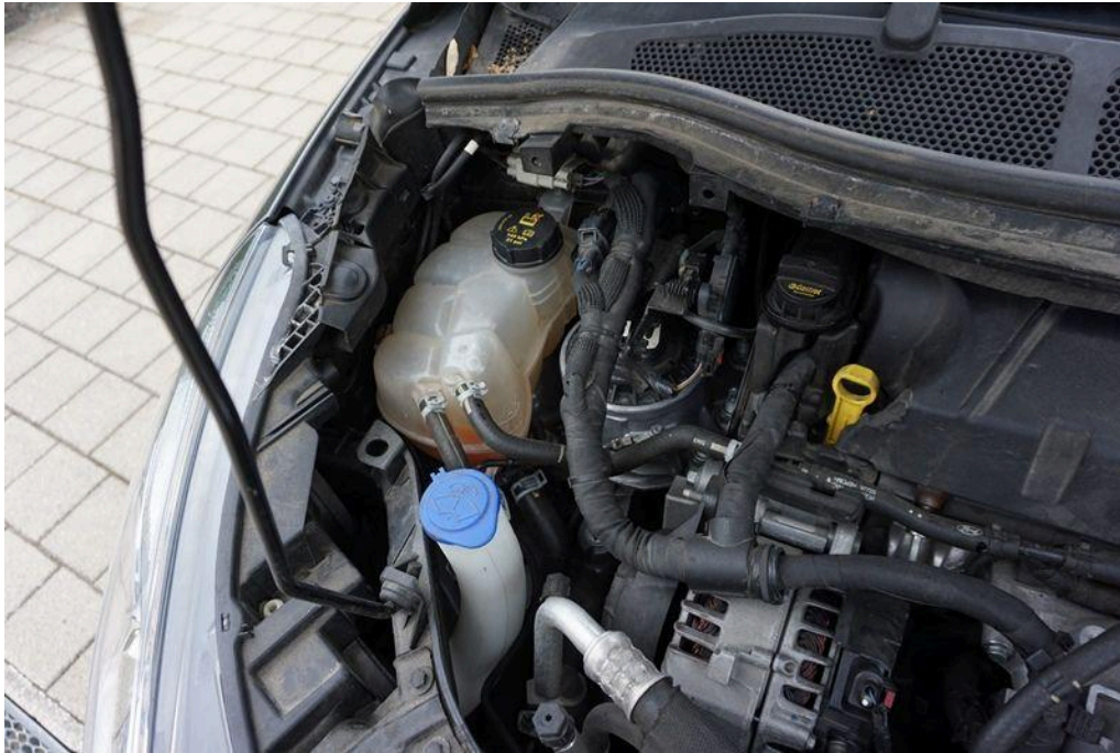
Bild 35 Wartung/Prüfung Kühlflüssigkeit Ausgleichsbehälter leer, auffüllen, erkennbar
