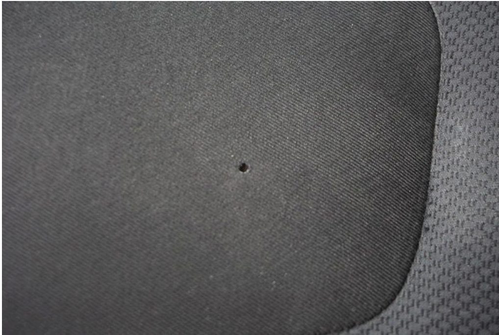
Bild 23 Innenraum Fahrersitz Brandloch / Brandlöcher reparabel
