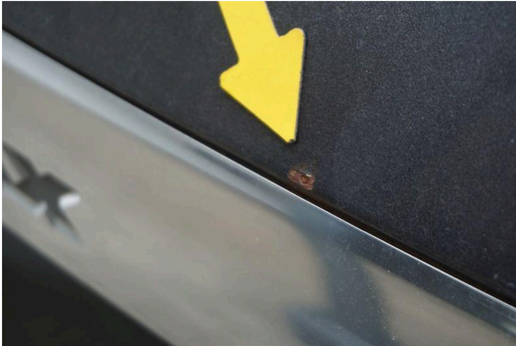
Bild 73 Fahrzeugheck Heckklappe Abdeckung verkratzt, Korrosion an Heckklappe (tiefer Rostpunkt) erkennbar
