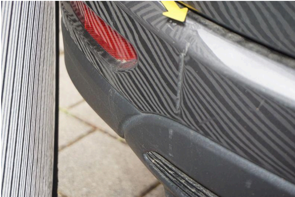
Bild 68 Fahrzeugheck Stoßfänger hinten verkratzt/ verschürft/ deformiert, Kratzer
