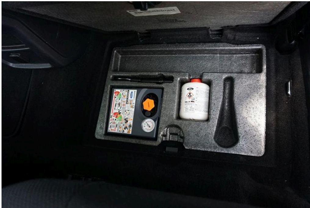
Bild 19 Fahrzeugzubehör Reifenfüllset/Tirefit Dichtmittel abgelaufen
