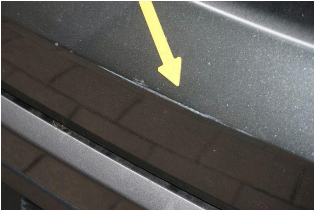
Bild 70 Fahrzeugheck Heckklappe Abdeckung verkratzt, Korrosion an Heckklappe (tiefer Rostpunkt) erkennbar
