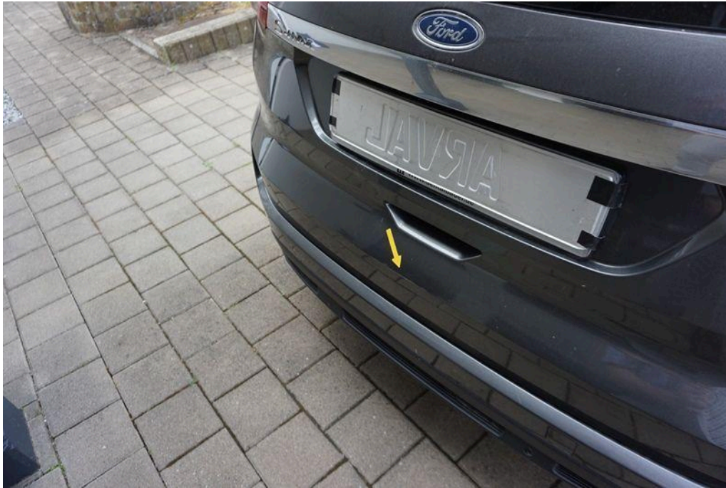
Bild 69 Fahrzeugheck Heckklappe Abdeckung verkratzt, Korrosion an Heckklappe (tiefer Rostpunkt) erkennbar
