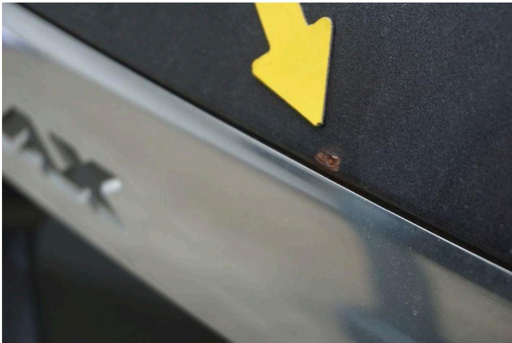
Bild 72 Fahrzeugheck Heckklappe Abdeckung verkratzt, Korrosion an Heckklappe (tiefer Rostpunkt) erkennbar
