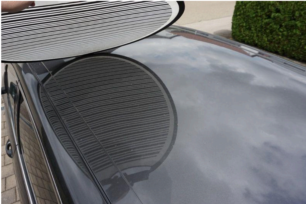
Bild 78 Fahrzeug Witterungsbedingt Flecken/ leichte Staubauflage, ggf. Nachbesichtigung empfohlen nicht erkennbar
