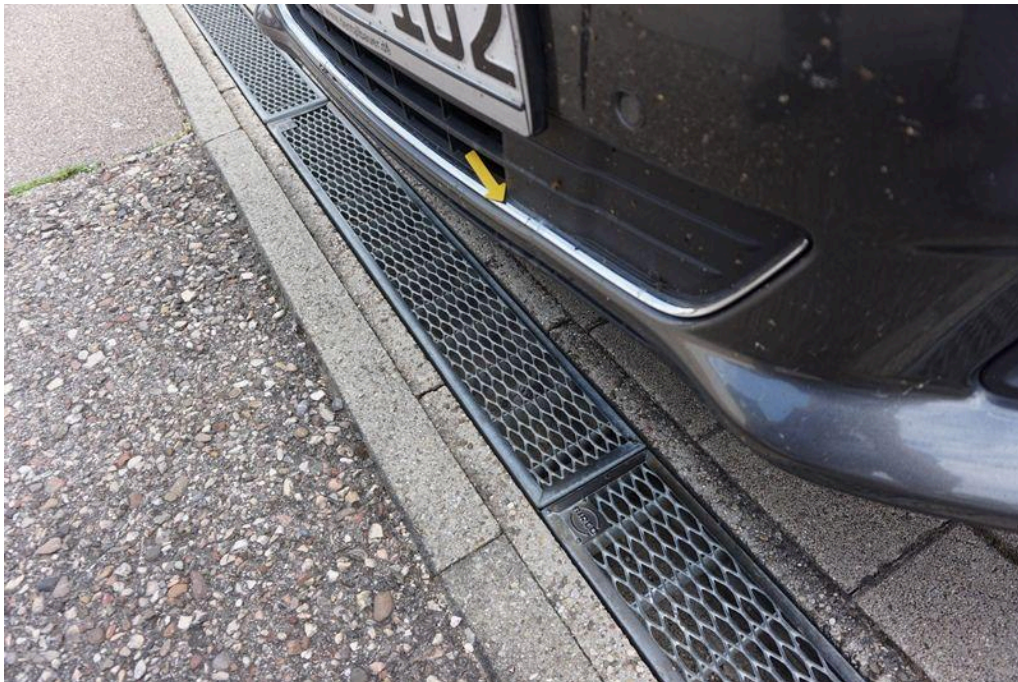
Bild 52 Fahrzeugfront Stoßfänger vorne unten Druckstelle, Chromrahmen am Gitter unten gebrochen, Rahmen bzw. Gitter unten erneuern deformiert
