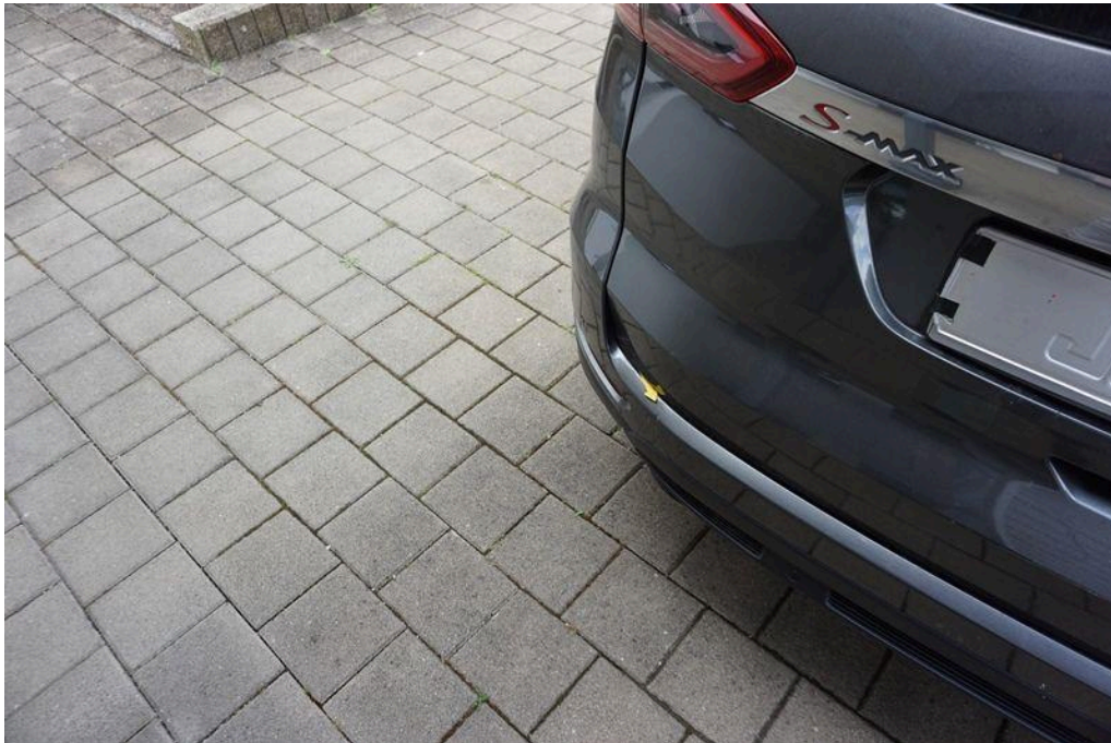
Bild 66 Fahrzeugheck Stoßfänger hinten verkratzt/ verschürft/ deformiert, Kratzer
