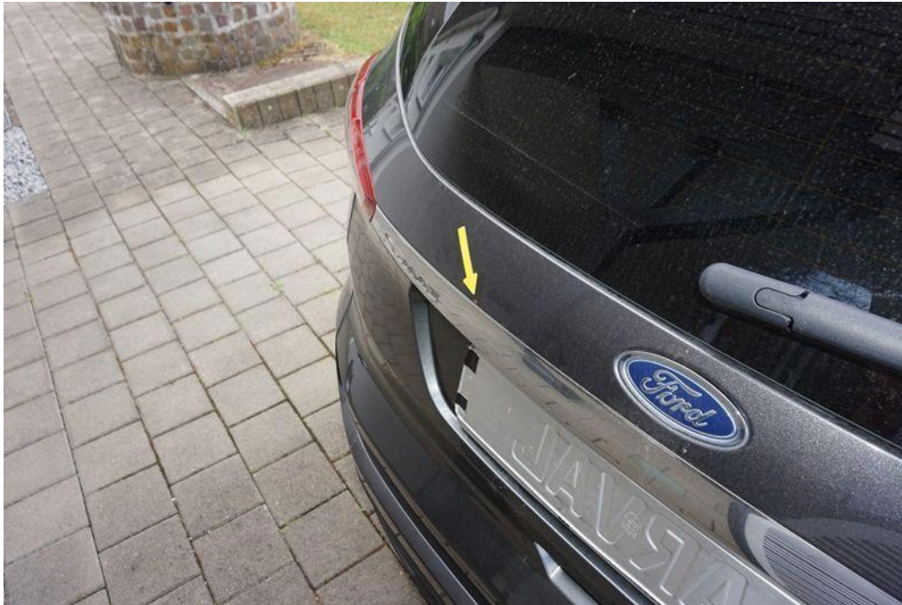
Bild 71 Fahrzeugheck Heckklappe Abdeckung verkratzt, Korrosion an Heckklappe (tiefer Rostpunkt) erkennbar
