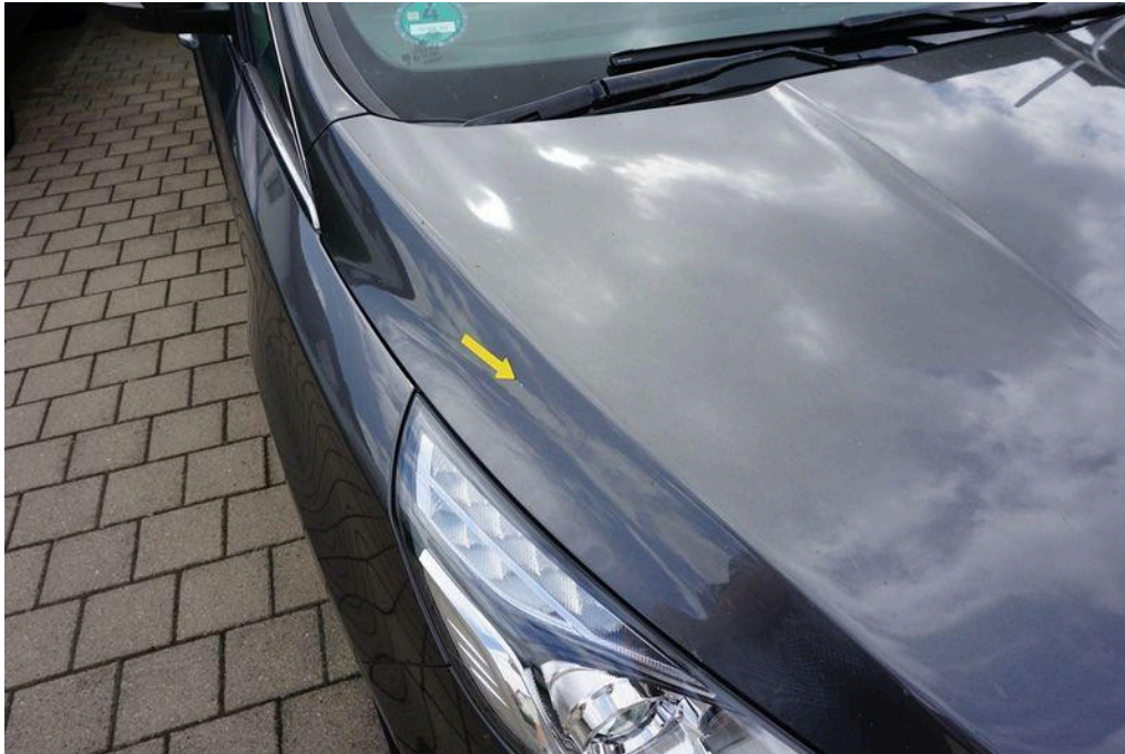
Bild 49 Fahrzeugfront Motorhaube Steinschlag / -schläge
