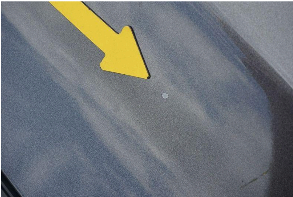
Bild 50 Fahrzeugfront Motorhaube Steinschlag / -schläge
