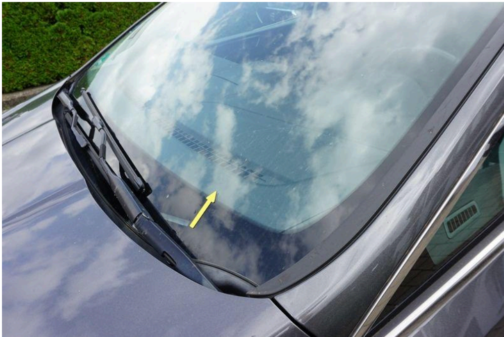
Bild 54 Fahrzeugfront Frontscheibe mit Regensensor Reparierter Steinschlag, Gebrauchsspursteinschläge Gebrauchsspuren
