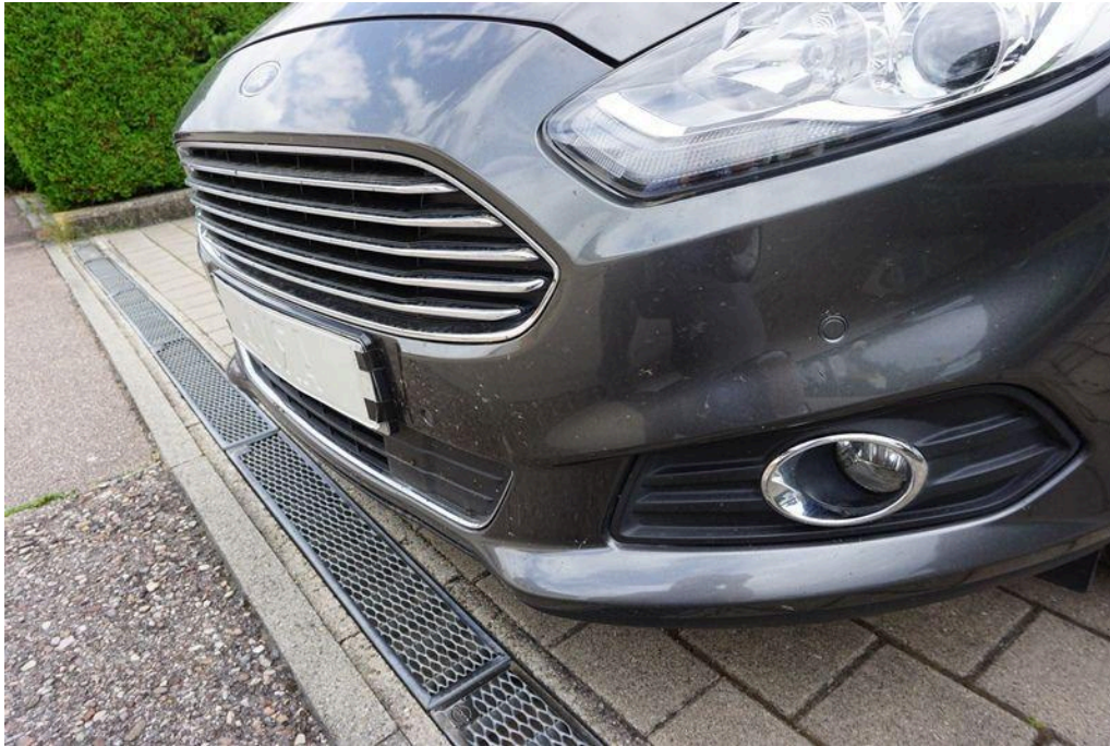
Bild 51 Fahrzeugfront Stoßfänger vorne unten Druckstelle, Chromrahmen am Gitter unten gebrochen, Rahmen bzw. Gitter unten erneuern deformiert
