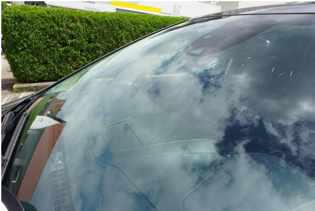
Bild 56 Fahrzeugfront Frontscheibe mit Regensensor Reparierter Steinschlag, Gebrauchsspursteinschläge Gebrauchsspuren
