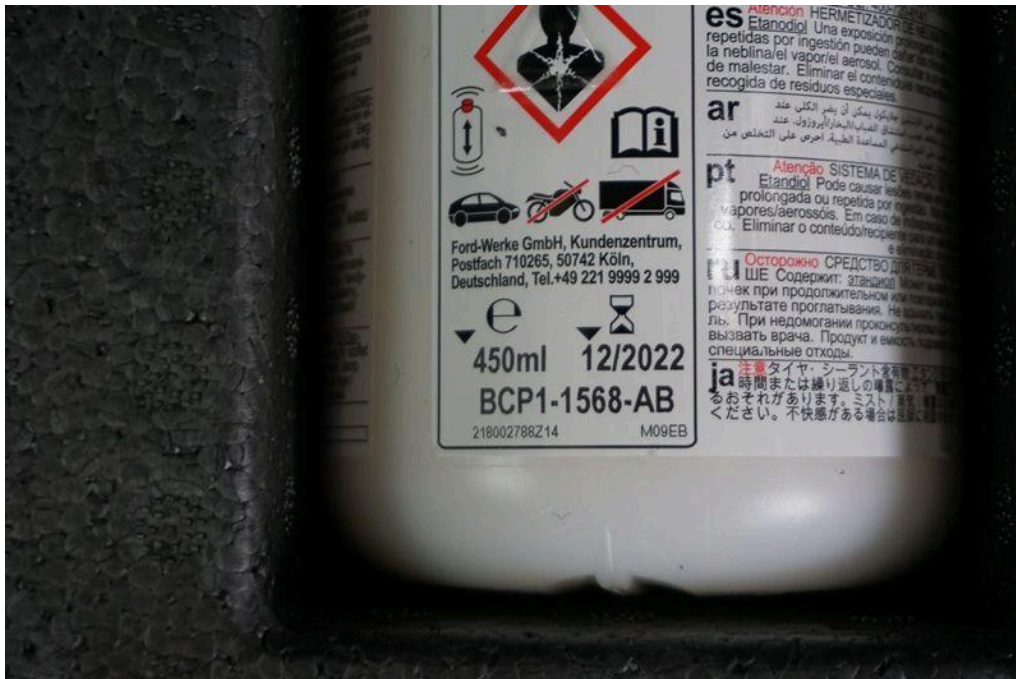
Bild 20 Fahrzeugzubehör Reifenfüllset/Tirefit Dichtmittel abgelaufen
