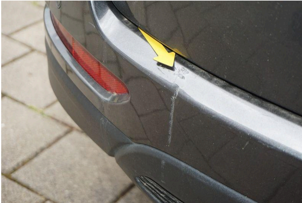
Bild 67 Fahrzeugheck Stoßfänger hinten verkratzt/ verschürft/ deformiert, Kratzer
