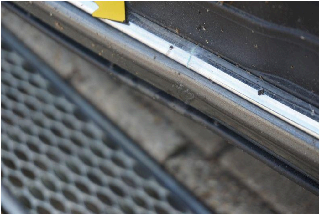
Bild 53 Fahrzeugfront Stoßfänger vorne unten Druckstelle, Chromrahmen am Gitter unten gebrochen, Rahmen bzw. Gitter unten erneuern deformiert
