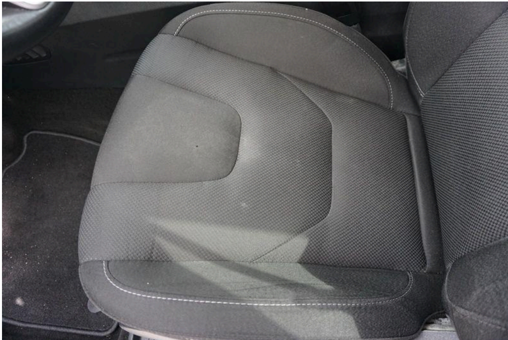
Bild 22 Innenraum Fahrersitz Brandloch / Brandlöcher reparabel
