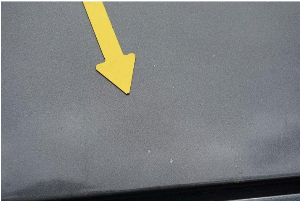
Bild 48 Fahrzeugfront Motorhaube Steinschlag / -schläge
