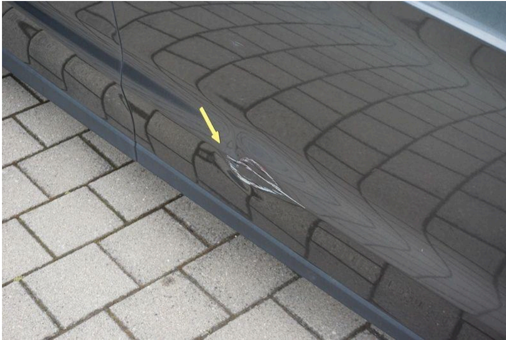
Bild 59 rechte Seite Tür vorne rechts Türe vorne rechts Delle deformiert
