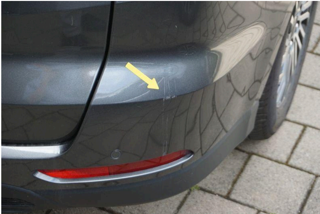
Bild 64 Fahrzeugheck Stoßfänger hinten verkratzt/ verschürft/ deformiert, Kratzer
