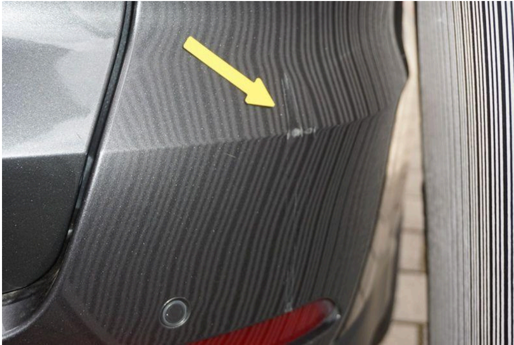
Bild 65 Fahrzeugheck Stoßfänger hinten verkratzt/ verschürft/ deformiert, Kratzer
