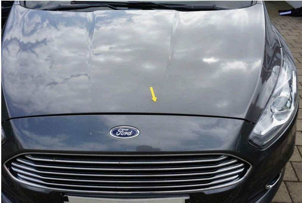
Bild 47 Fahrzeugfront Motorhaube Steinschlag / -schläge
