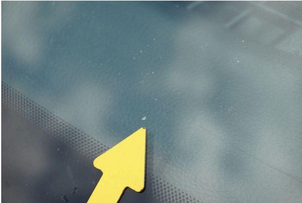
Bild 55 Fahrzeugfront Frontscheibe mit Regensensor Reparierter Steinschlag, Gebrauchsspursteinschläge Gebrauchsspuren
