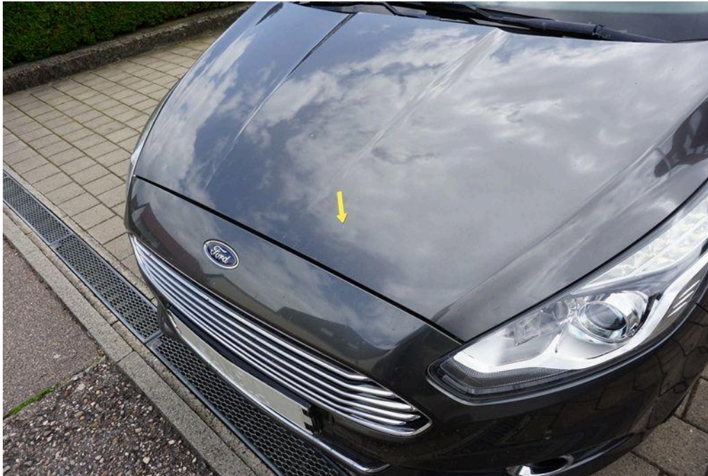
Bild 45 Fahrzeugfront Motorhaube Steinschlag / -schläge
