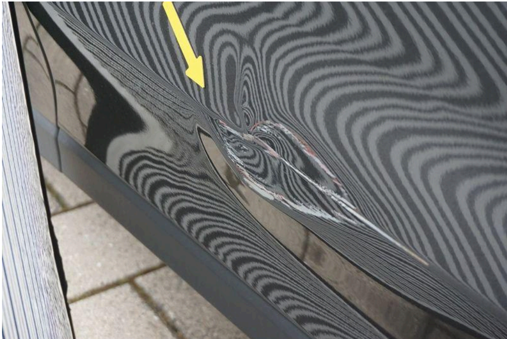
Bild 60 rechte Seite Tür vorne rechts Türe vorne rechts Delle deformiert
