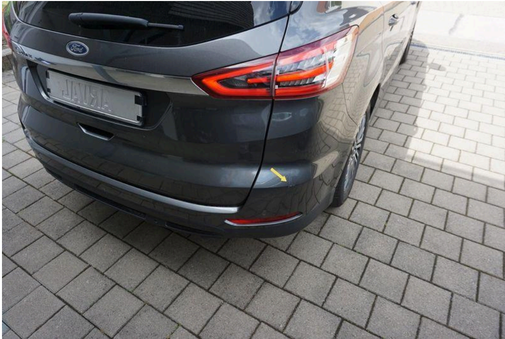
Bild 63 Fahrzeugheck Stoßfänger hinten verkratzt/ verschürft/ deformiert, Kratzer
