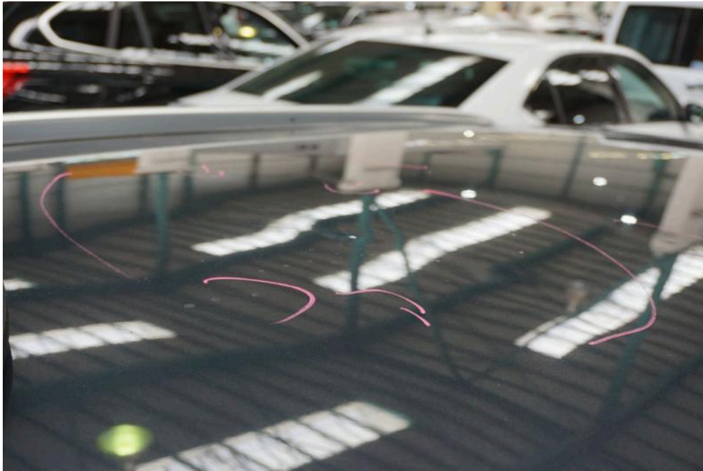
Bild 23 Dach Dachhaut verformt, verbeult Dellen
