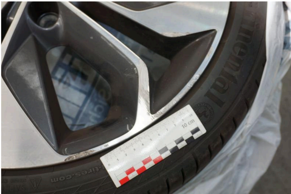
Bild 18 Fahrzeugzubehör Sommerreifensatz 1 LM-Felge 7,5x18 (Voyage) und 1 Sommerreifen Materialabtrag
