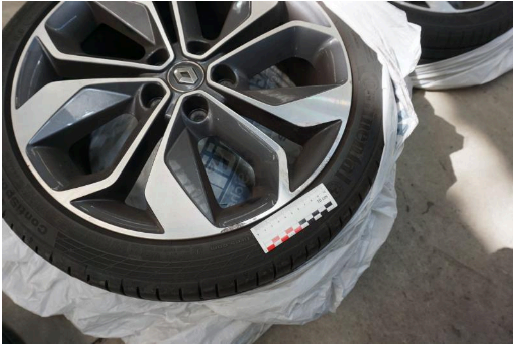
Bild 17 Fahrzeugzubehör Sommerreifensatz 1 LM-Felge 7,5x18 (Voyage) und 1 Sommerreifen Materialabtrag
