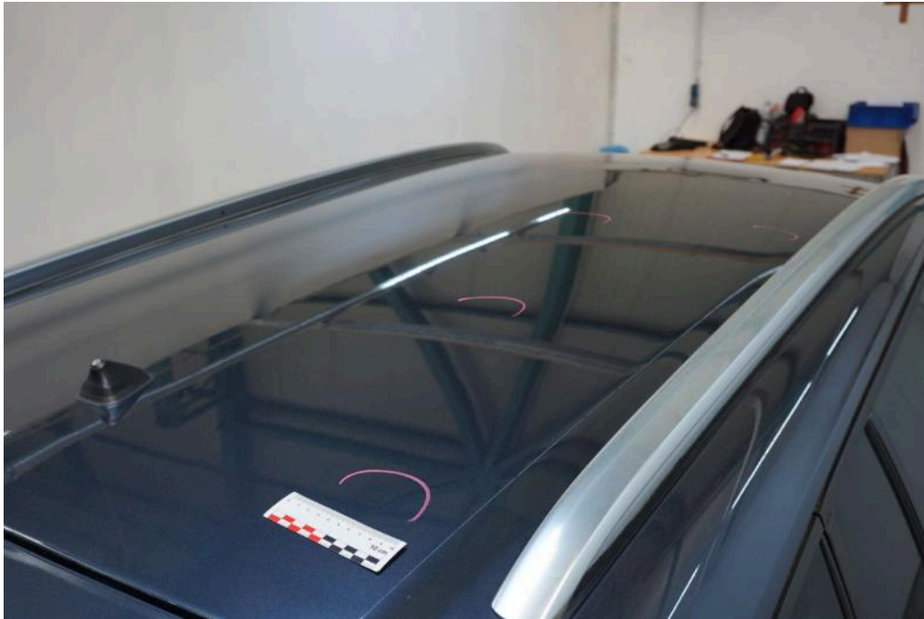
Bild 21 Dach Dachhaut verformt, verbeult Dellen
