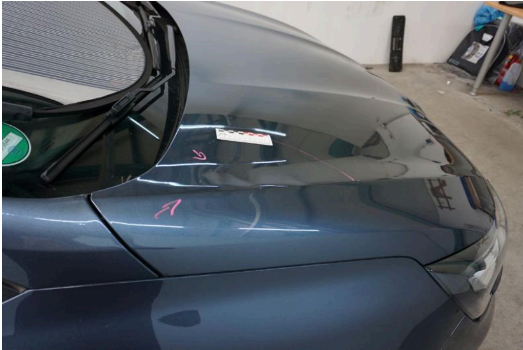
Bild 25 Fahrzeugfront Motorhaube verformt
