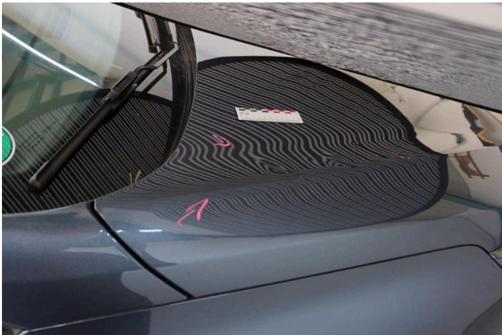
Bild 26 Fahrzeugfront Motorhaube verformt
