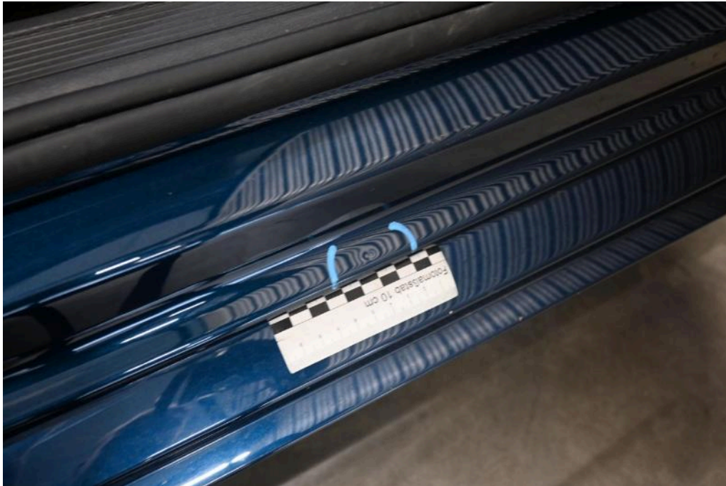
Bild 31 Innenraum Einstieg vorne rechts Delle
