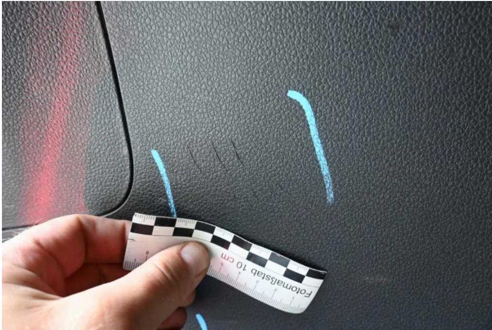
Bild 27 Innenraum Heckklappenverkleidung innen verkratzt
