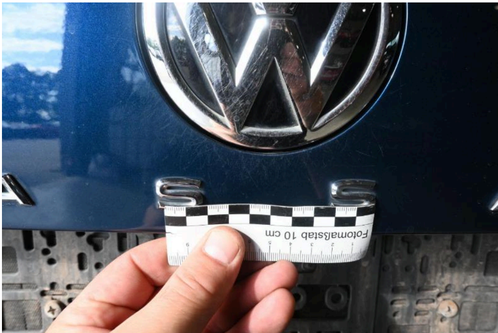
Bild 24 Fahrzeugheck Heckklappe Kratzer, Klebereste Delle
