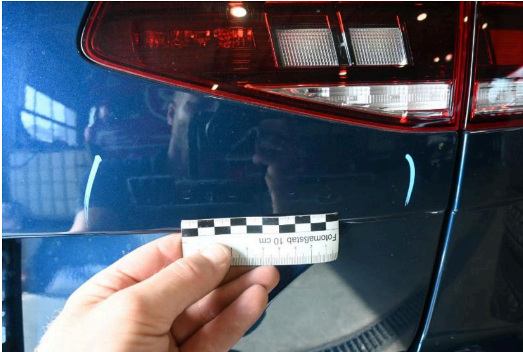
Bild 25 Fahrzeugheck Heckklappe Kratzer, Klebereste Delle
