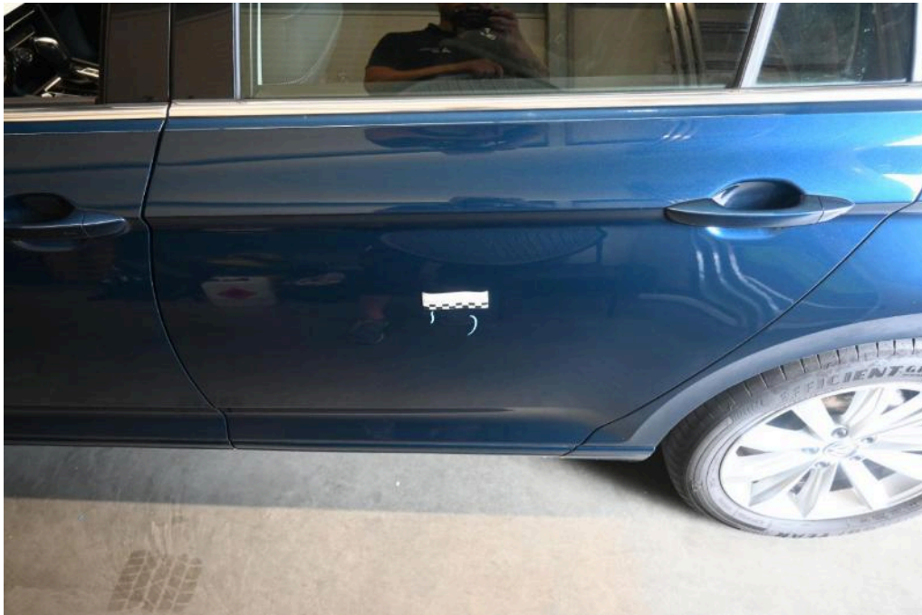
Bild 20 linke Seite Tür hinten links Beule
