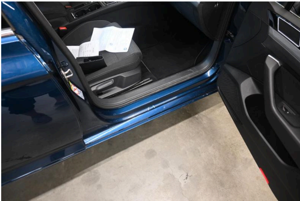
Bild 30 Innenraum Einstieg vorne rechts Delle
