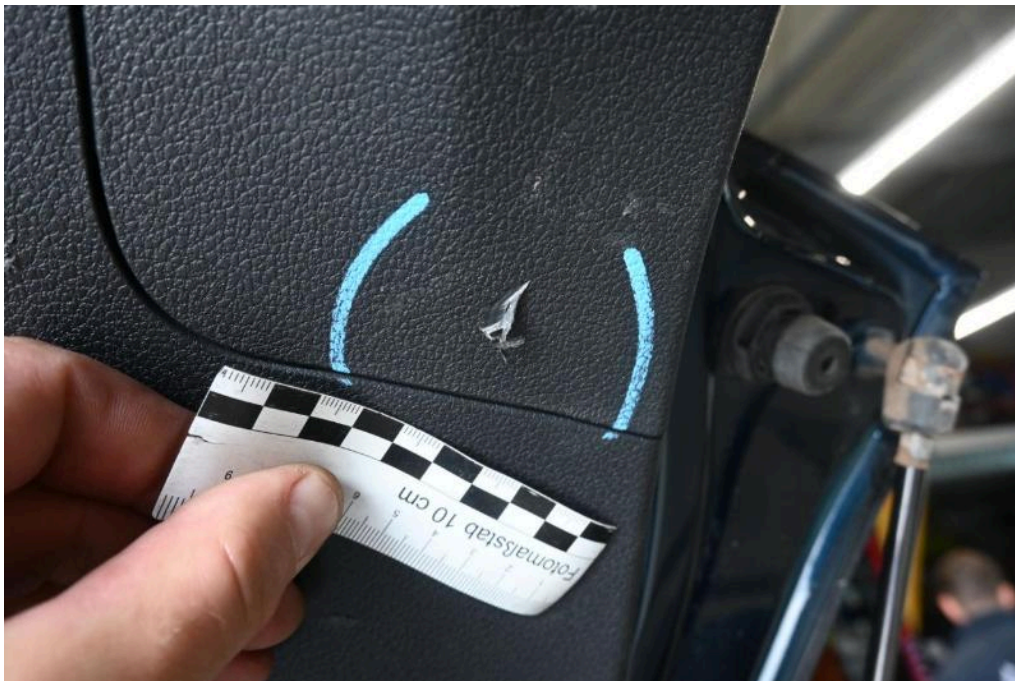
Bild 28 Innenraum Heckklappenverkleidung innen verkratzt
