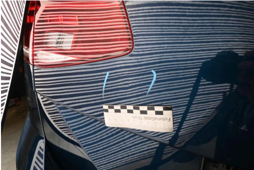
Bild 23 Fahrzeugheck Heckklappe Kratzer, Klebereste Delle
