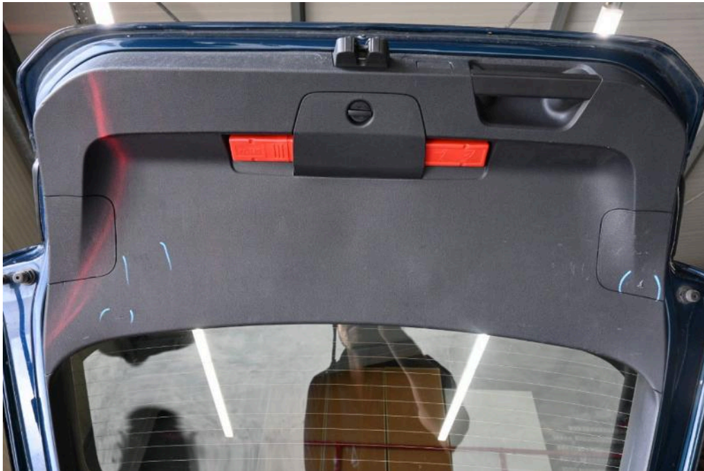
Bild 26 Innenraum Heckklappenverkleidung innen verkratzt
