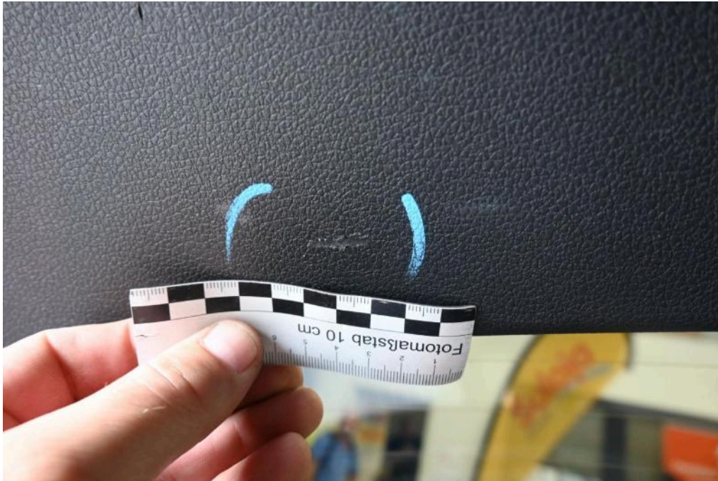
Bild 29 Innenraum Heckklappenverkleidung innen verkratzt
