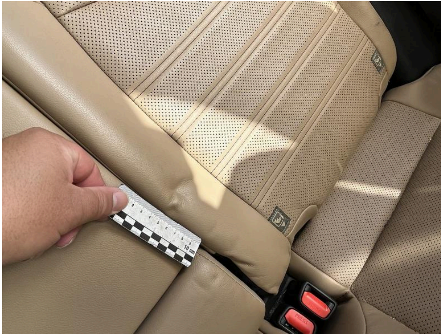
Bild 53 Innenraum Rücksitzbezug hinten links Abdruckspuren verformt
