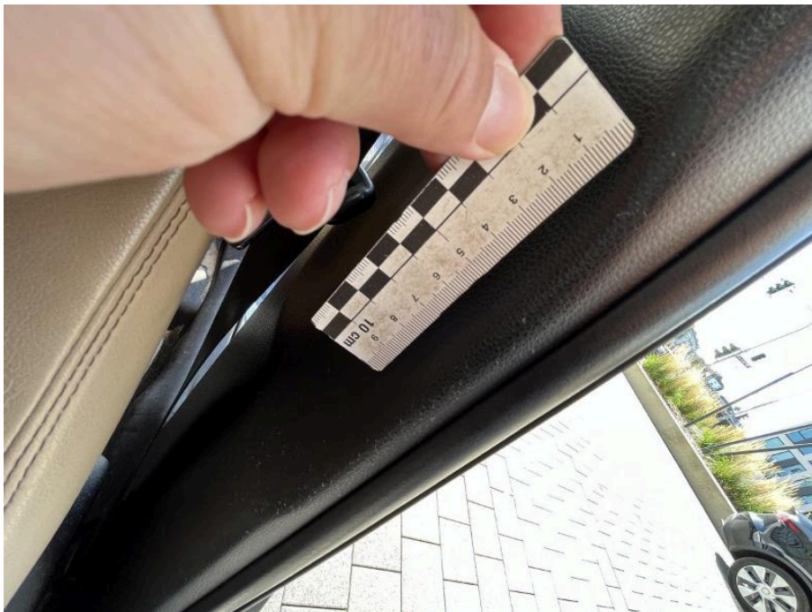
Bild 130 linke Seite Verkleidung B-Säule unten leicht verschürft
