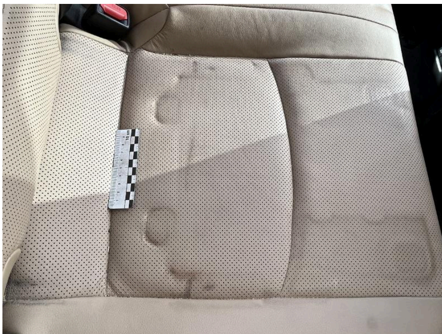
Bild 48 Innenraum Rücksitzbank Bezug Sitzpolster hinten rechts, Mitte und links Abdruckspuren
