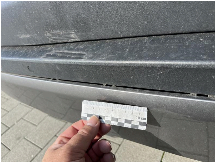
Bild 82 Fahrzeugheck Spoiler Stoßfänger hinten verschoben, erneuern - Kostenerweiterung möglich
