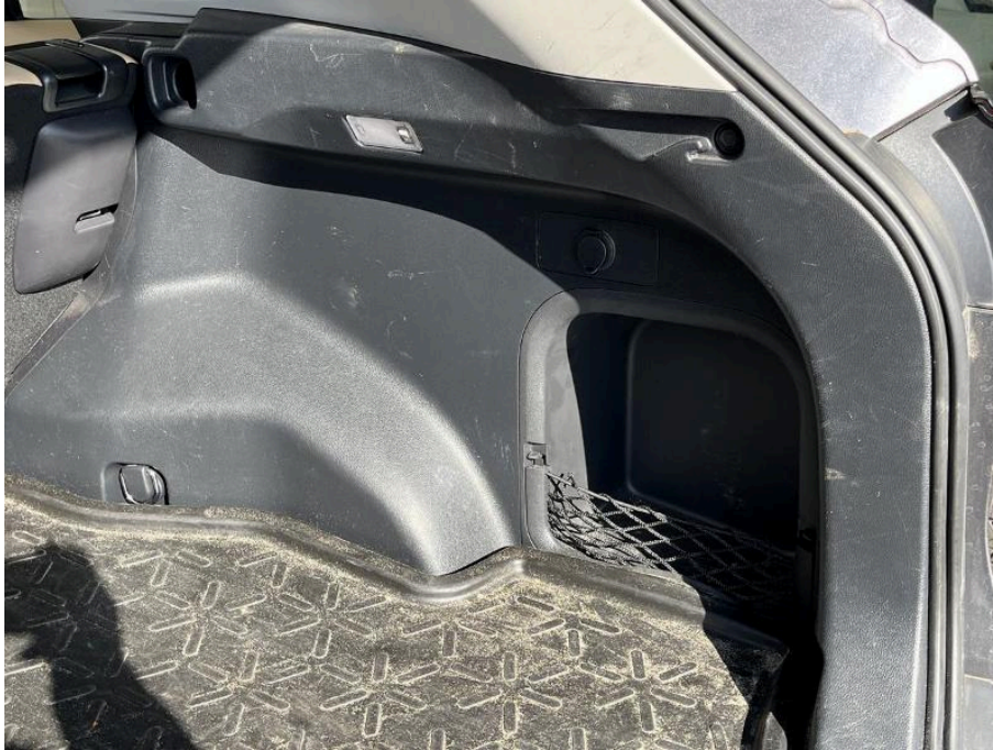
Bild 93 rechte Seite Verkleidung Kofferraum hinten rechts zerkratzt
