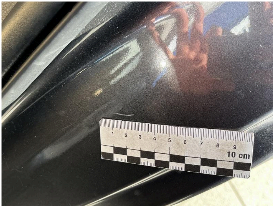
Bild 122 linke Seite Einstieg hinten links Lackschaden und mehrere Dellen
