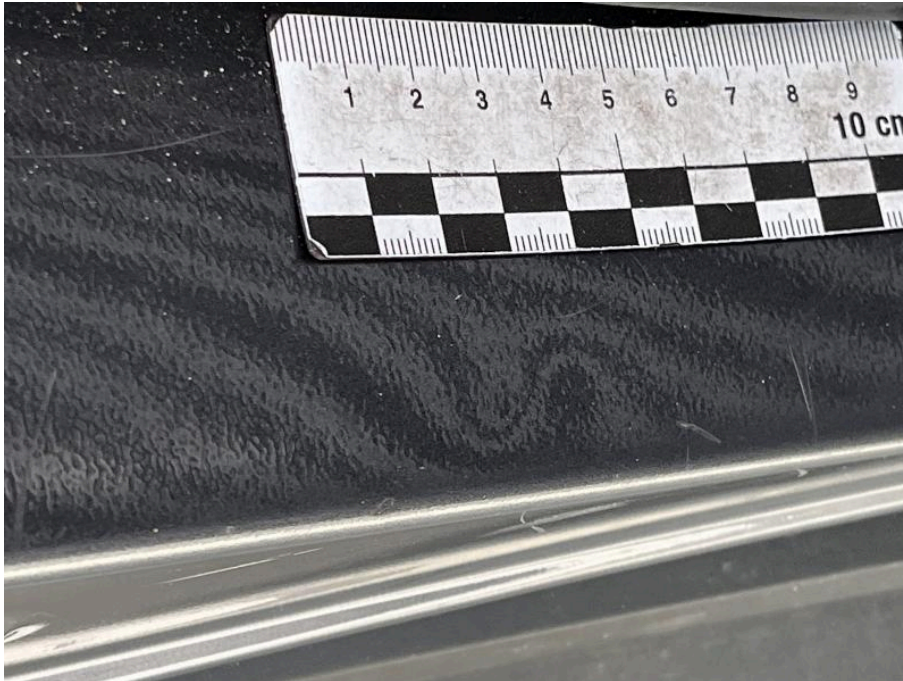
Bild 73 rechte Seite Türschweller rechts zerkratzt und Delle
