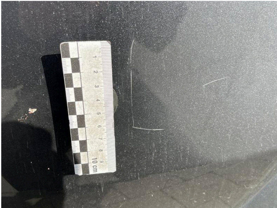
Bild 114 Fahrzeugheck Stoßfänger hinten zerkratzt
