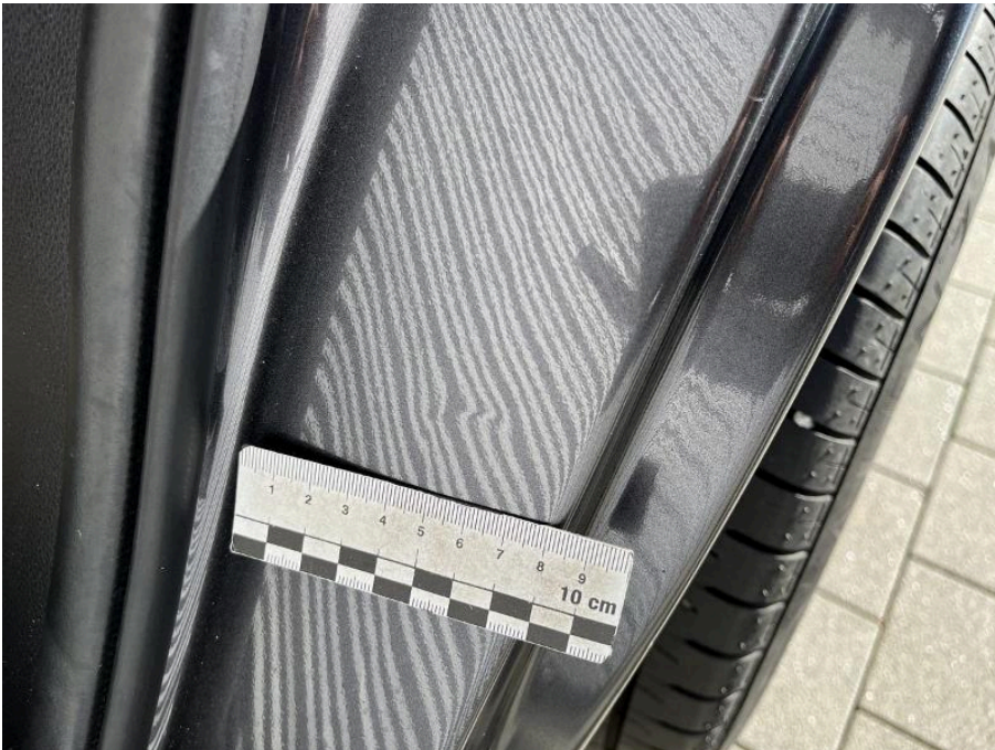
Bild 118 linke Seite Einstieg hinten links Lackschaden und mehrere Dellen
