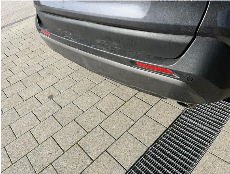
Bild 79 Fahrzeugheck Heckklappe Verkleidung Außenseite verformt
