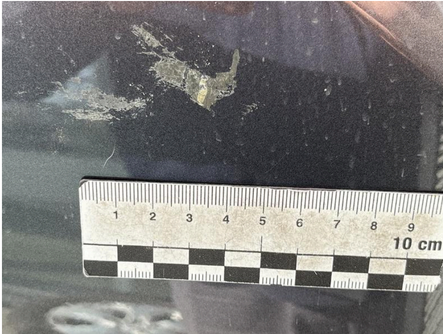
Bild 75 rechte Seite Seitenwand hinten rechts Klebereste entfernen
