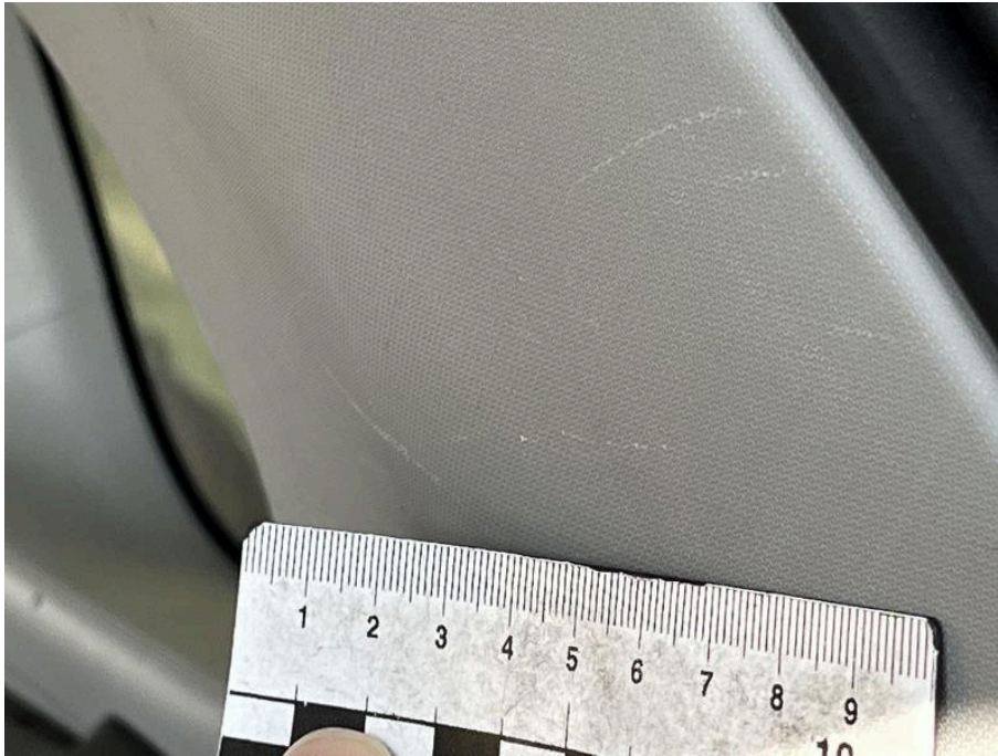
Bild 91 Innenraum D-Säulenverkleidung rechts oben zerkratzt
