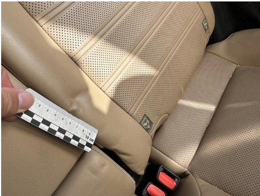
Bild 52 Innenraum Rücksitzbezug hinten links Abdruckspuren verformt, Innenraum Rücksitzbezug hinten rechts Abdruckspuren verformt
