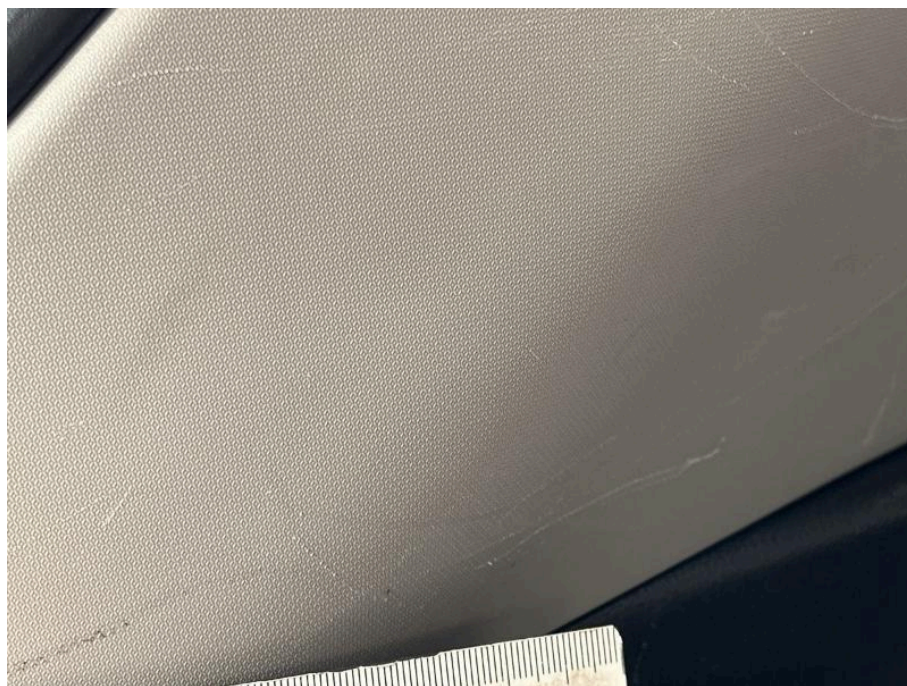
Bild 98 Innenraum D-Säulenverkleidung links oben zerkratzt
