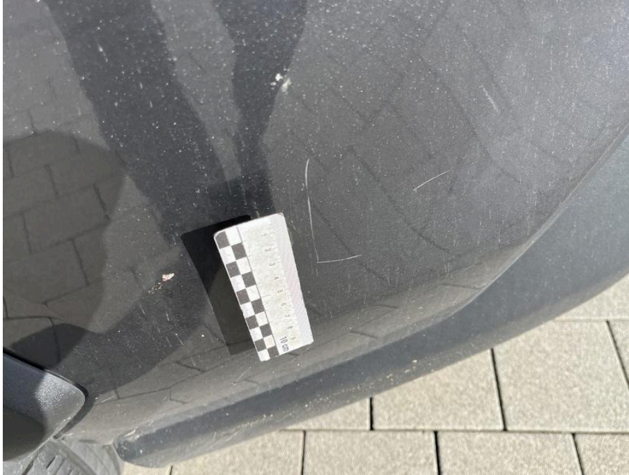
Bild 113 Fahrzeugheck Stoßfänger hinten zerkratzt
