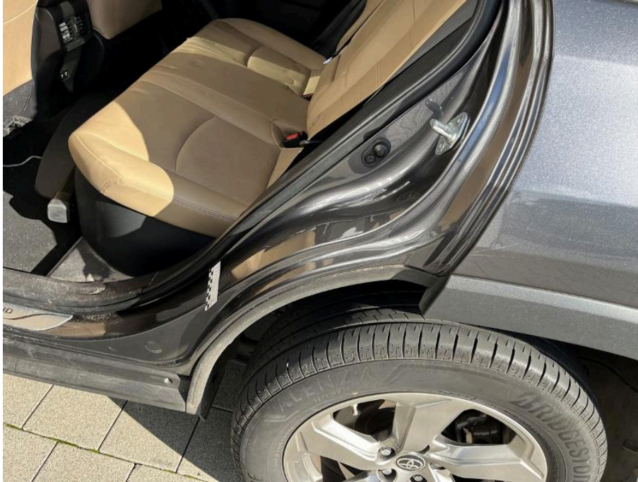
Bild 115 linke Seite Einstieg hinten links Lackschaden und mehrere Dellen
