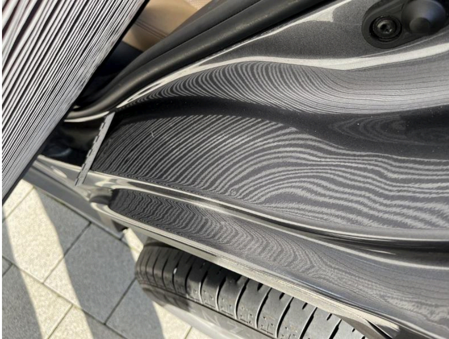
Bild 119 linke Seite Einstieg hinten links Lackschaden und mehrere Dellen
