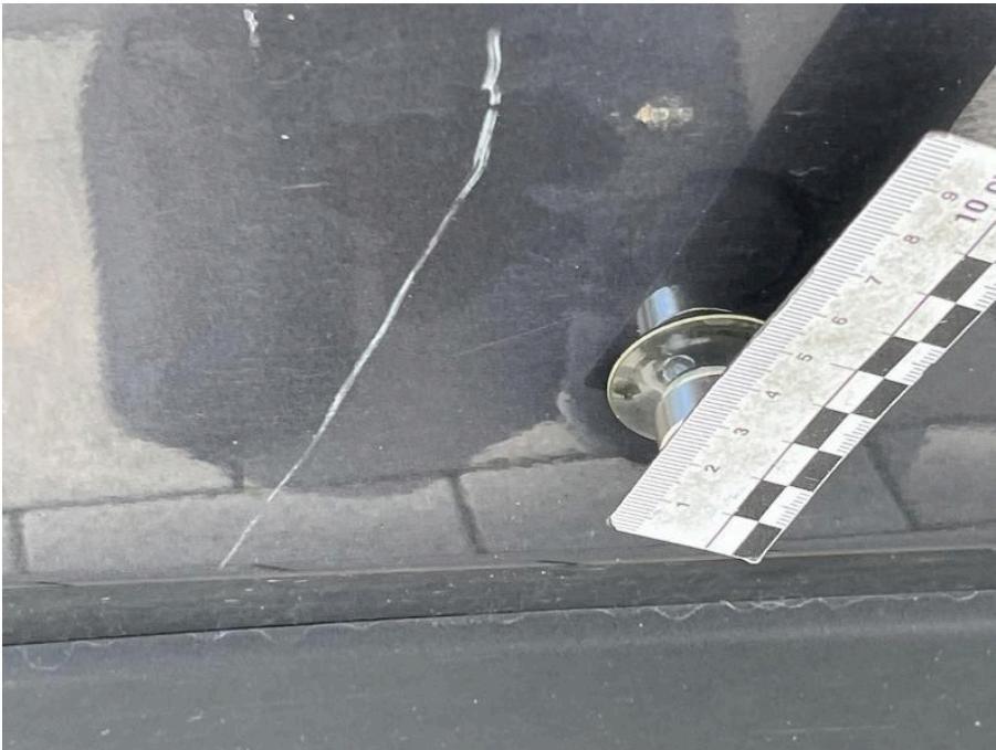
Bild 60 rechte Seite Tür hinten rechts zerkratzt und 2 Dellen
