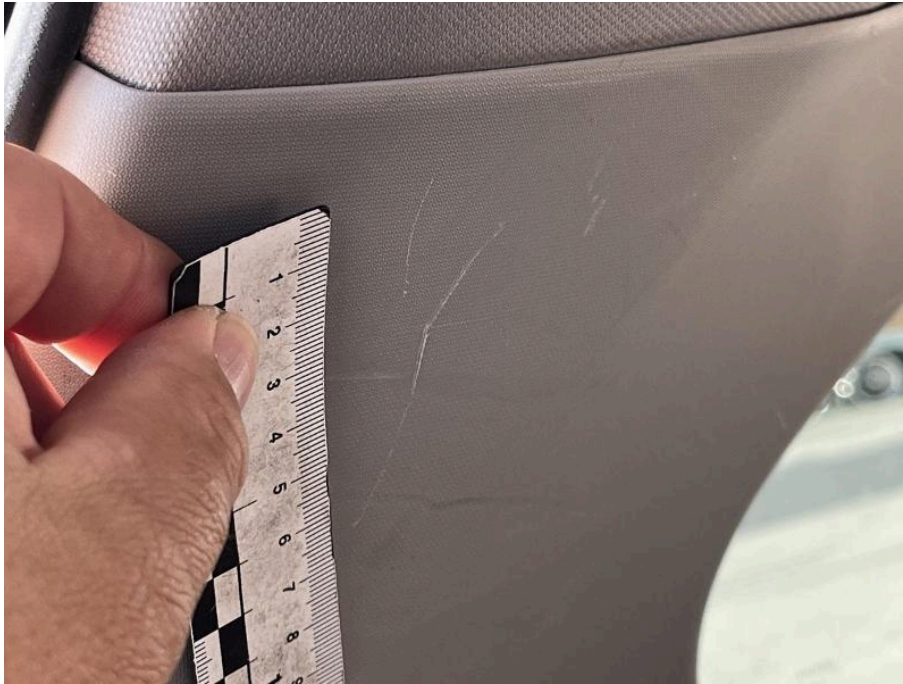
Bild 99 Innenraum D-Säulenverkleidung links oben zerkratzt
