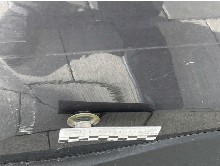
Bild 66 rechte Seite Tür hinten rechts zerkratzt und 2 Dellen
