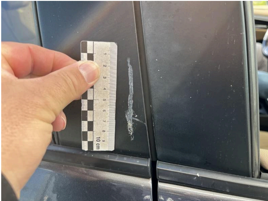
Bild 68 rechte Seite Blende Tür hinten rechts oben Klebereste entfernen
