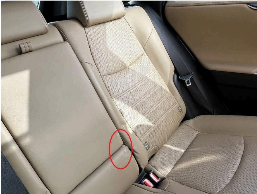
Bild 51 Innenraum Rücksitzbank Bezug Armlehne hinten Mitte Abdruckspuren
