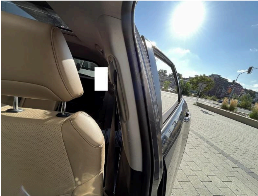
Bild 125 linke Seite Verkleidung B-Säule oben leicht verschürft
