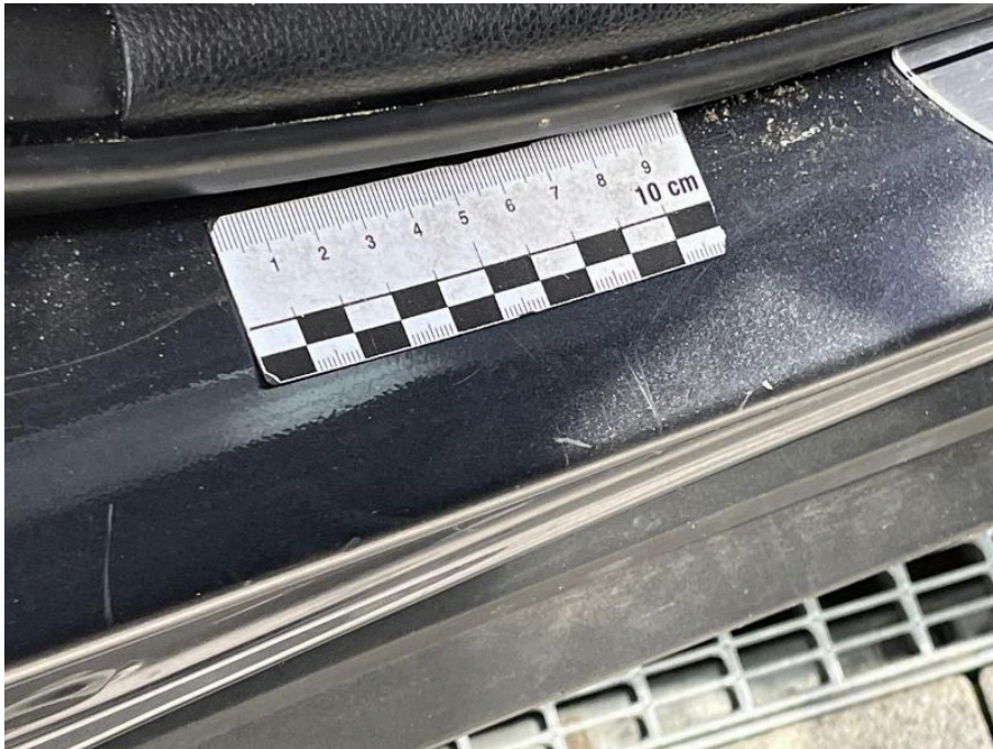
Bild 72 rechte Seite Türschweller rechts zerkratzt und Delle
