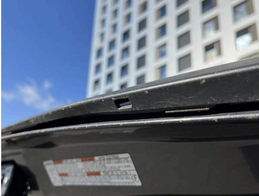
Bild 107 Fahrzeugheck Heckklappe Verkleidung Außenseite verformt
