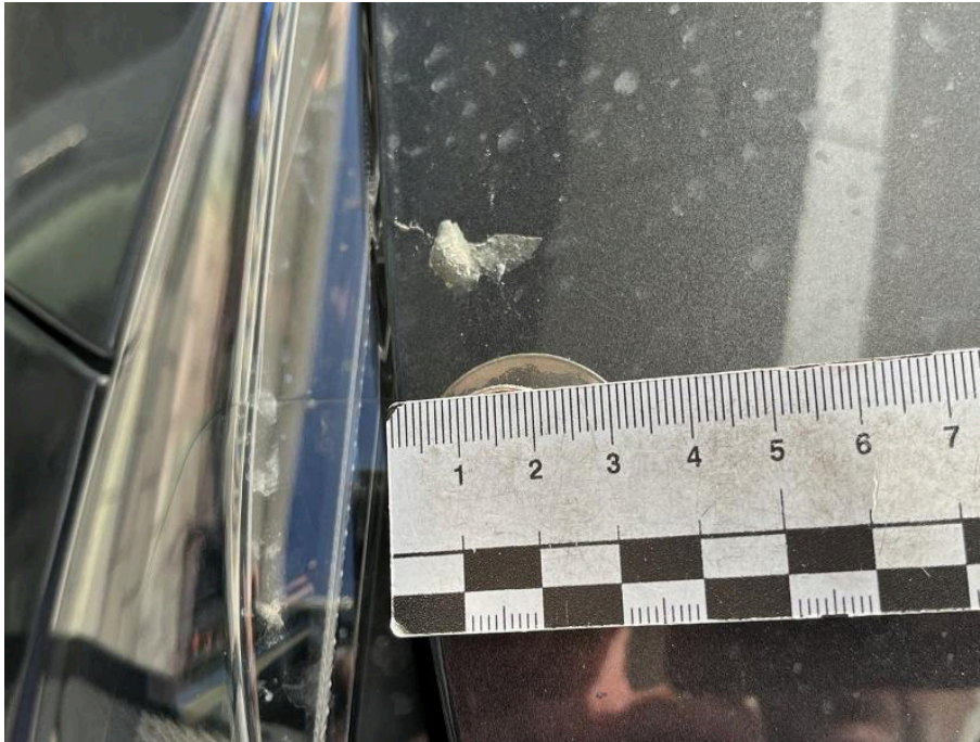
Bild 23 Fahrzeugfront Motorhaube Klebereste entfernen
