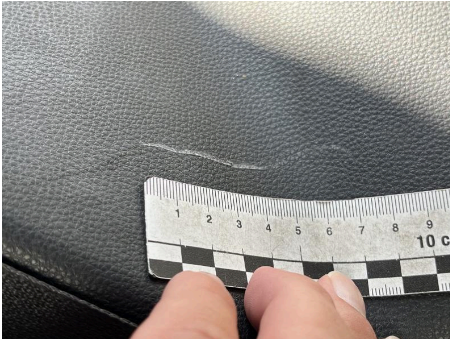
Bild 33 rechte Seite Verkleidung C-Säule rechts unten verkratzt
