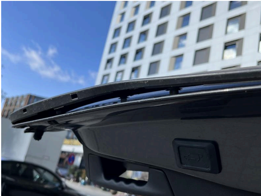
Bild 108 Fahrzeugheck Heckklappe Verkleidung Außenseite verformt
