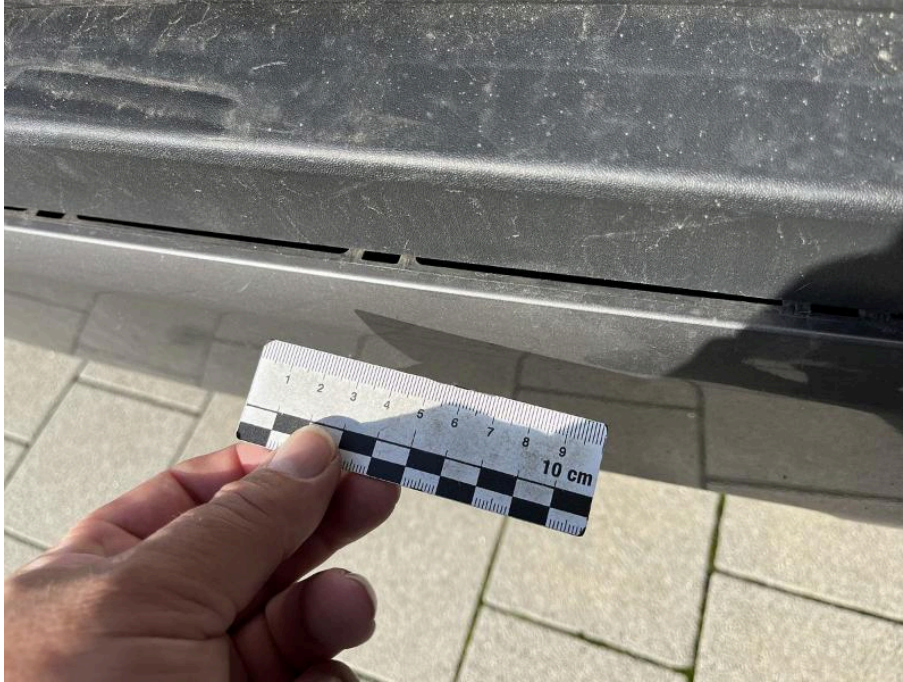
Bild 81 Fahrzeugheck Spoiler Stoßfänger hinten verschoben, erneuern - Kostenerweiterung möglich
