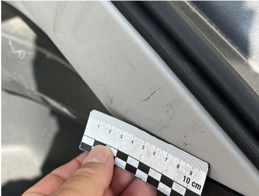
Bild 89 Innenraum D-Säulenverkleidung rechts oben zerkratzt
