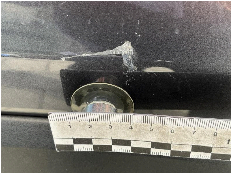
Bild 28 rechte Seite Kotflügel vorne rechts Klebereste entfernen
