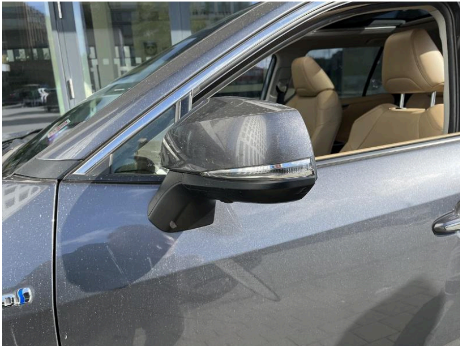
Bild 134 linke Seite Außenspiegelgehäuse links leicht verkratzt
