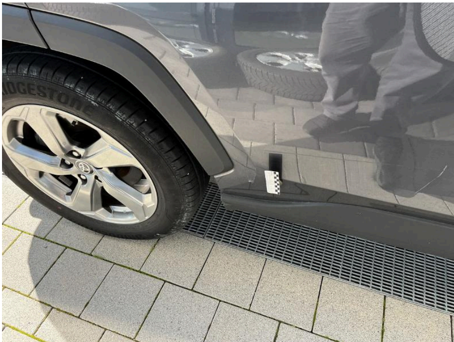
Bild 64 rechte Seite Tür hinten rechts zerkratzt und 2 Dellen
