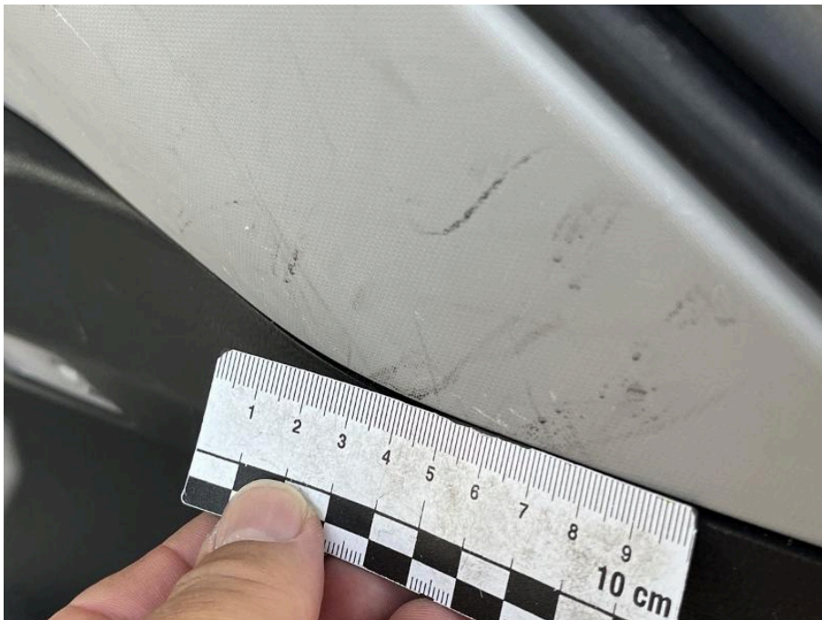
Bild 90 Innenraum D-Säulenverkleidung rechts oben zerkratzt
