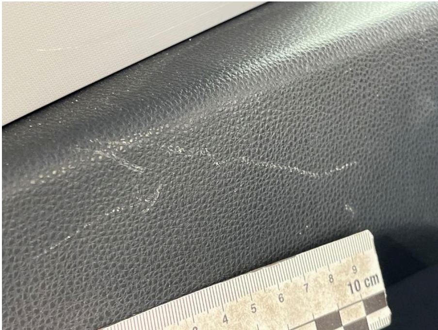
Bild 104 linke Seite Verkleidung Kofferraum links leicht verkratzt
