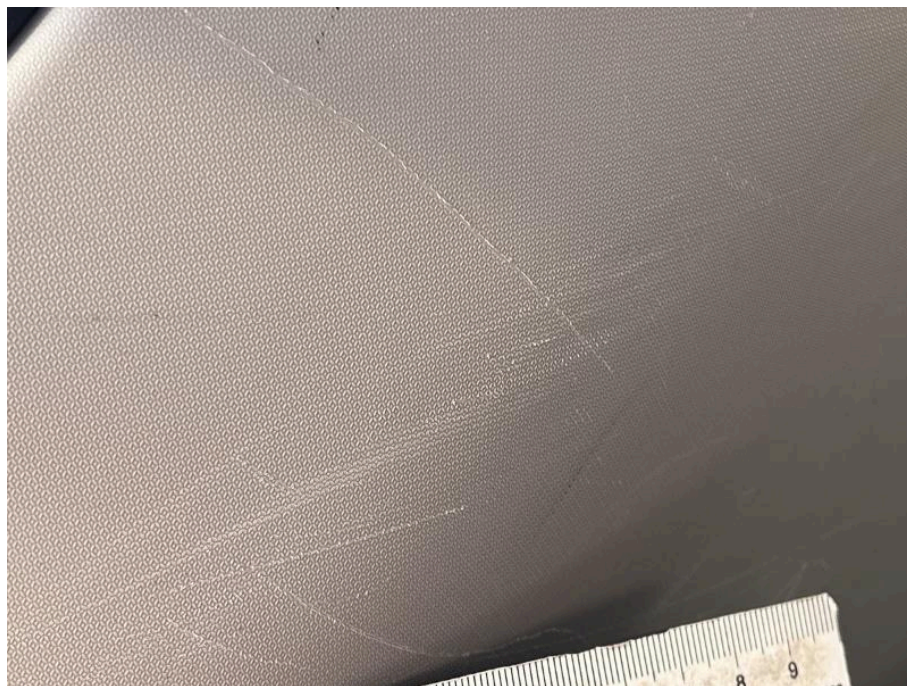
Bild 97 Innenraum D-Säulenverkleidung links oben zerkratzt
