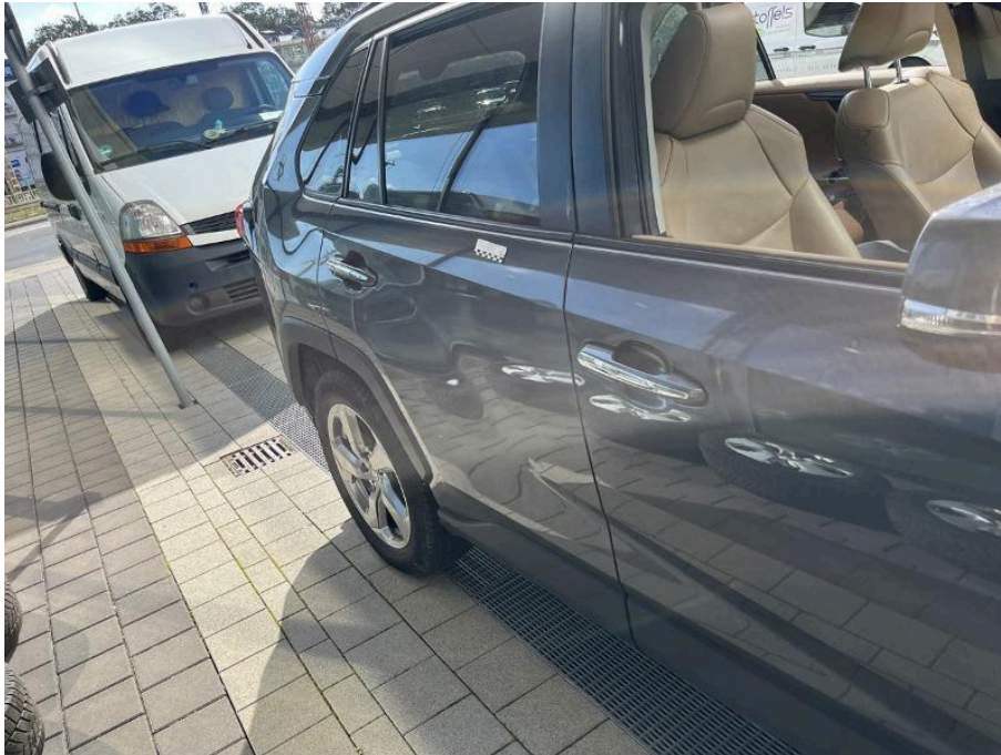
Bild 29 rechte Seite Tür hinten rechts zerkratzt und 2 Dellen
