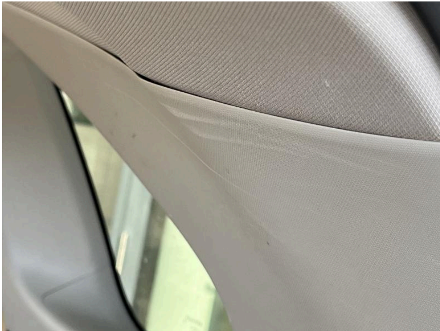
Bild 92 Innenraum D-Säulenverkleidung rechts oben zerkratzt
