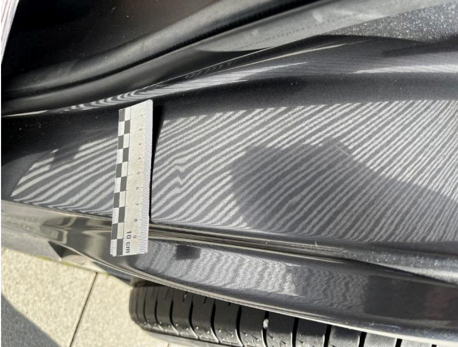
Bild 117 linke Seite Einstieg hinten links Lackschaden und mehrere Dellen
