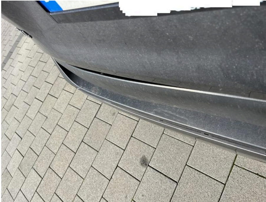
Bild 77 Fahrzeugheck Heckklappe Verkleidung Außenseite verformt
