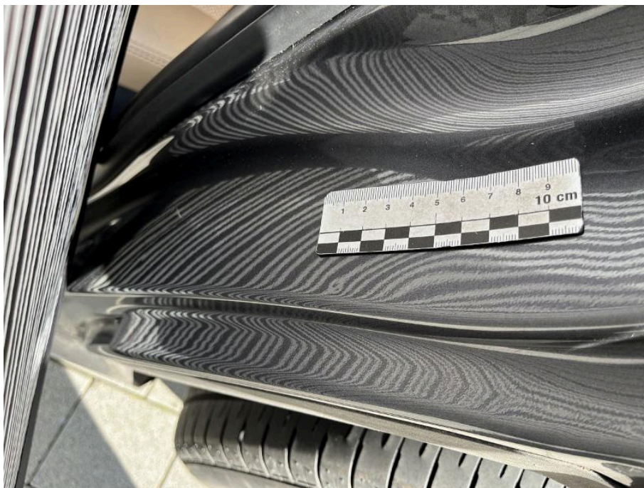
Bild 121 linke Seite Einstieg hinten links Lackschaden und mehrere Dellen
