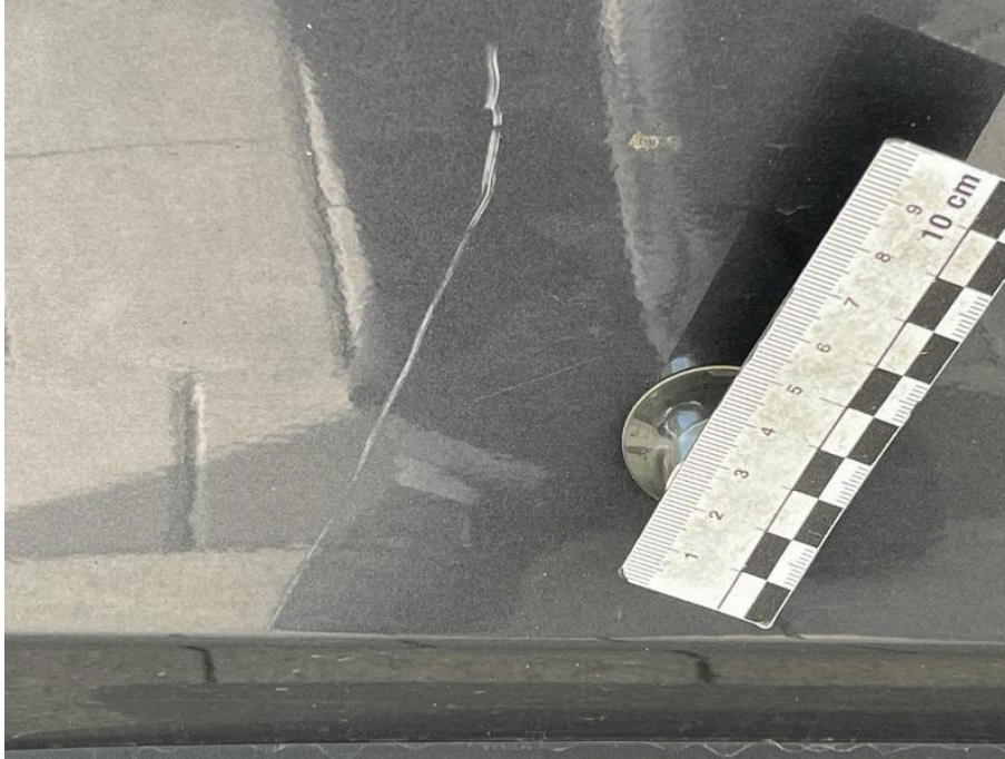
Bild 61 rechte Seite Tür hinten rechts zerkratzt und 2 Dellen
