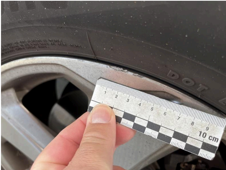
Bild 26 Vorderachse Felge vorne rechts Sommerradsatz Felge vorne rechts verschürt
