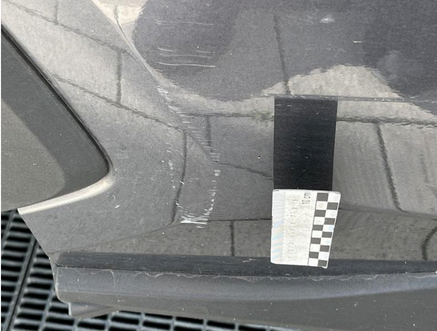
Bild 65 rechte Seite Tür hinten rechts zerkratzt und 2 Dellen
