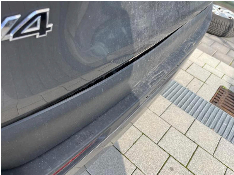
Bild 78 Fahrzeugheck Heckklappe Verkleidung Außenseite verformt
