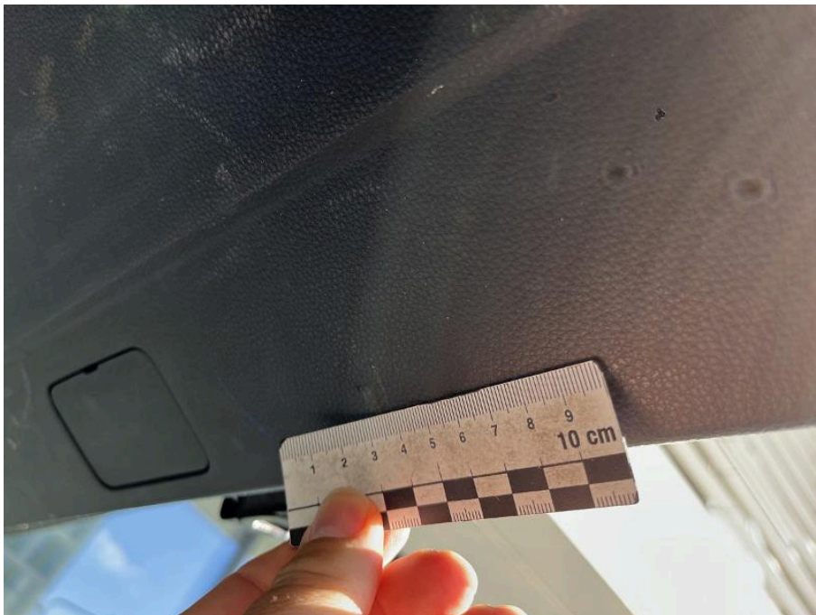
Bild 86 Innenraum Verkleidung Heckklappe Innenseite Kratzer
