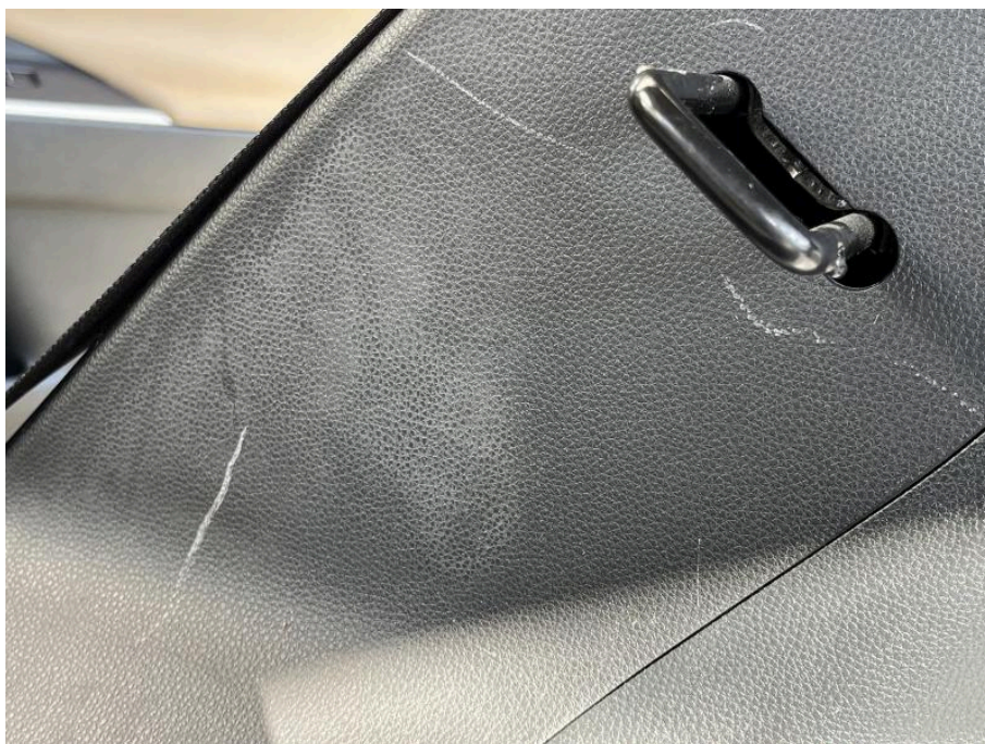
Bild 32 rechte Seite Verkleidung C-Säule rechts unten verkratzt
