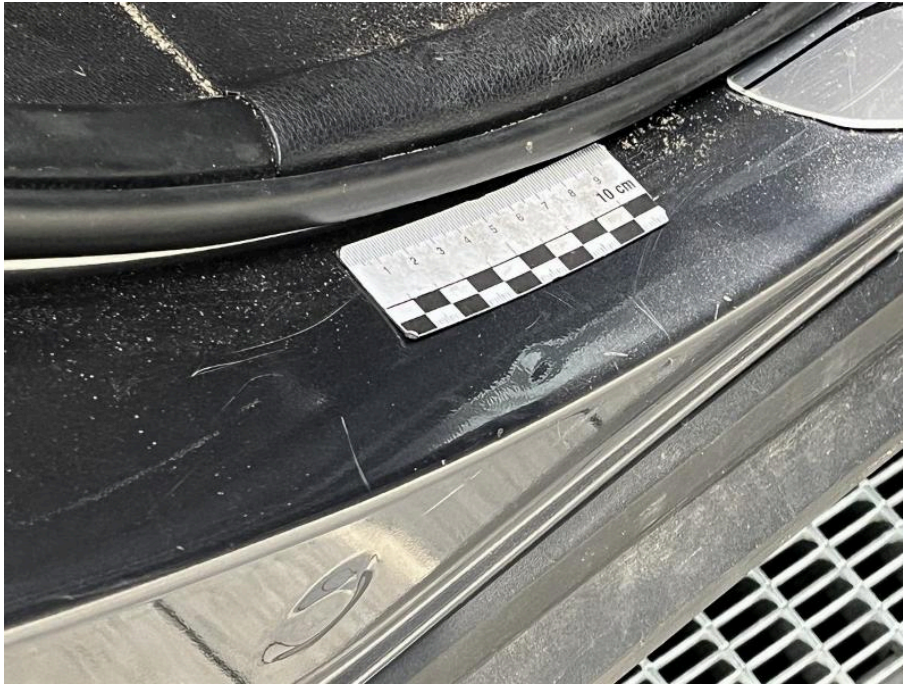
Bild 71 rechte Seite Türschweller rechts zerkratzt und Delle
