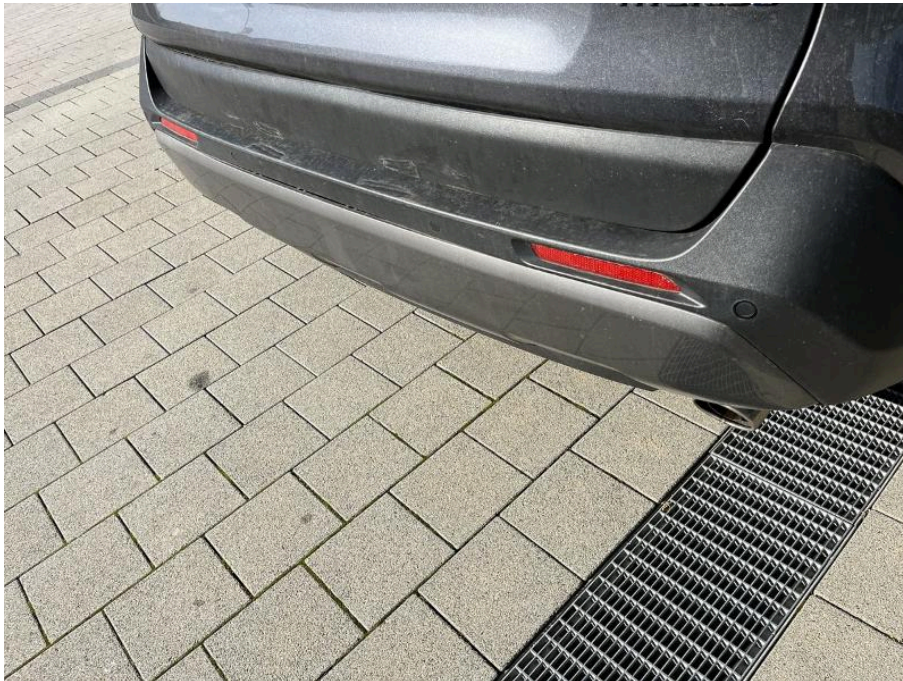
Bild 80 Fahrzeugheck Spoiler Stoßfänger hinten verschoben, erneuern - Kostenerweiterung möglich
