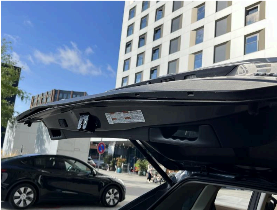
Bild 105 Fahrzeugheck Heckklappe Verkleidung Außenseite verformt
