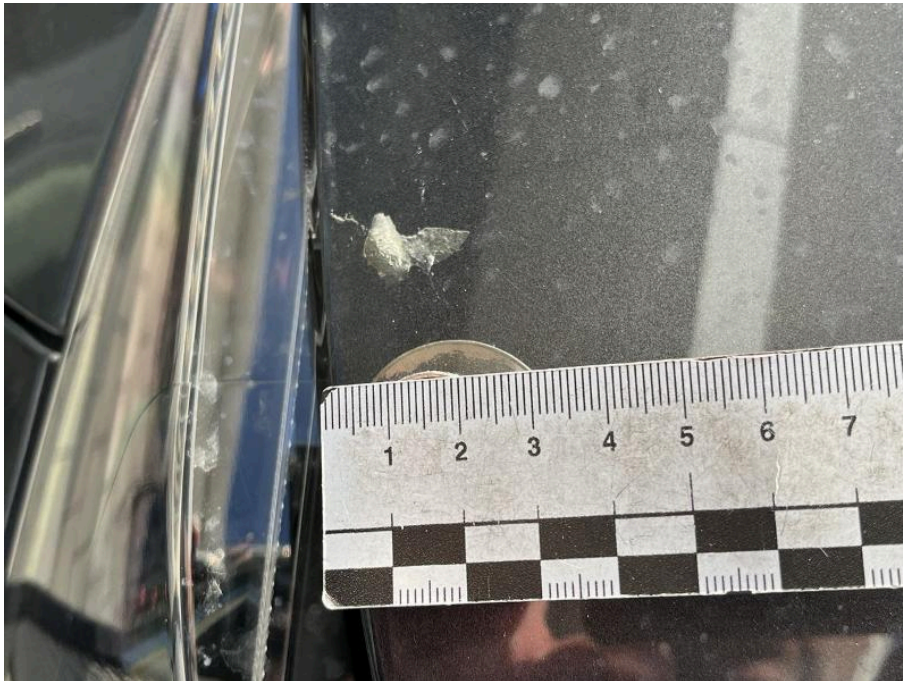
Bild 24 Fahrzeugfront Motorhaube Klebereste entfernen
