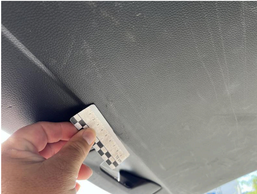
Bild 84 Innenraum Verkleidung Heckklappe Innenseite Kratzer
