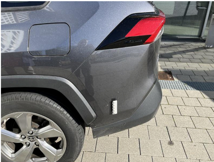
Bild 112 Fahrzeugheck Stoßfänger hinten zerkratzt
