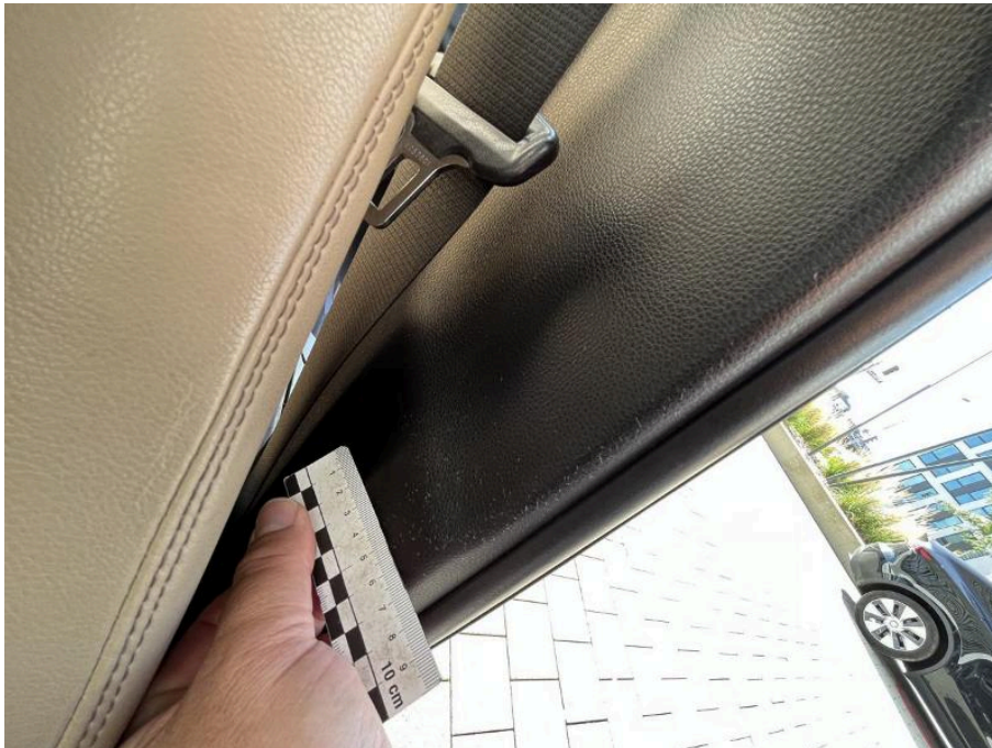
Bild 128 linke Seite Verkleidung B-Säule unten leicht verschürft
