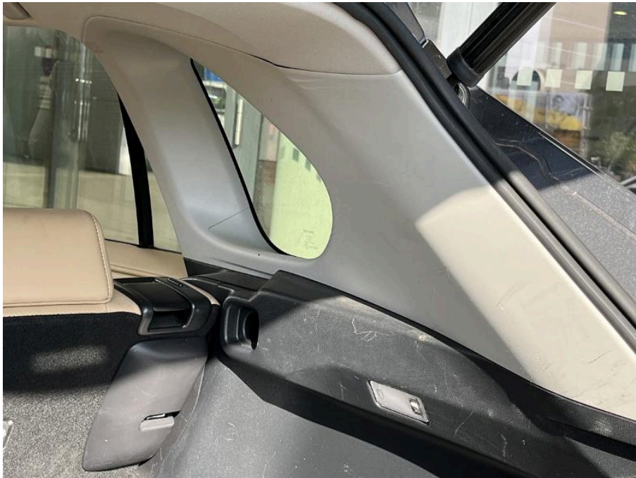
Bild 88 Innenraum D-Säulenverkleidung rechts oben zerkratzt
