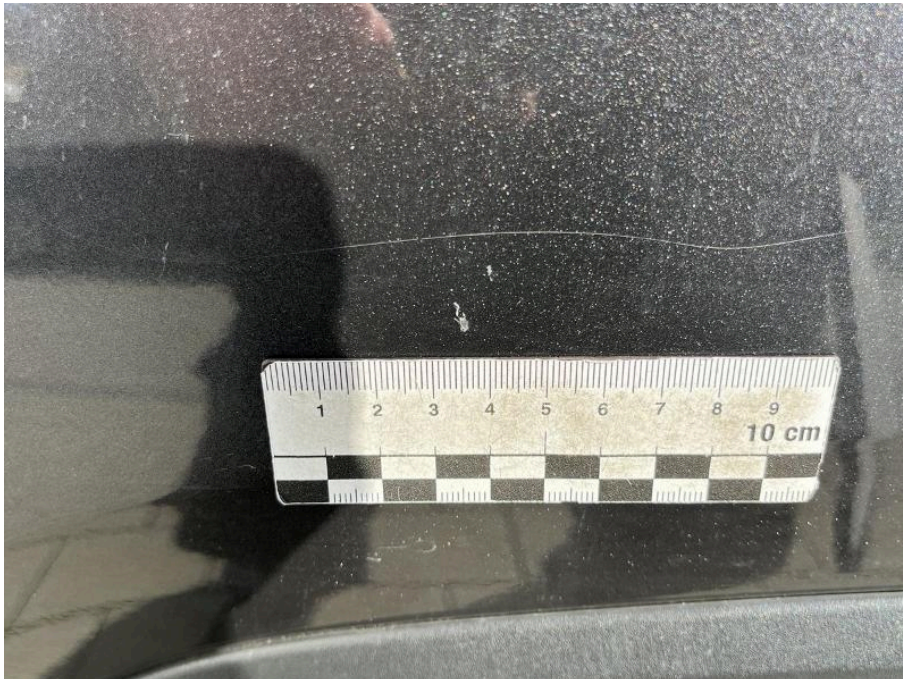
Bild 124 linke Seite Tür hinten links Lackschaden
