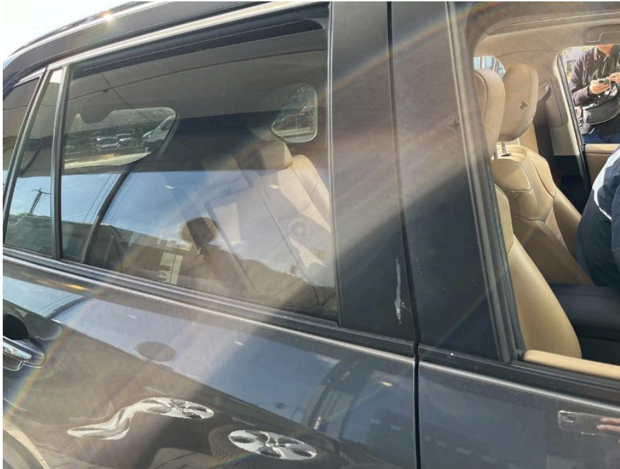
Bild 67 rechte Seite Blende Tür hinten rechts oben Klebereste entfernen
