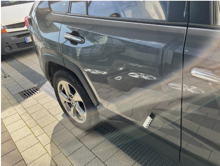
Bild 58 rechte Seite Tür hinten rechts zerkratzt und 2 Dellen
