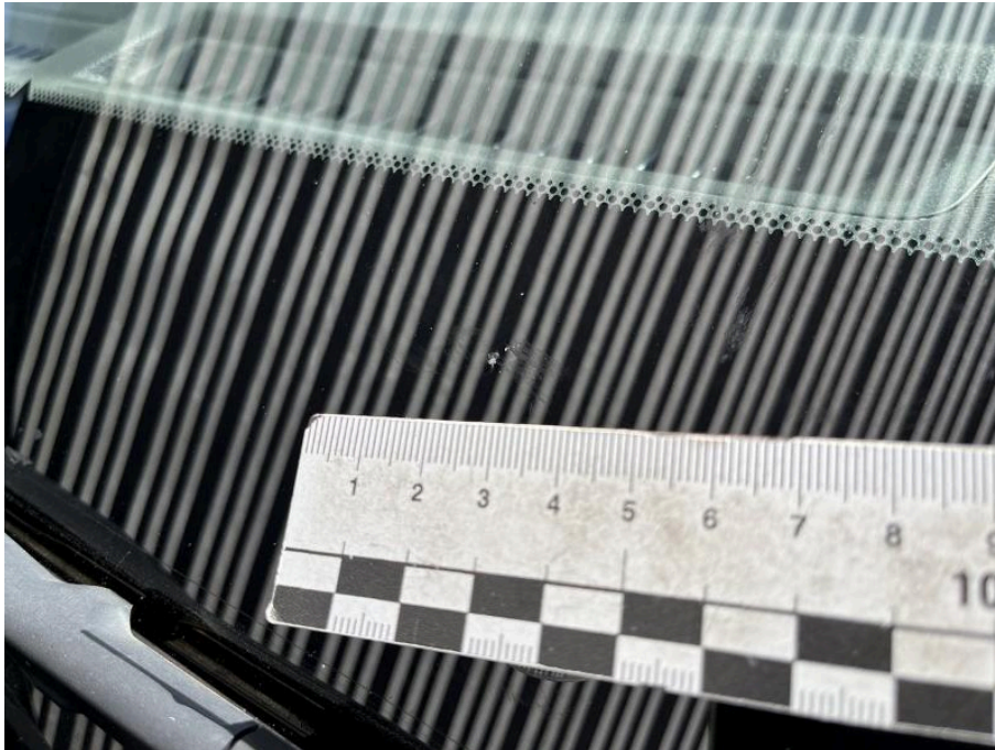
Bild 21 Fahrzeugfront Frontscheibe mit Regensensor Glas gesplittert
