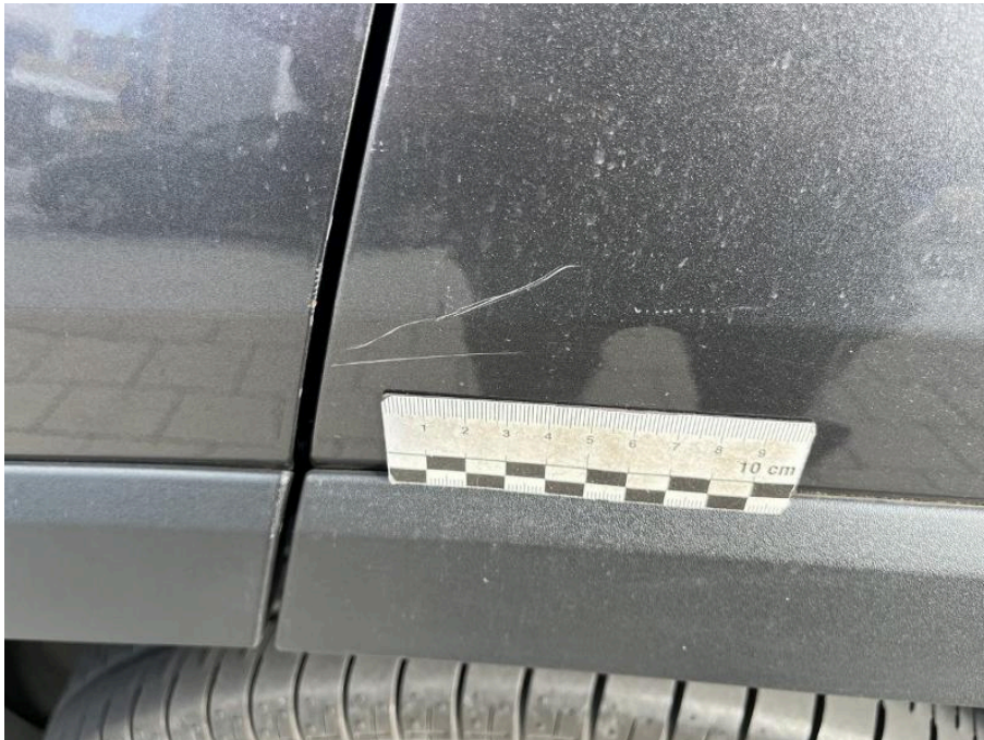
Bild 110 linke Seite Seitenteil hinten links zerkratzt
