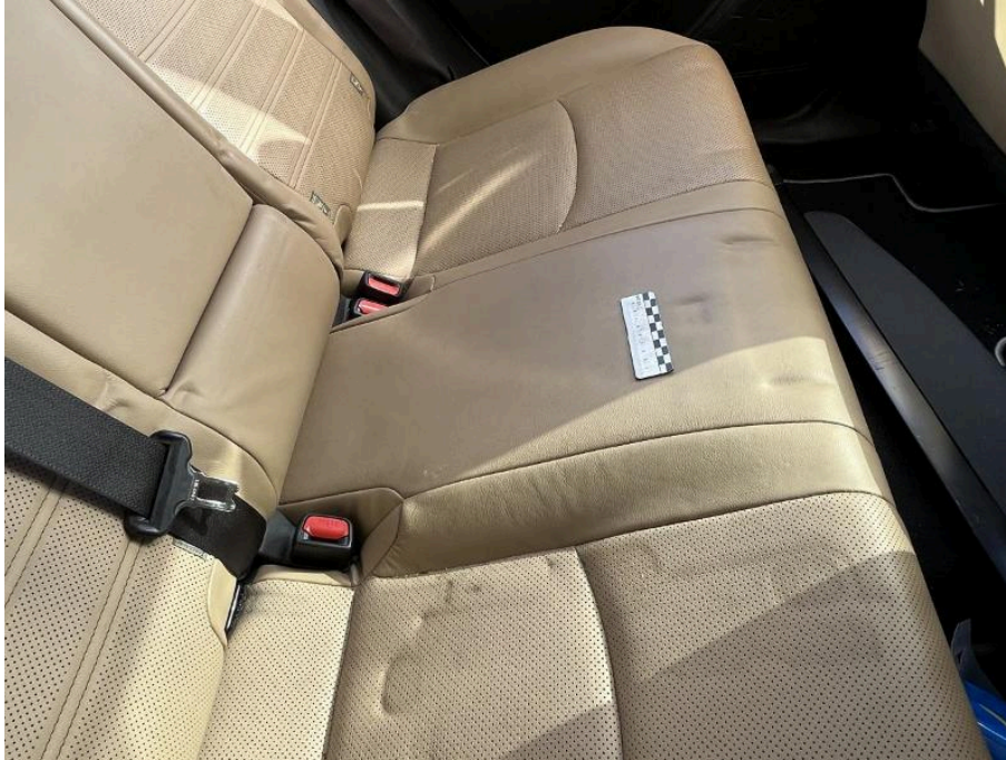
Bild 49 Innenraum Rücksitzbank Bezug Sitzpolster hinten rechts, Mitte und links Abdruckspuren , Innenraum Rücksitzbezug hinten rechts Abdruckspuren verformt
