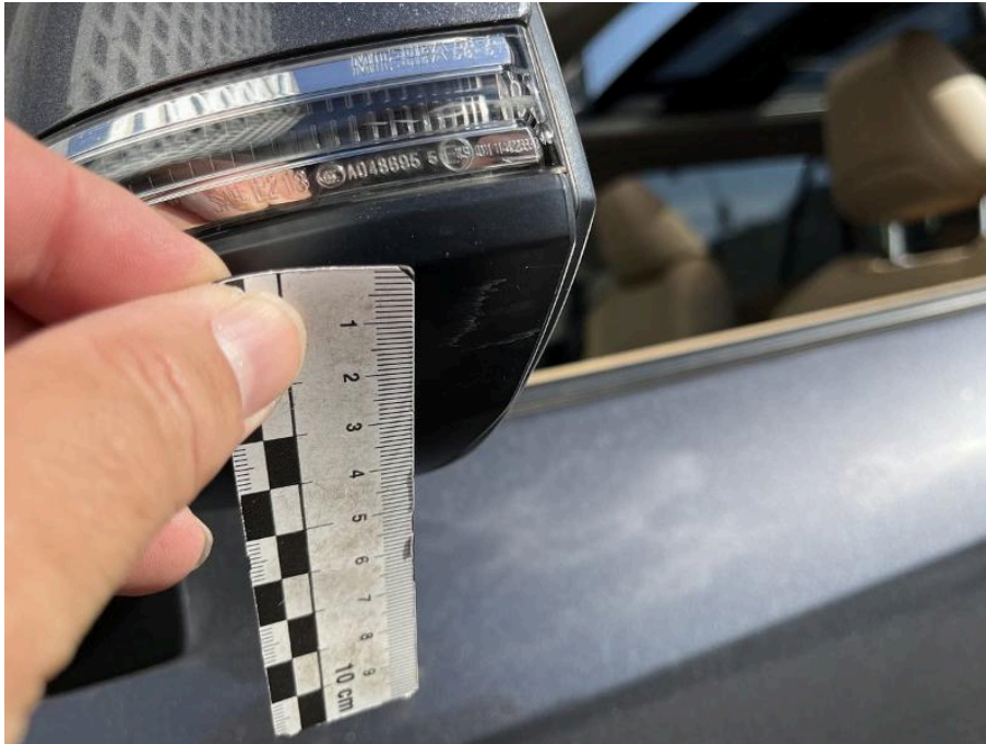
Bild 135 linke Seite Außenspiegelgehäuse links leicht verkratzt
