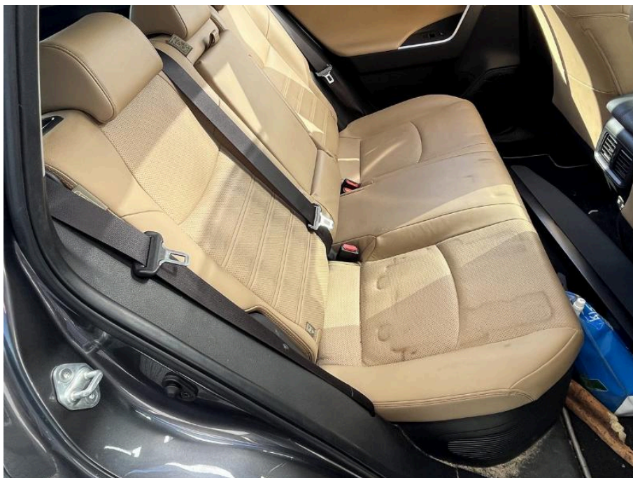
Bild 47 Innenraum Rücksitzbank Bezug Sitzpolster hinten rechts, Mitte und links Abdruckspuren , Innenraum Rücksitzbezug hinten rechts Abdruckspuren verformt
