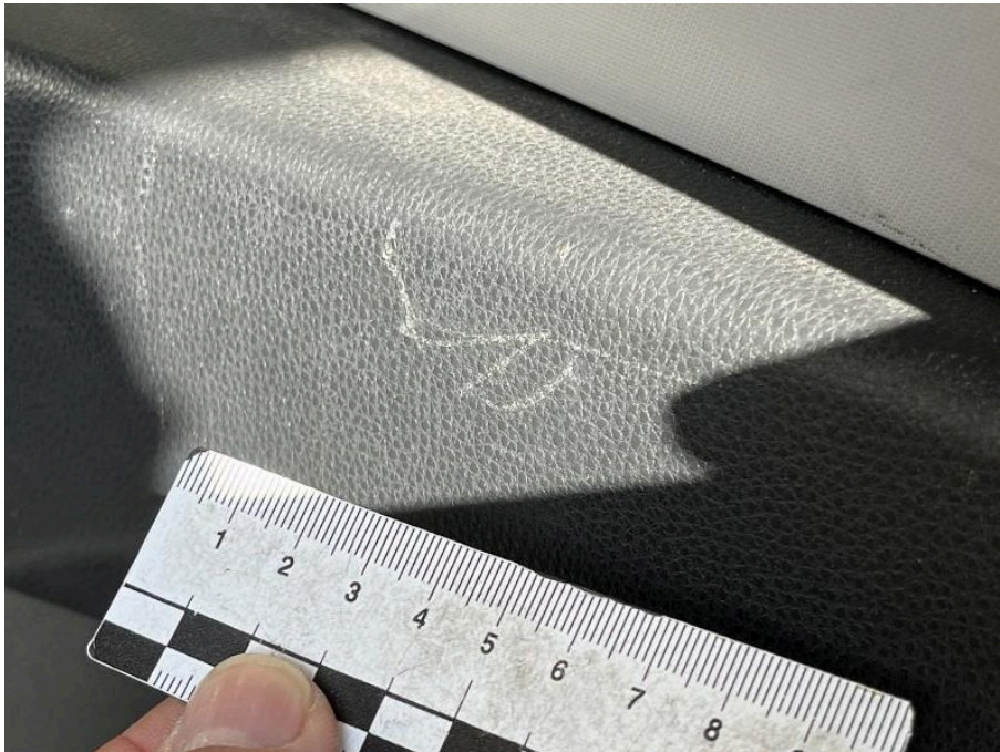
Bild 94 rechte Seite Verkleidung Kofferraum hinten rechts zerkratzt
