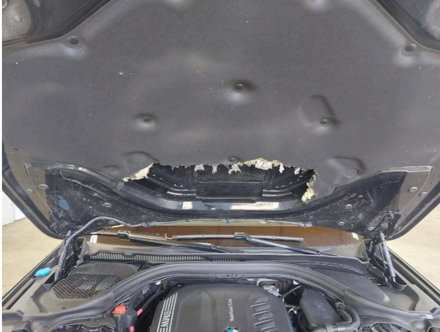
Bild 19 Fahrzeugfront Dämmung Motorhaube gerissen / eingerissen
