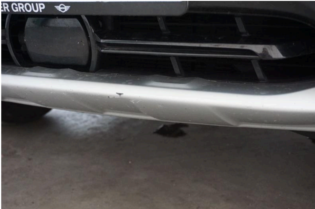
Bild 20 Fahrzeugfront Frontspoiler Kratzer Steinschlag / -schläge
