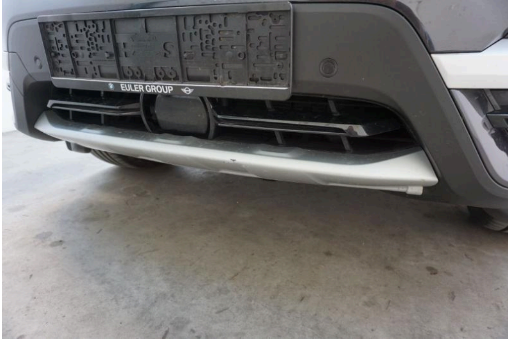
Bild 19 Fahrzeugfront Frontspoiler Kratzer Steinschlag / -schläge
