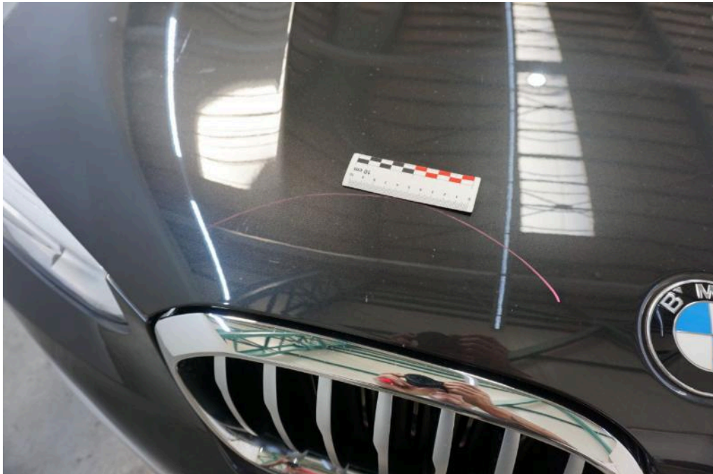
Bild 18 Fahrzeugfront Motorhaube Steinschlag / -schläge
