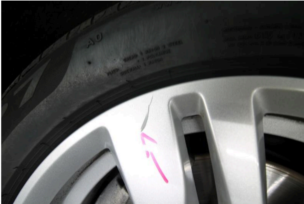
Bild 29 Vorderachse Felge vorne links Bordsteinschaden / Angestoßen / Beschädigung Materialabtrag
