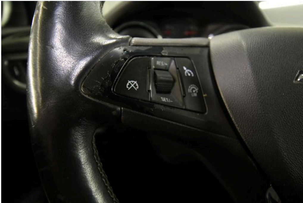
Bild 24 Innenraum Lenkrad Abgegriffen beschädigt abgegriffen
