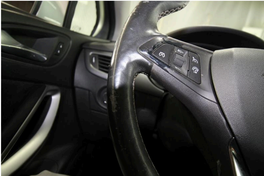
Bild 20 Innenraum Lenkrad Abgegriffen beschädigt abgegriffen
