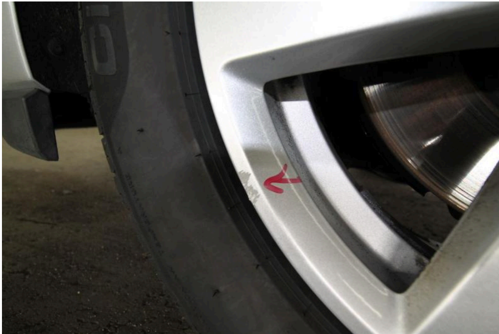
Bild 26 Vorderachse Felge vorne links Bordsteinschaden / Angestoßen / Beschädigung Materialabtrag
