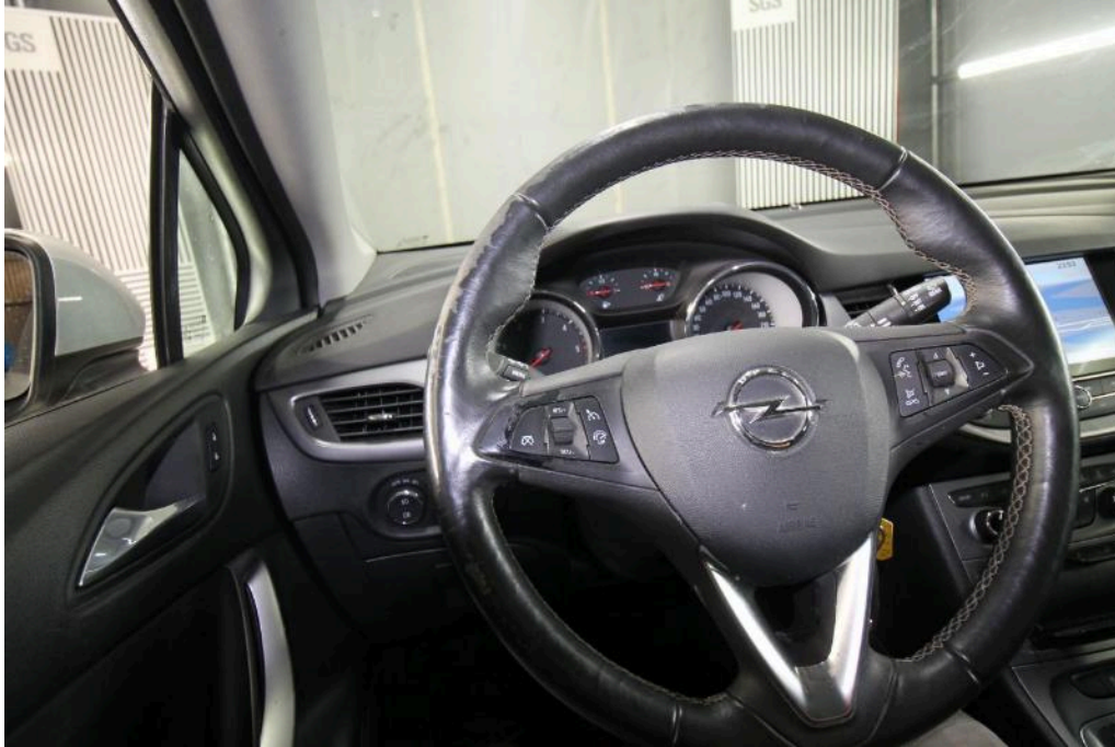
Bild 19 Innenraum Lenkrad Abgegriffen beschädigt abgegriffen
