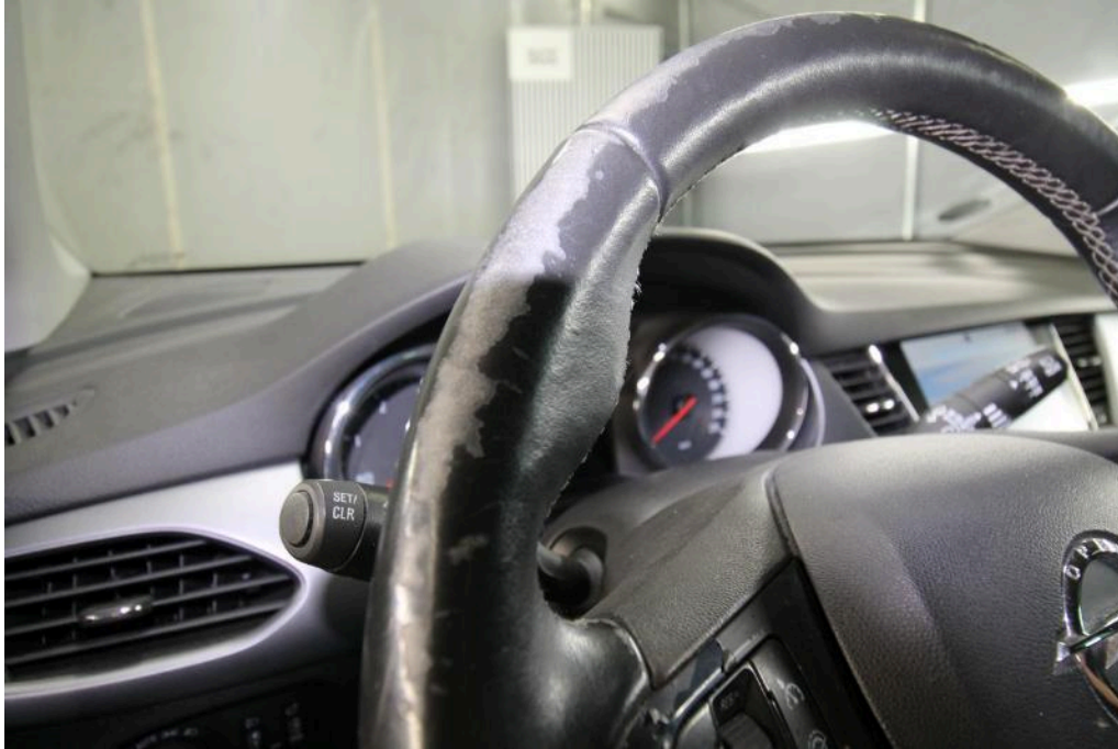
Bild 21 Innenraum Lenkrad Abgegriffen beschädigt abgegriffen
