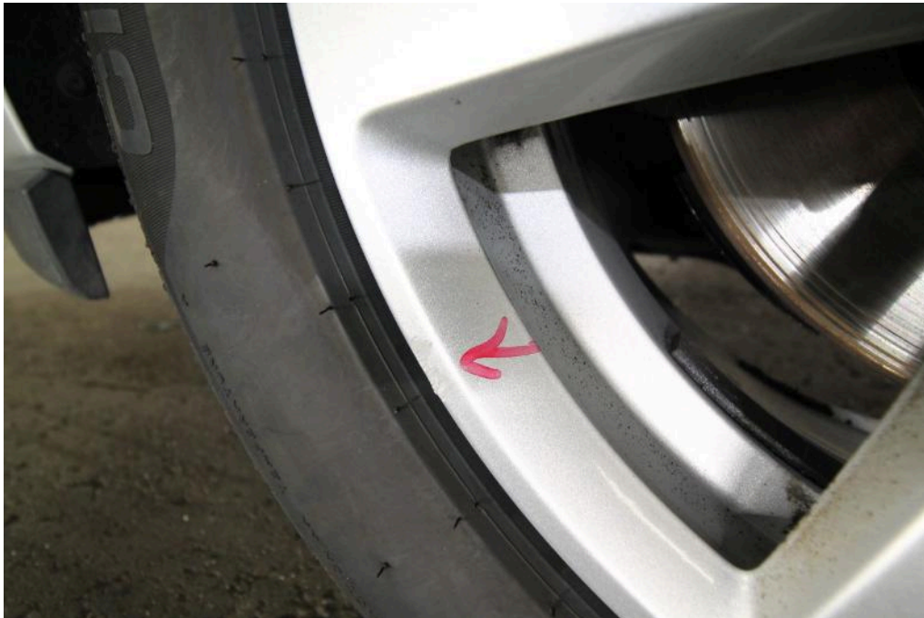
Bild 28 Vorderachse Felge vorne links Bordsteinschaden / Angestoßen / Beschädigung Materialabtrag
