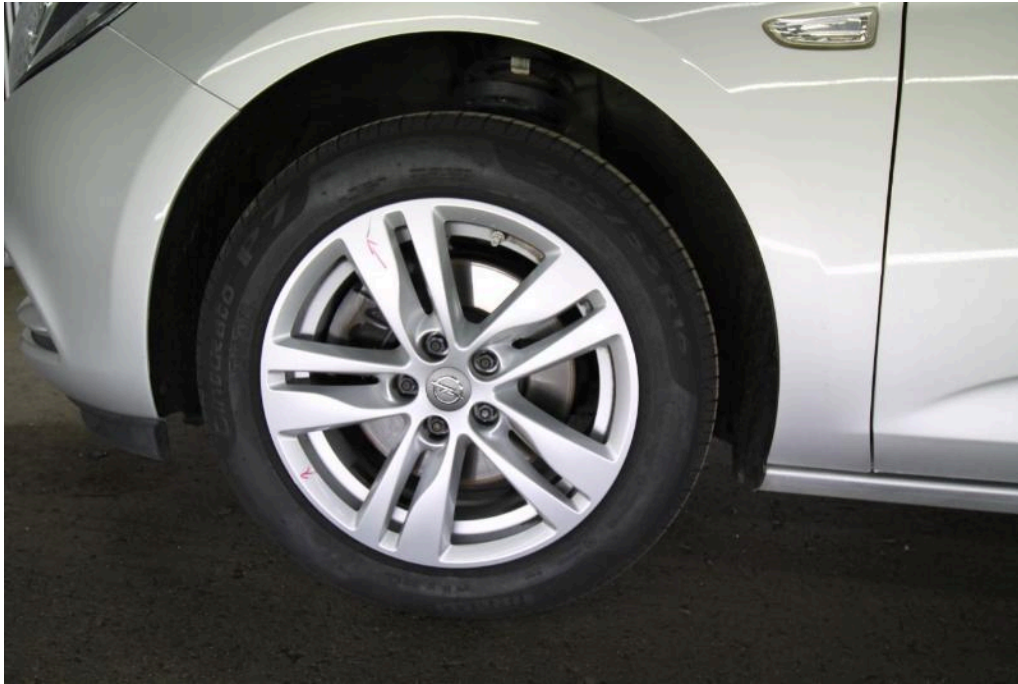
Bild 25 Vorderachse Felge vorne links Bordsteinschaden / Angestoßen / Beschädigung Materialabtrag
