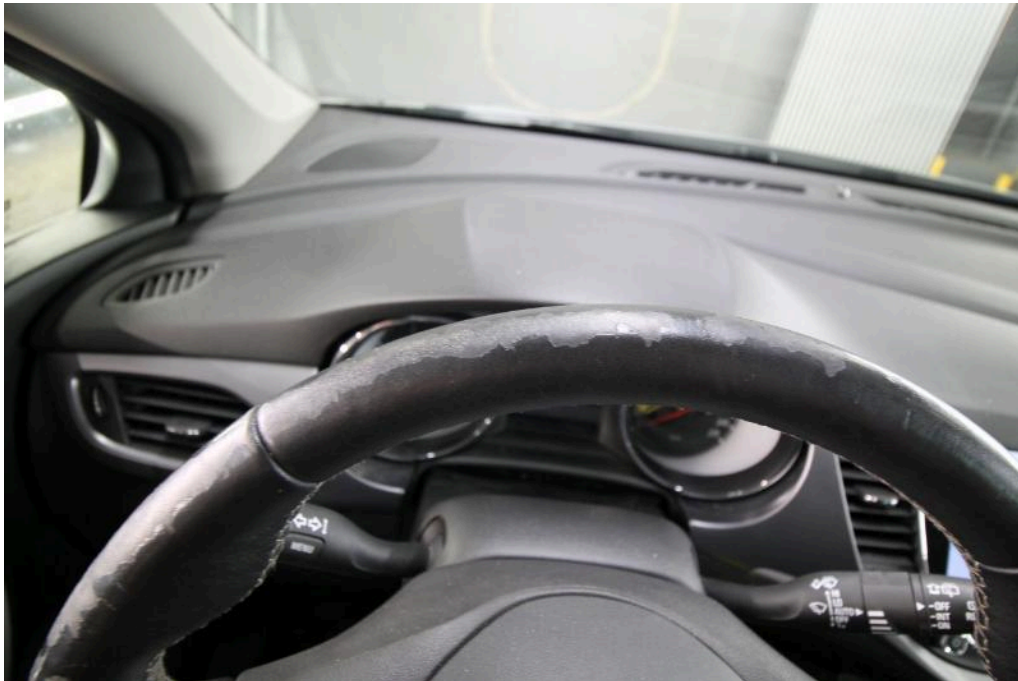
Bild 22 Innenraum Lenkrad Abgegriffen beschädigt abgegriffen
