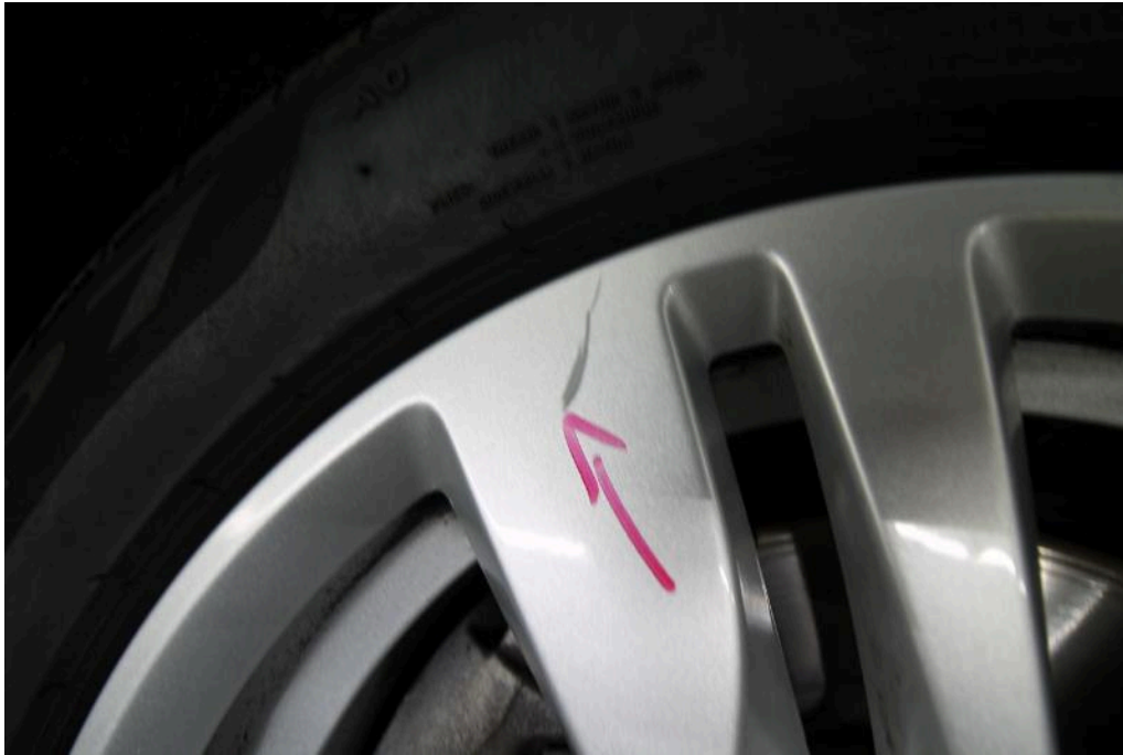
Bild 27 Vorderachse Felge vorne links Bordsteinschaden / Angestoßen / Beschädigung Materialabtrag
