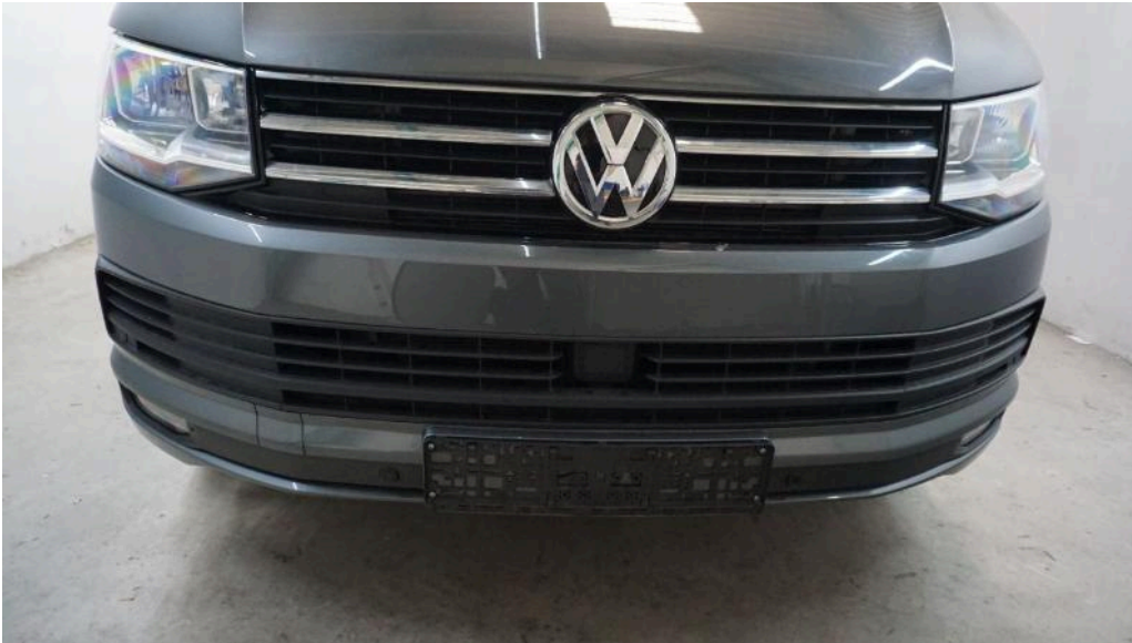
Bild 17 Fahrzeugfront Stoßfänger vorne Steinschlag / -schläge
