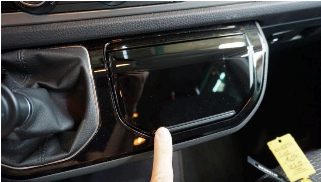
Bild 28 Innenraum Mittelkonsole vorne Der Deckel bleibt nicht geschlossen
