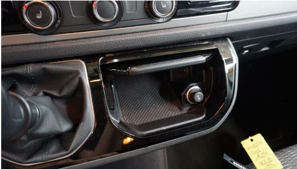
Bild 29 Innenraum Mittelkonsole vorne Der Deckel bleibt nicht geschlossen
