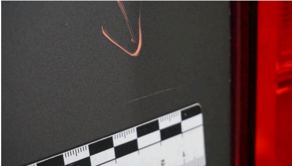
Bild 21 linke Seite Seitenwand hinten links Kratzer
