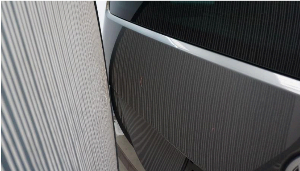
Bild 23 Fahrzeugheck Heckklappe Dellen
