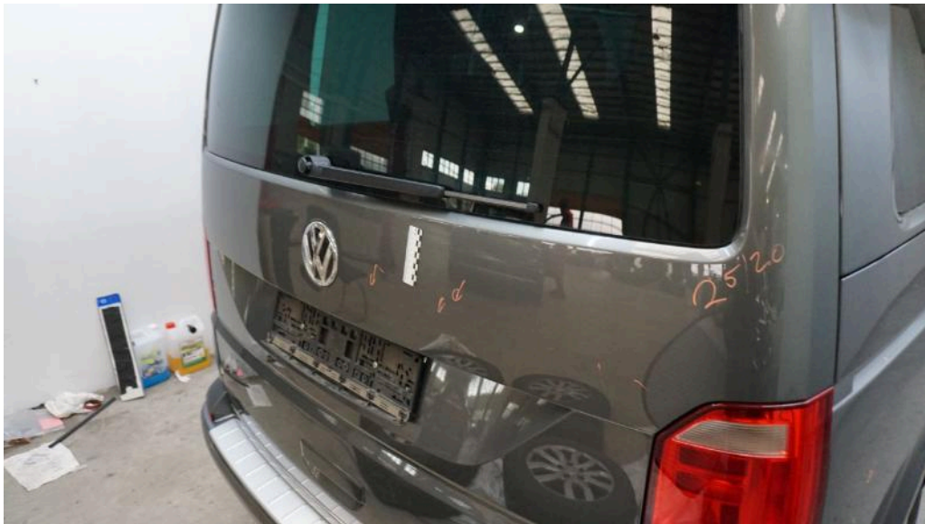
Bild 22 Fahrzeugheck Heckklappe Dellen
