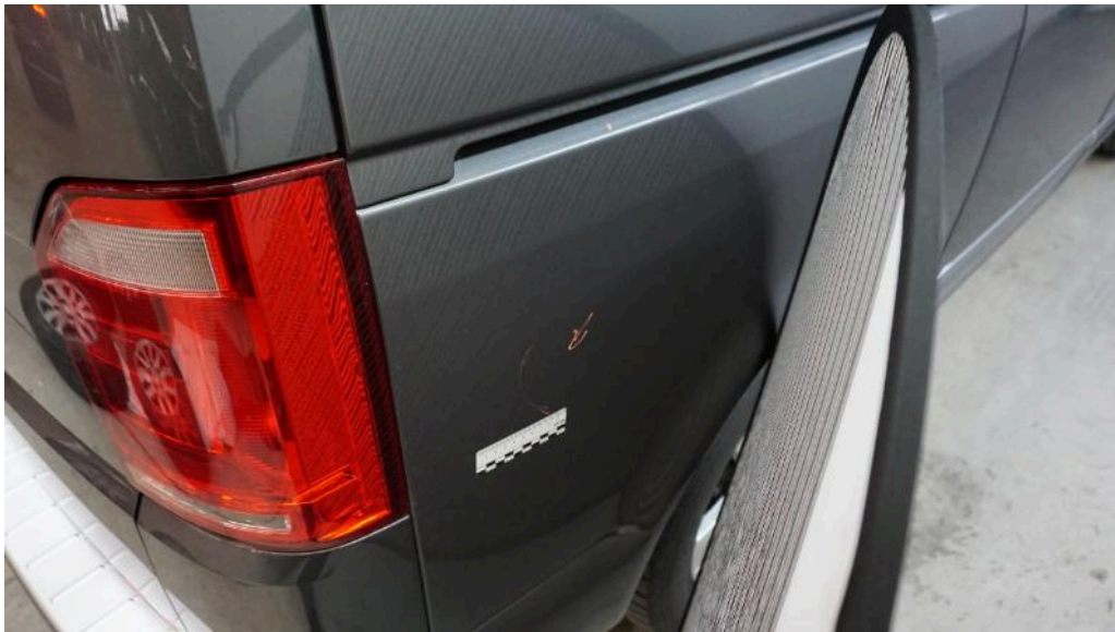
Bild 24 rechte Seite Seitenwand hinten rechts Delle
