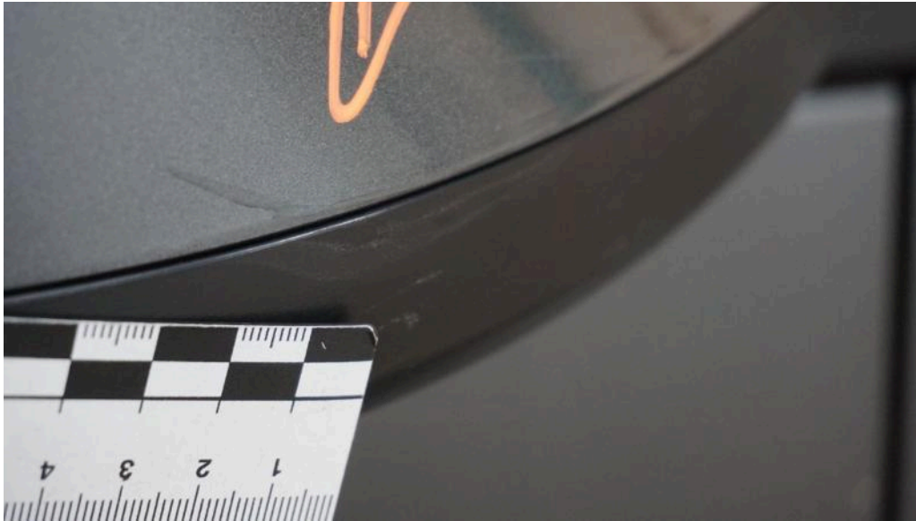
Bild 27 rechte Seite Außenspiegel rechts verkratzt
