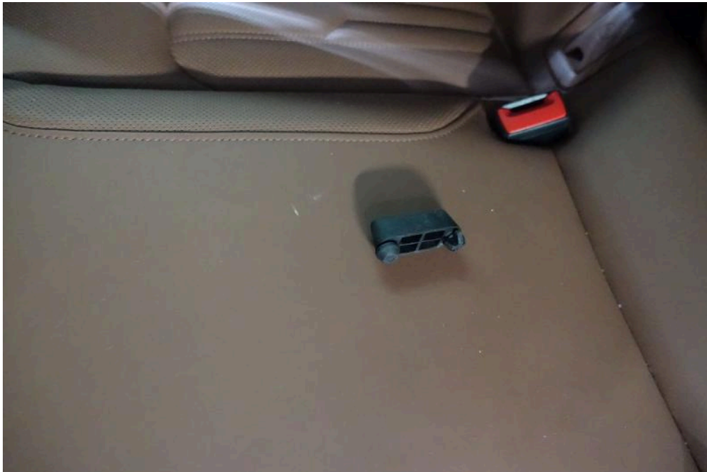
Bild 44 Innenraum Lederausstattung Fremdkörper zwischen den Sitzteilen hinten eingedrückt
