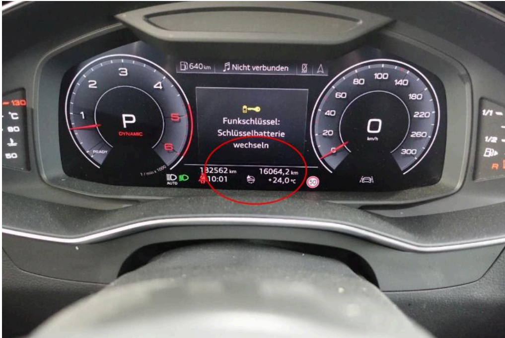
Bild 19 Fahrzeugzubehör Funkschlüssel Batterie erneuern ohne Funktion
