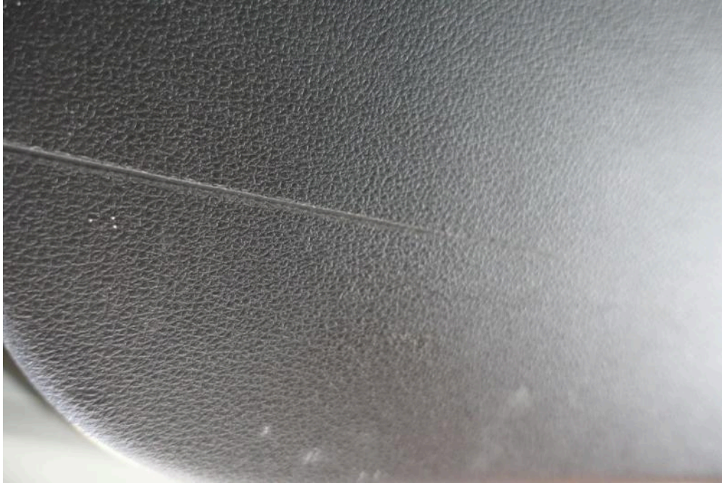
Bild 35 Innenraum Heckklappenverkleidung innen Kratzer Abrieb verkratzt
