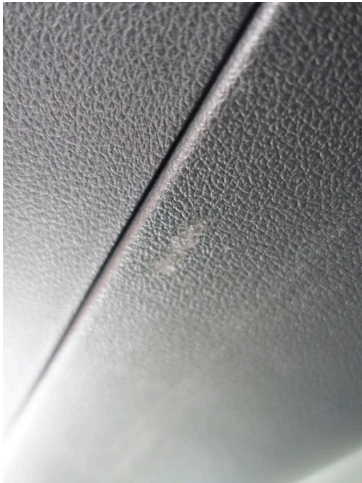
Bild 36 Innenraum Heckklappenverkleidung innen Kratzer Abrieb verkratzt
