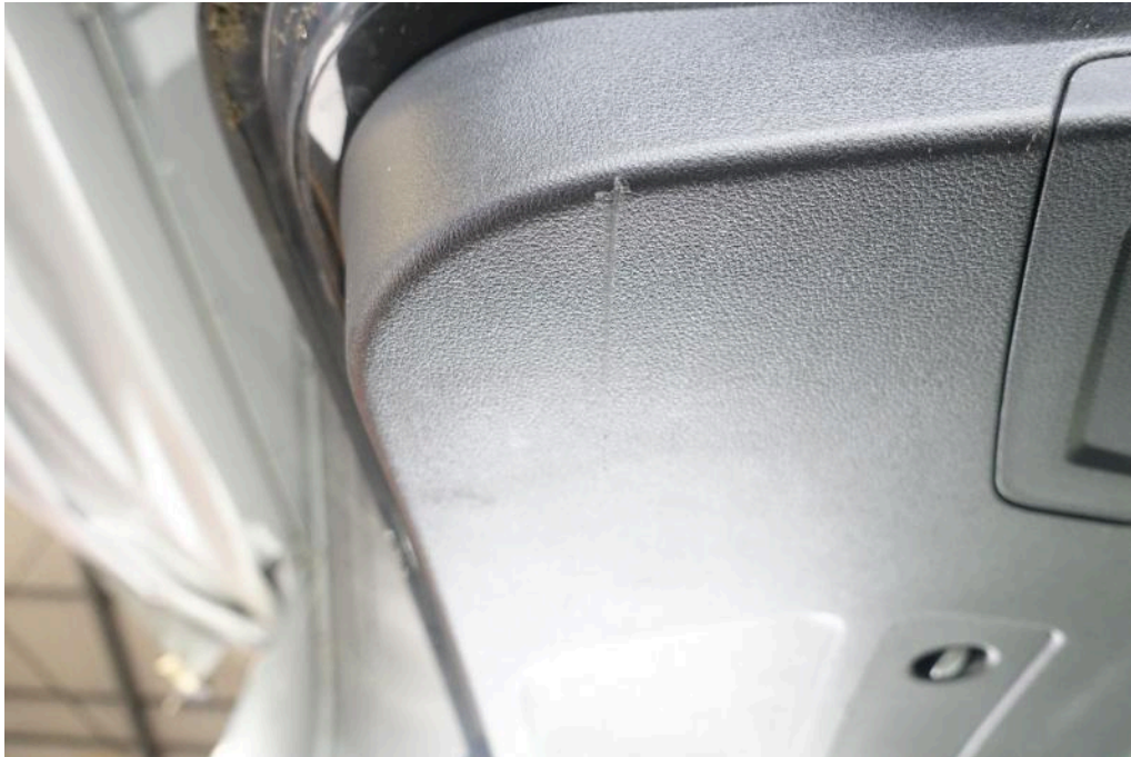
Bild 33 Innenraum Heckklappenverkleidung innen Kratzer Abrieb verkratzt
