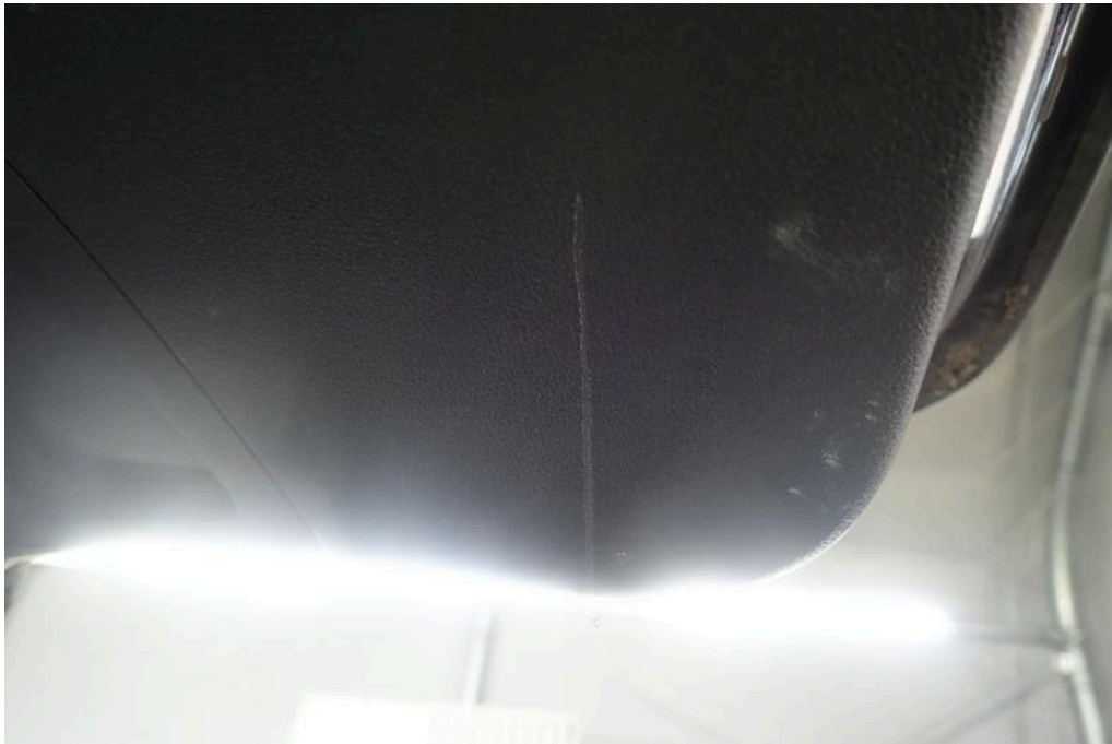
Bild 32 Innenraum Heckklappenverkleidung innen Kratzer Abrieb verkratzt
