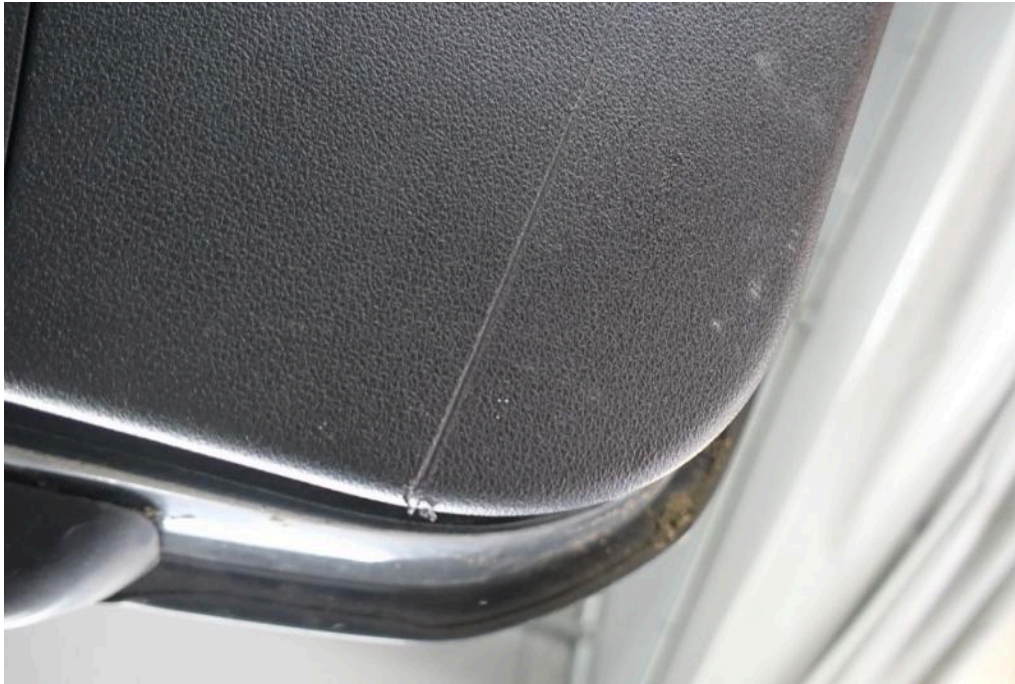
Bild 39 Innenraum Heckklappenverkleidung innen Kratzer Abrieb verkratzt
