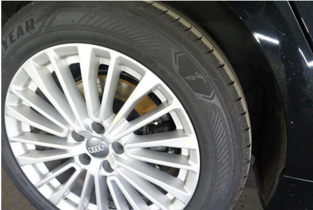
Bild 29 Hinterachse Felge hinten rechts Bordsteinschaden / Angestoßen / Beschädigung Materialabtrag
