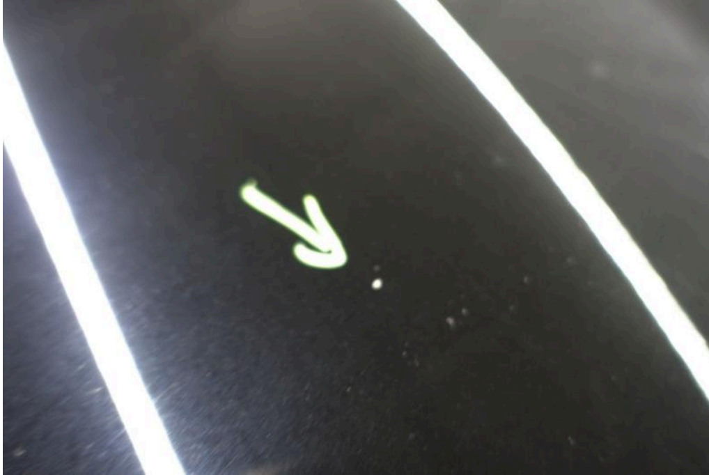
Bild 27 Fahrzeugfront Motorhaube Steinschlag / -schläge
