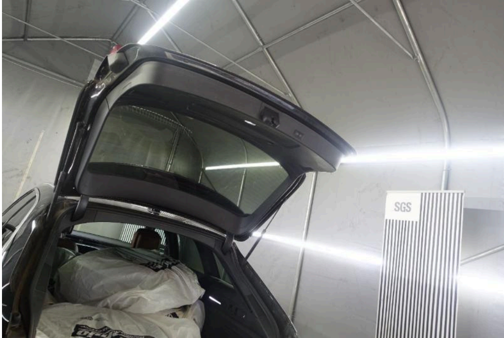
Bild 31 Innenraum Heckklappenverkleidung innen Kratzer Abrieb verkratzt
