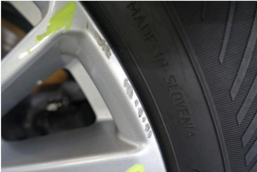
Bild 30 Hinterachse Felge hinten rechts Bordsteinschaden / Angestoßen / Beschädigung Materialabtrag
