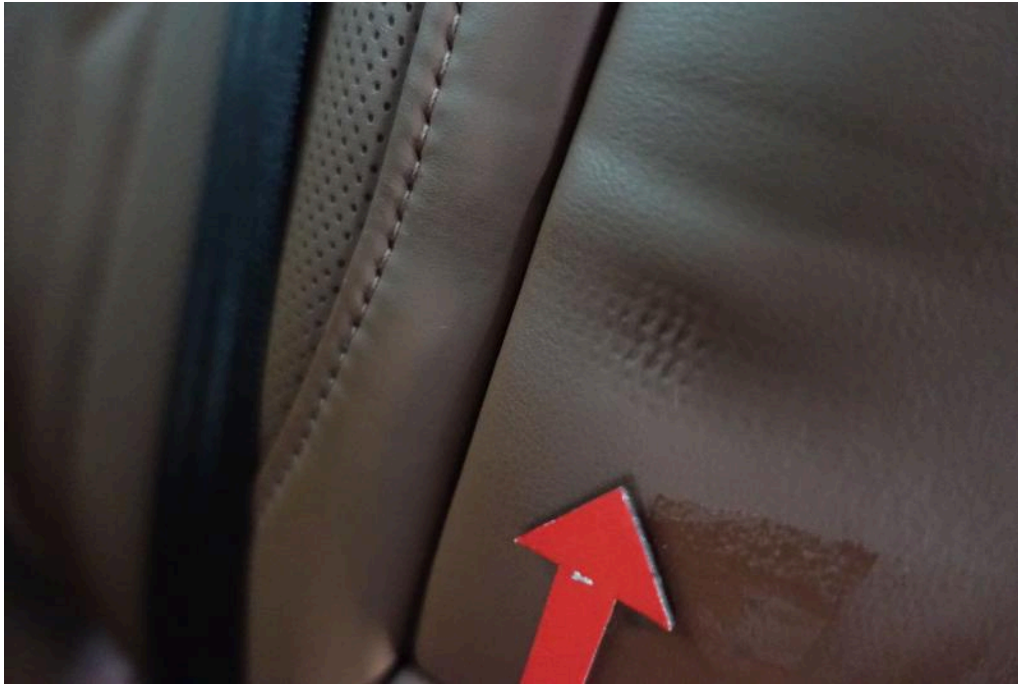
Bild 43 Innenraum Lederausstattung Fremdkörper zwischen den Sitzteilen hinten eingedrückt
