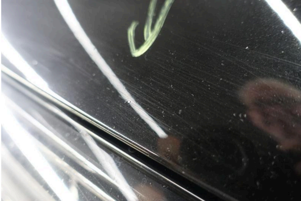
Bild 21 Fahrzeugfront Motorhaube Steinschlag / -schläge
