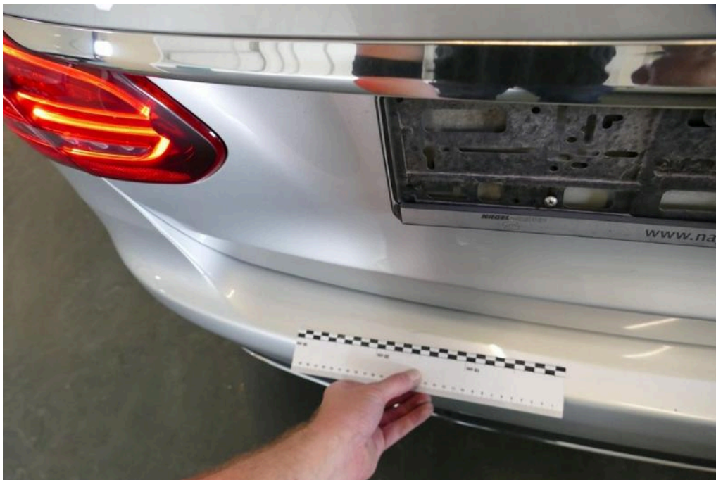
Bild 18 Fahrzeugheck Stoßfänger hinten Schaden in der Ladezone. Aus hiesiger Sicht durch normale Nutzung. Kratzer
