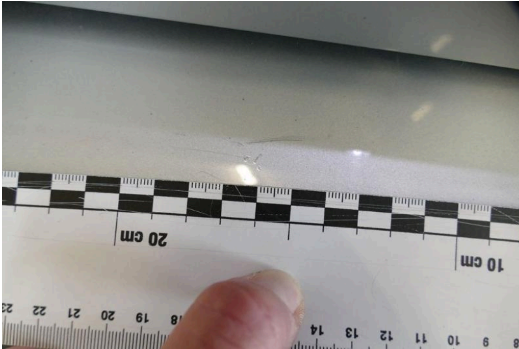
Bild 19 Fahrzeugheck Stoßfänger hinten Schaden in der Ladezone. Aus hiesiger Sicht durch normale Nutzung. Kratzer
