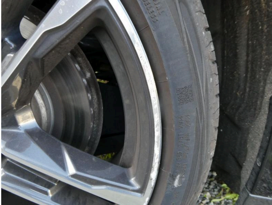
Bild 35 Hinterachse Reifen hinten rechts beschädigt
