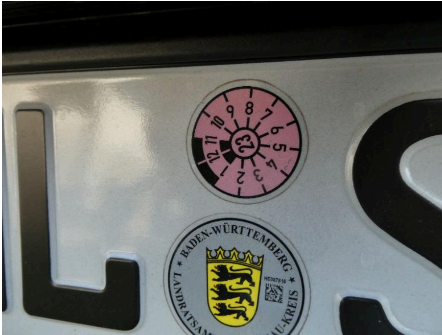
Bild 27 Wartung/Prüfung Hauptuntersuchung (HU) überfällig
