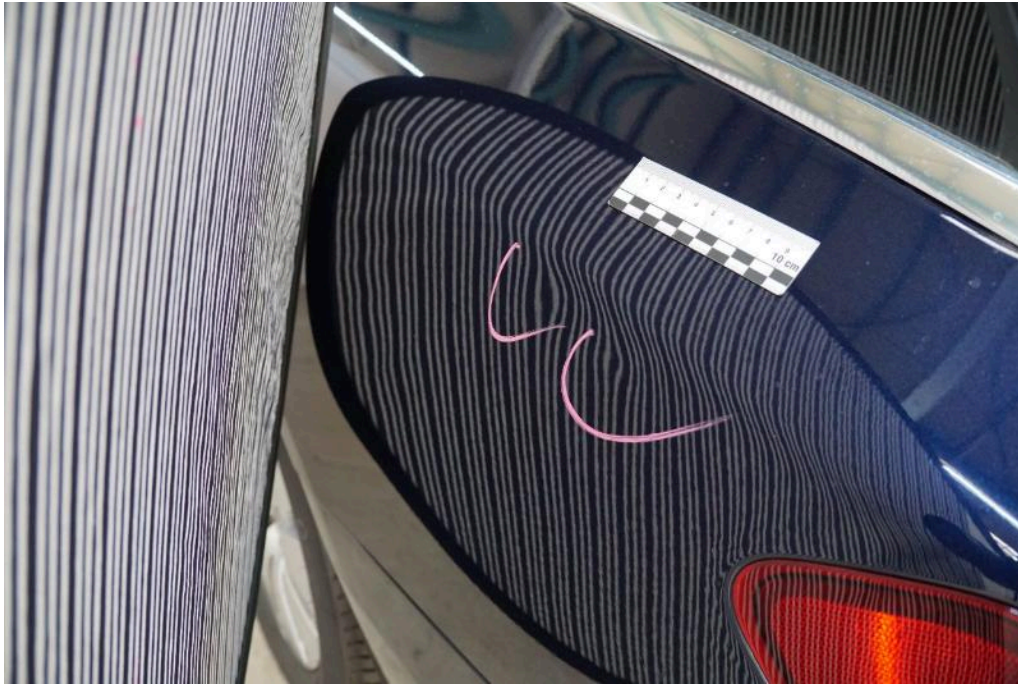
Bild 23 linke Seite Seitenwand hinten links Dellen
