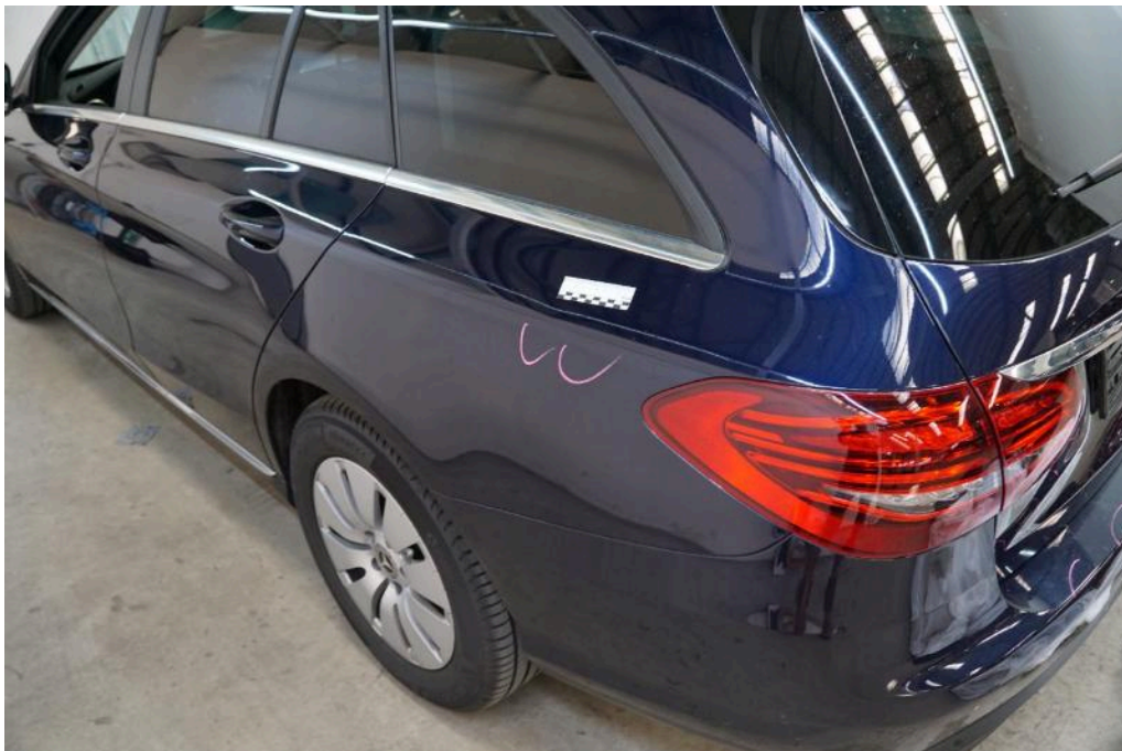
Bild 22 linke Seite Seitenwand hinten links Dellen
