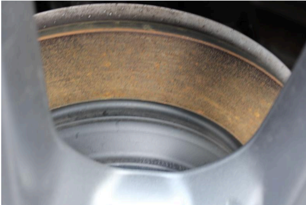
Bild 25 Hinterachse Bremsscheiben hinten bedingt durch Standzeit, freibremse korrodiert
