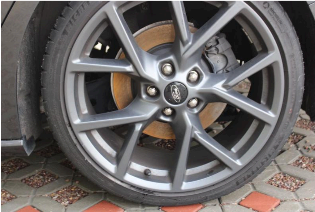
Bild 23 Hinterachse Bremsscheiben hinten bedingt durch Standzeit, freibremse korrodiert
