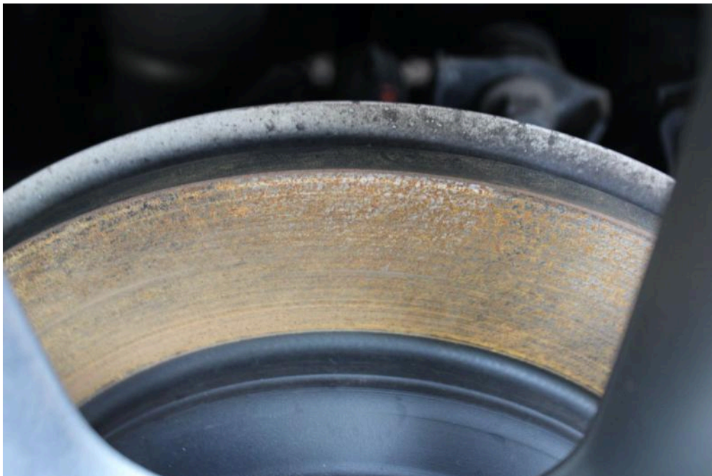
Bild 24 Hinterachse Bremsscheiben hinten bedingt durch Standzeit, freibremse korrodiert
