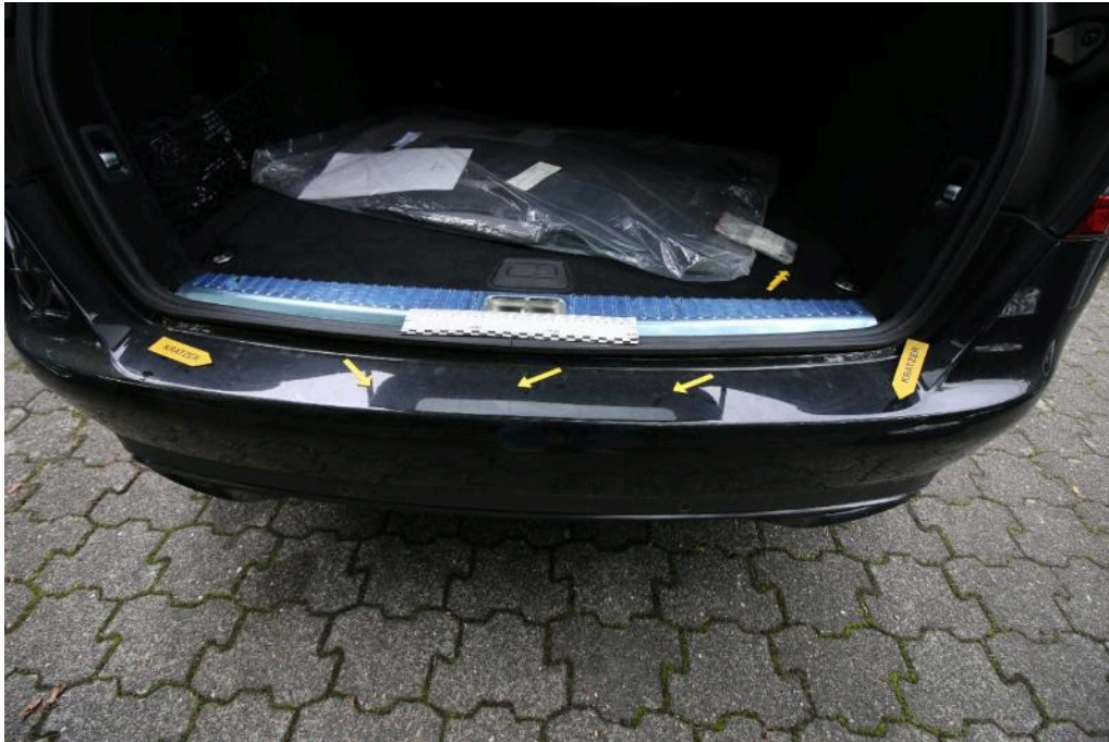
Bild 19 Fahrzeugheck Stoßfänger hinten verkratzt
