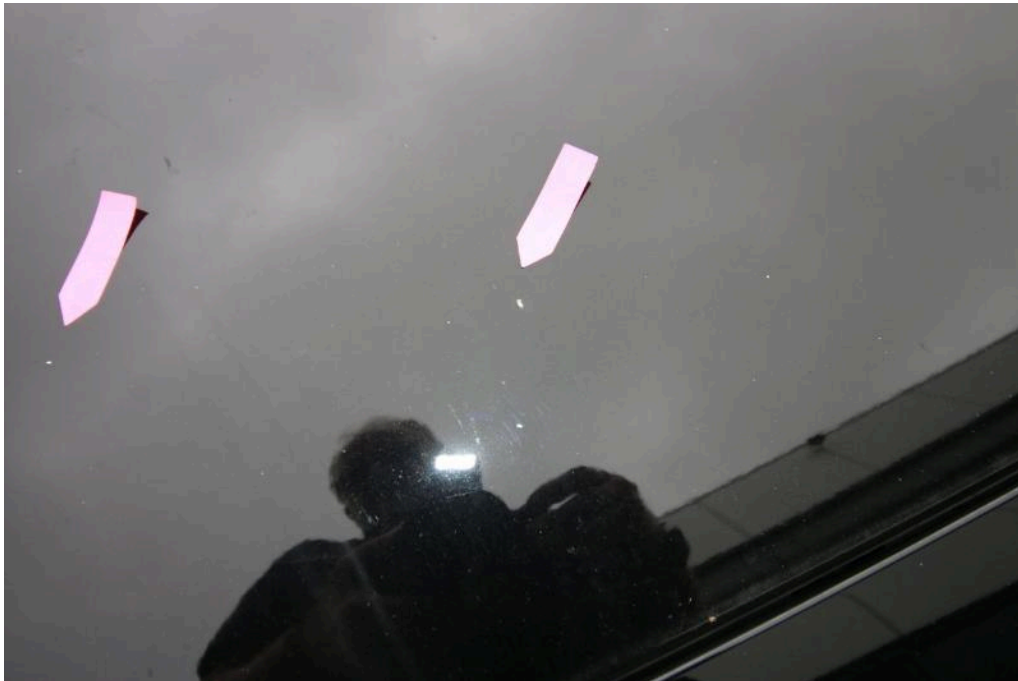
Bild 32 Fahrzeugfront Motorhaube Steinschlag / -schläge
