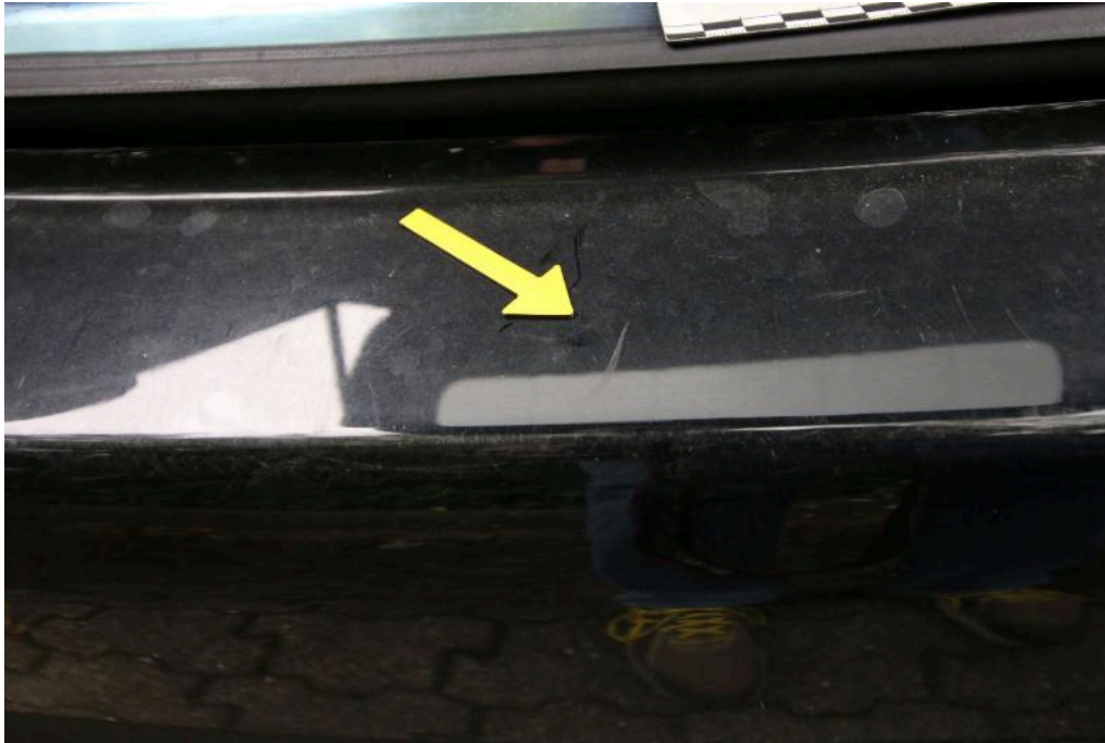
Bild 21 Fahrzeugheck Stoßfänger hinten verkratzt
