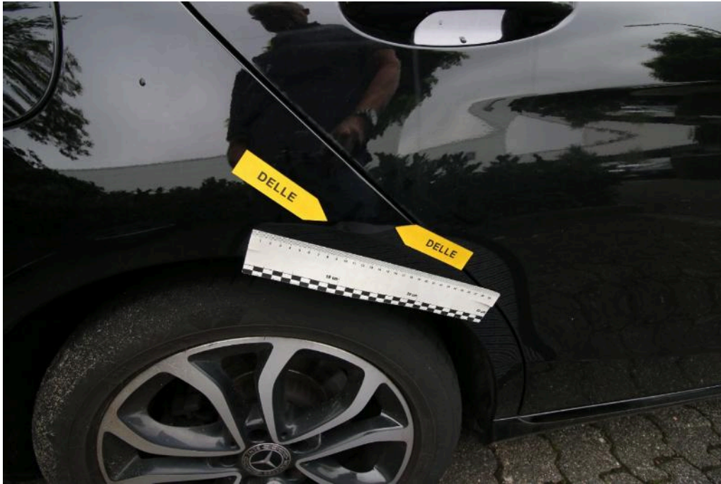
Bild 25 rechte Seite Seitenwand hinten rechts Dellen mit Lackschaden Dellen
