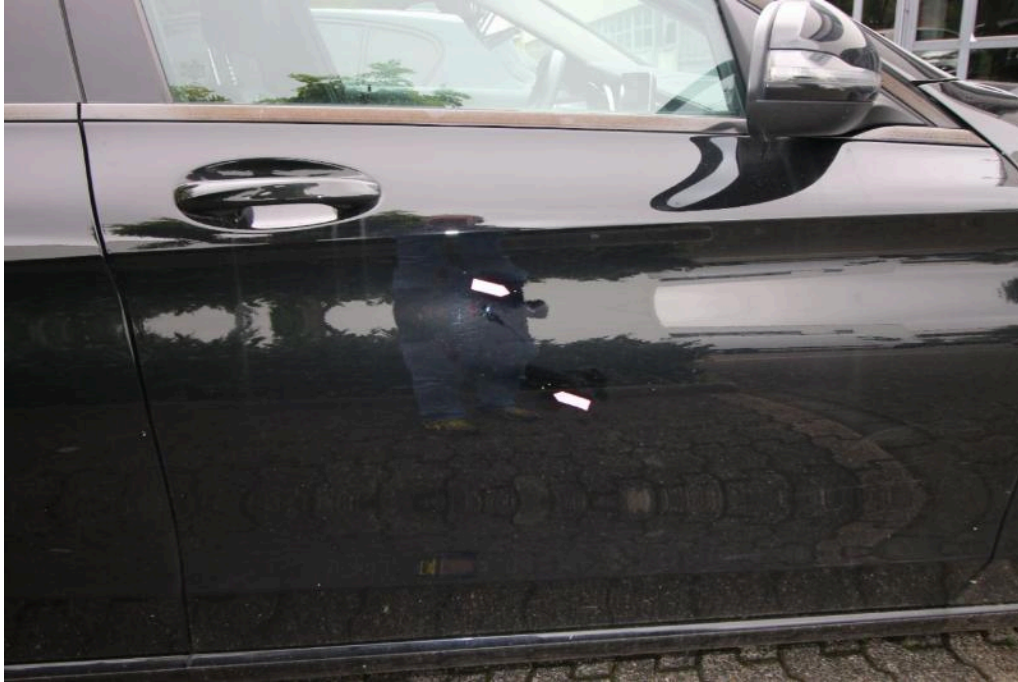
Bild 37 rechte Seite Tür vorne rechts angestoßen
