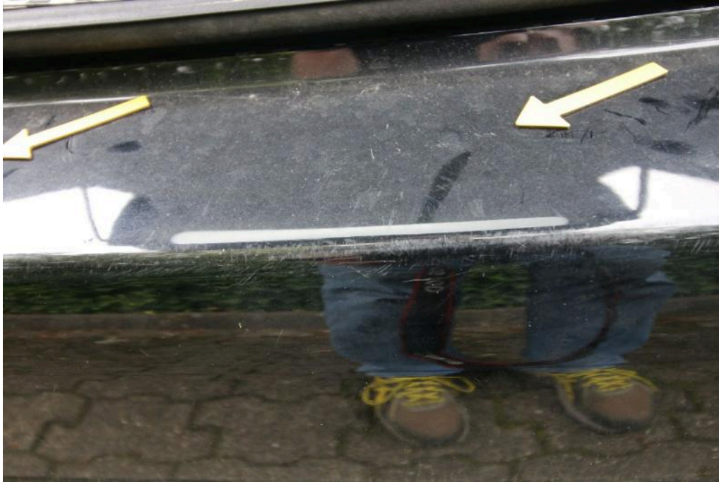
Bild 23 Fahrzeugheck Stoßfänger hinten verkratzt
