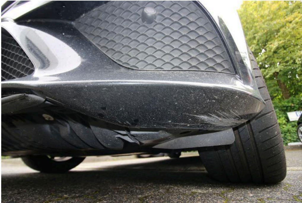
Bild 29 Fahrzeugfront Stoßfänger vorne angestoßen
