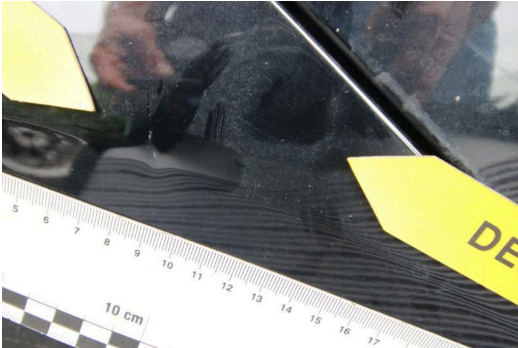
Bild 27 rechte Seite Seitenwand hinten rechts Dellen mit Lackschaden Dellen
