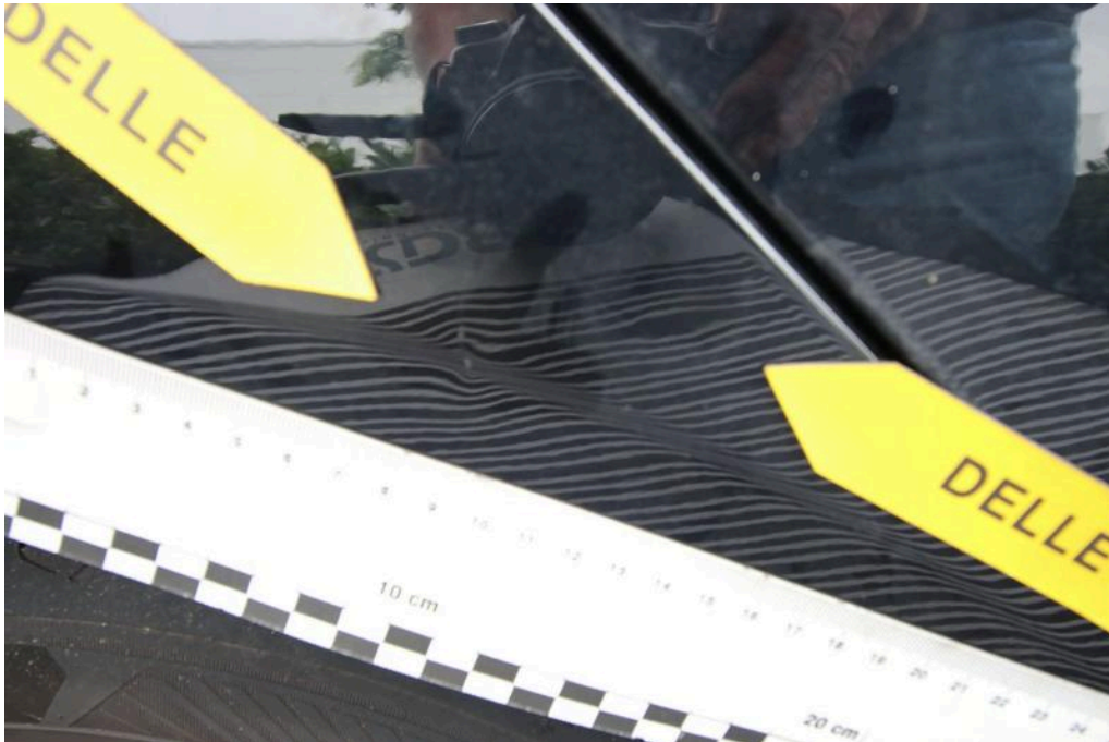
Bild 26 rechte Seite Seitenwand hinten rechts Dellen mit Lackschaden Dellen
