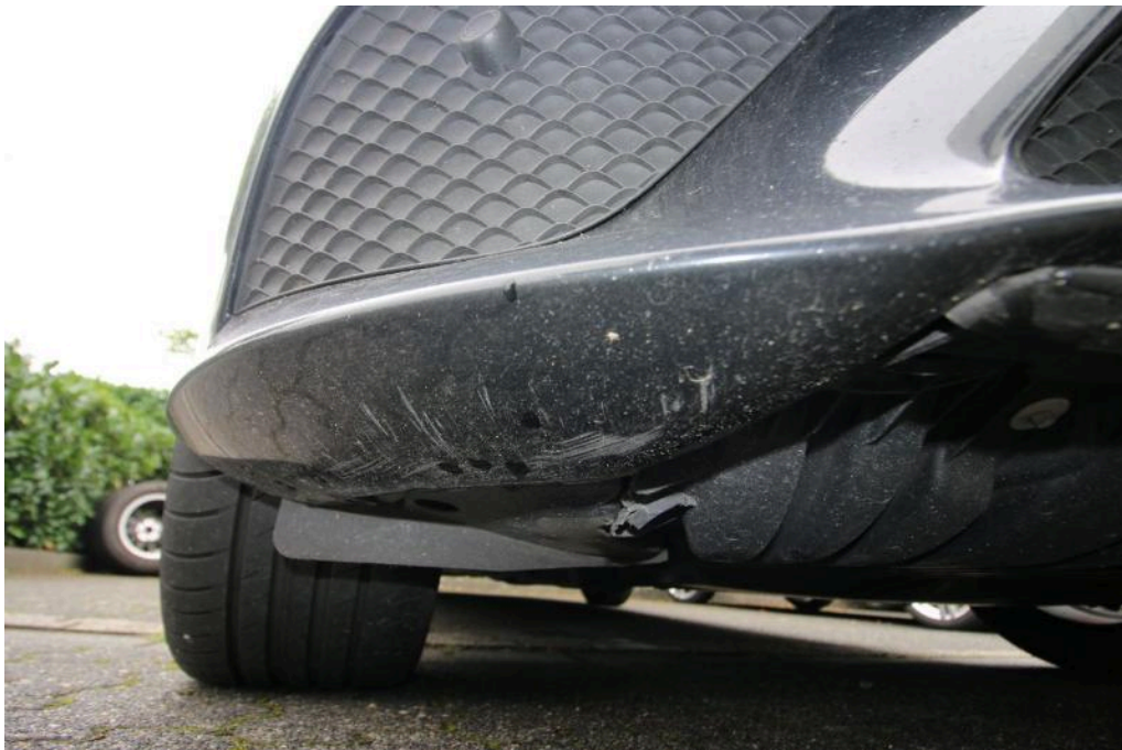
Bild 28 Fahrzeugfront Stoßfänger vorne angestoßen, Fahrzeug Unterbodenverkleidung vorne beschädigt
