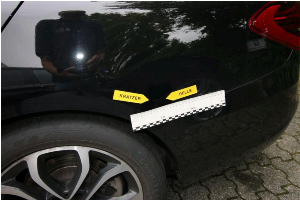
Bild 34 linke Seite Seitenwand hinten links Kratzer und Delle
