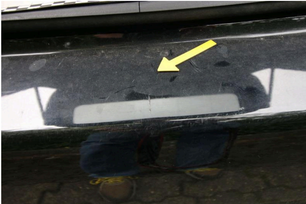
Bild 22 Fahrzeugheck Stoßfänger hinten verkratzt
