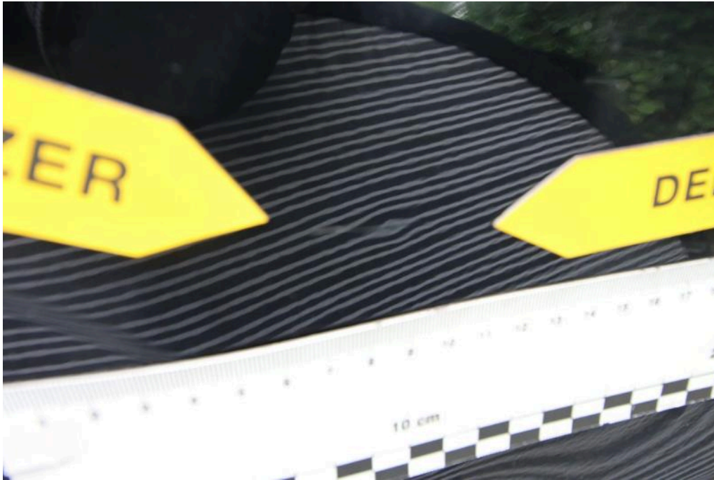
Bild 35 linke Seite Seitenwand hinten links Kratzer und Delle
