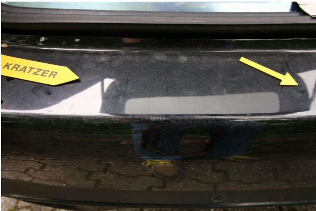
Bild 20 Fahrzeugheck Stoßfänger hinten verkratzt
