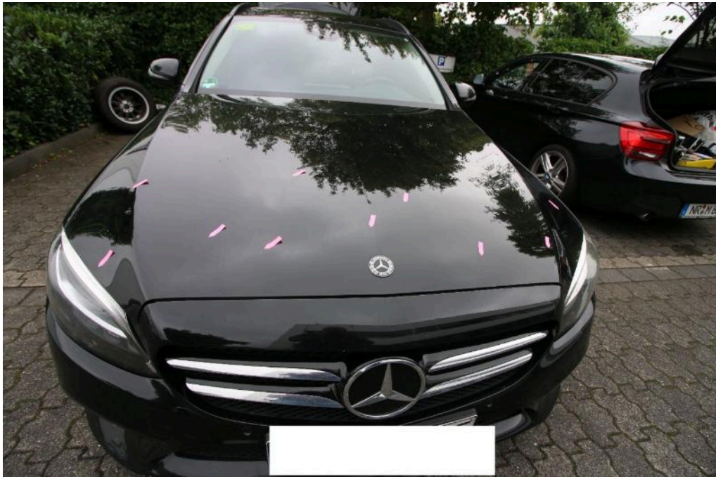
Bild 30 Fahrzeugfront Motorhaube Steinschlag / -schläge
