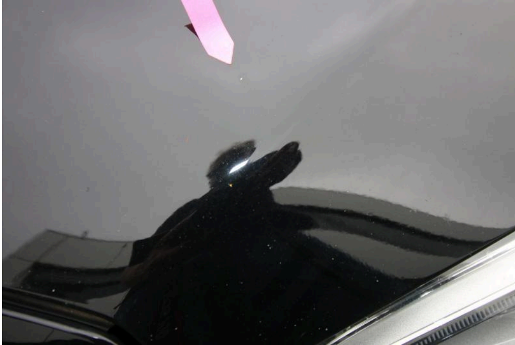
Bild 33 Fahrzeugfront Motorhaube Steinschlag / -schläge
