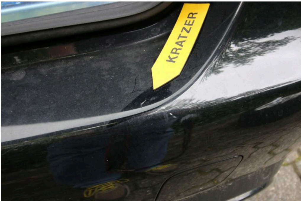
Bild 24 Fahrzeugheck Stoßfänger hinten verkratzt
