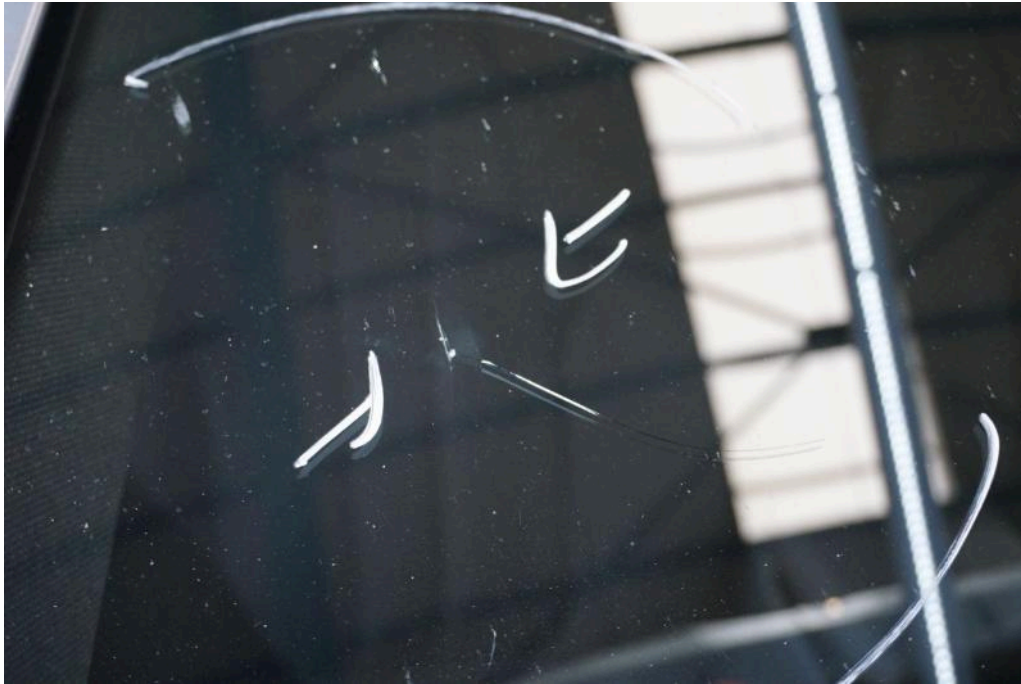
Bild 17 Fahrzeugfront Windschutzscheibe gerissen / eingerissen
