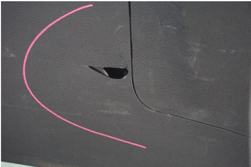
Bild 18 Innenraum Heckklappenverkleidung innen gebrochen
