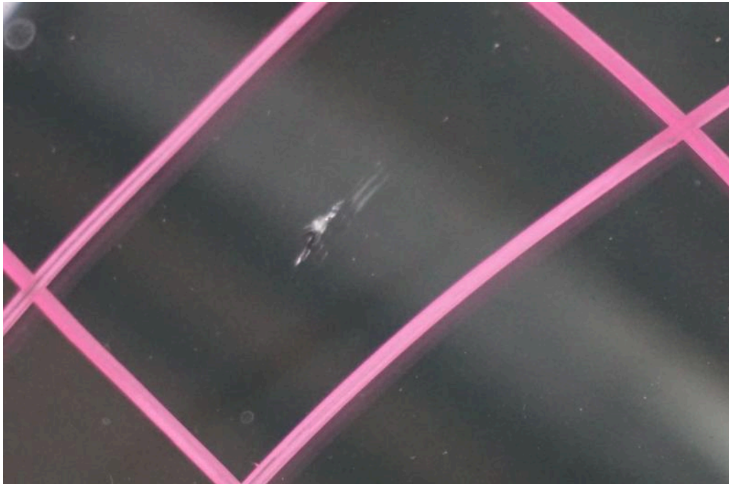
Bild 22 Fahrzeugfront Windschutzscheibe gerissen / eingerissen
