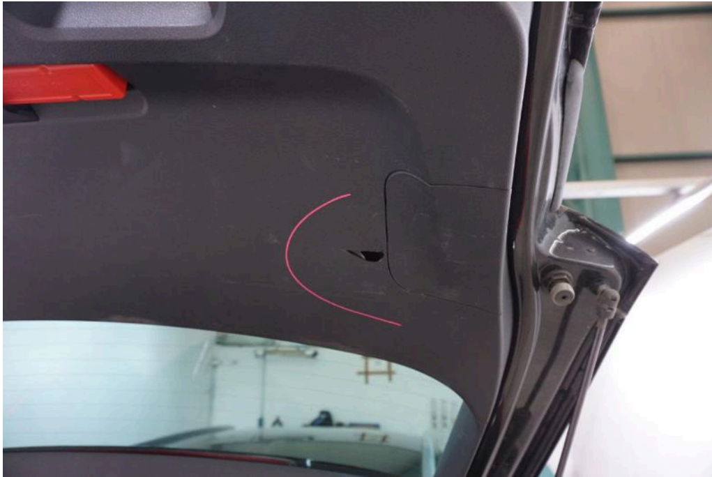
Bild 17 Innenraum Heckklappenverkleidung innen gebrochen
