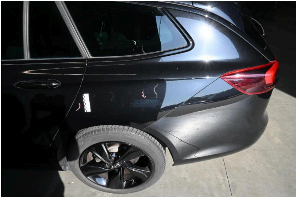
Bild 22 linke Seite Seitenwand hinten links Kratzer + Delle
