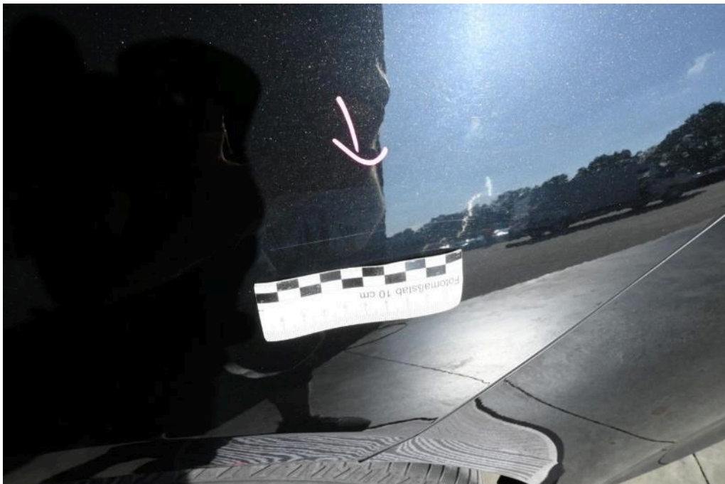
Bild 24 linke Seite Seitenwand hinten links Kratzer + Delle
