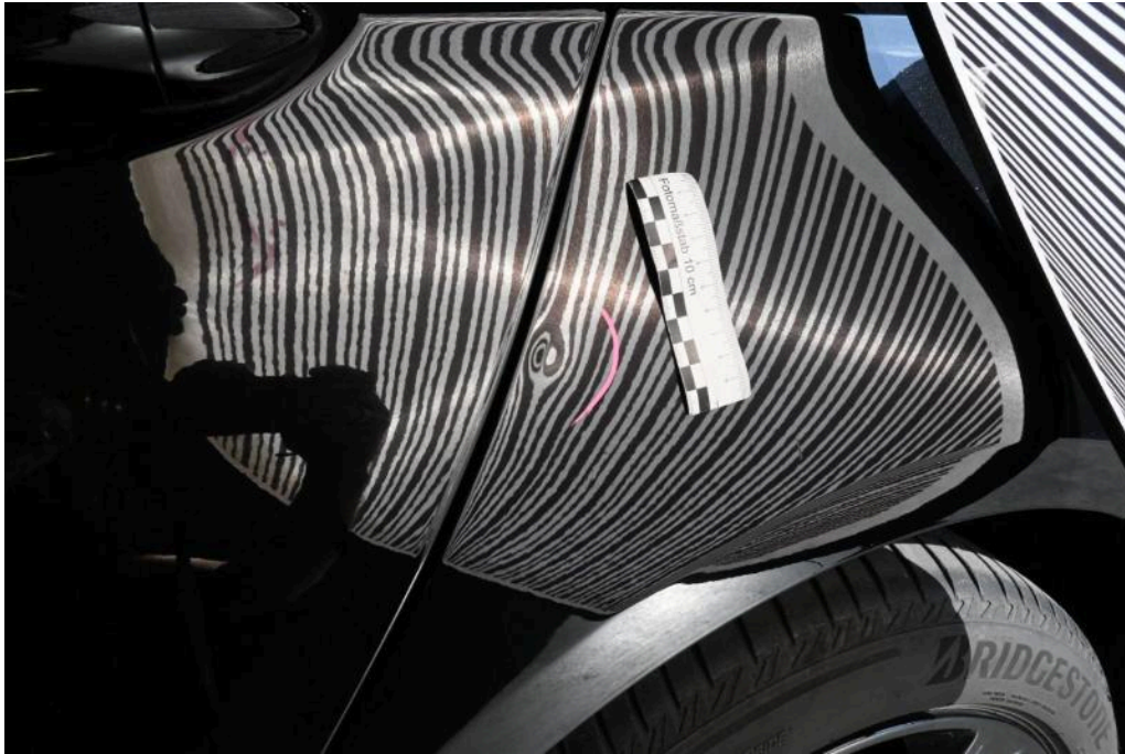
Bild 23 linke Seite Seitenwand hinten links Kratzer + Delle
