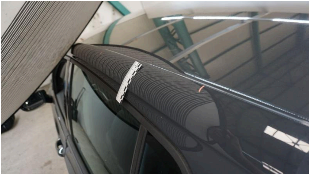
Bild 26 Fahrzeug Hagelschaden Motorhaube 5/20; Dach 250 / 20; Holm links 5/20; Holm rechts 10 / 20 - Kostenerweiterung möglich
