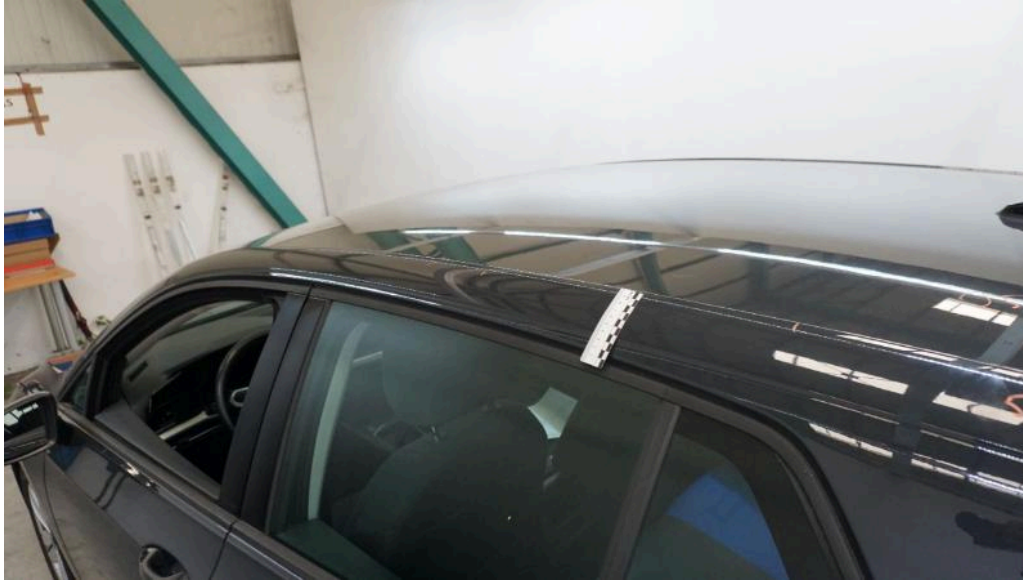
Bild 25 Fahrzeug Hagelschaden Motorhaube 5/20; Dach 250 / 20; Holm links 5/20; Holm rechts 10 / 20 - Kostenerweiterung möglich
