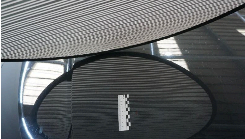
Bild 19 Fahrzeug Hagelschaden Motorhaube 5/20; Dach 250 / 20; Holm links 5/20; Holm rechts 10 / 20 - Kostenerweiterung möglich
