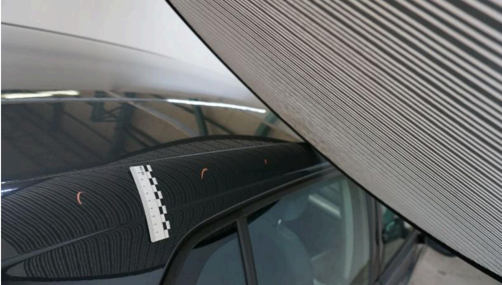
Bild 27 Fahrzeug Hagelschaden Motorhaube 5/20; Dach 250 / 20; Holm links 5/20; Holm rechts 10 / 20 - Kostenerweiterung möglich
