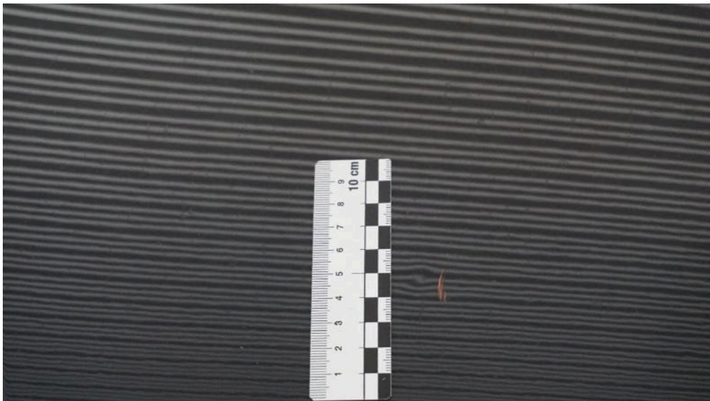
Bild 20 Fahrzeug Hagelschaden Motorhaube 5/20; Dach 250 / 20; Holm links 5/20; Holm rechts 10 / 20 - Kostenerweiterung möglich
