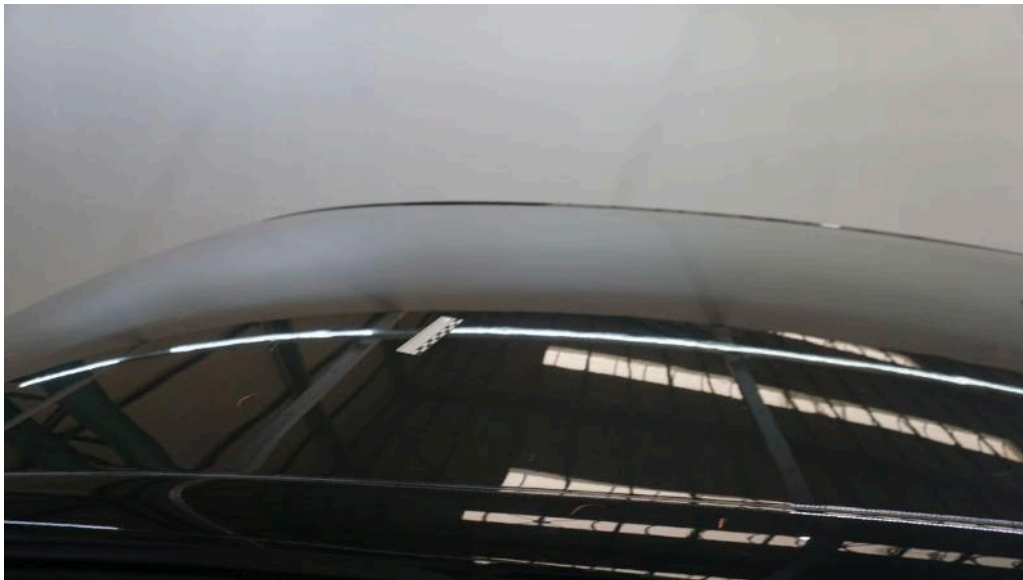
Bild 22 Fahrzeug Hagelschaden Motorhaube 5/20; Dach 250 / 20; Holm links 5/20; Holm rechts 10 / 20 - Kostenerweiterung möglich
