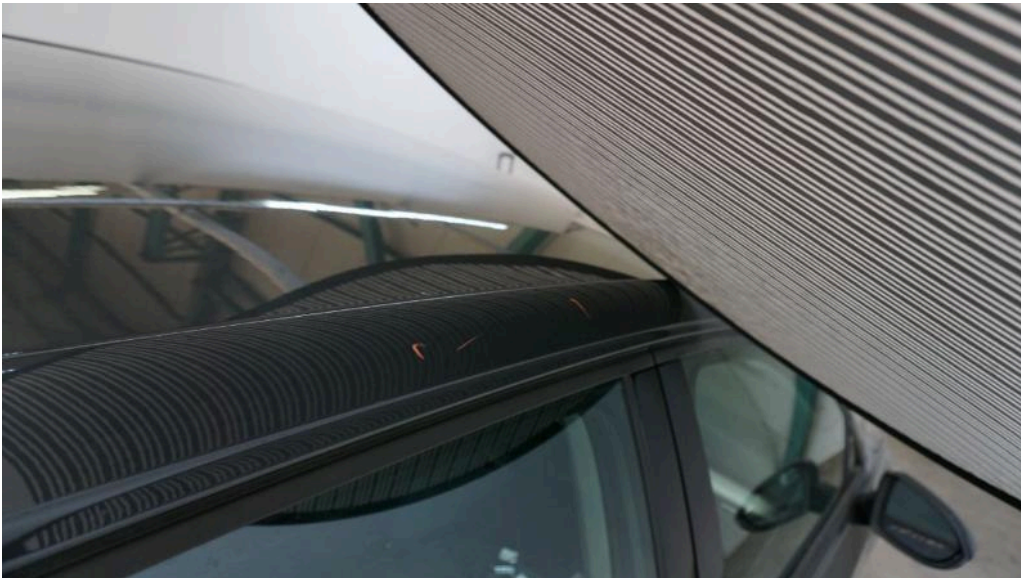
Bild 28 Fahrzeug Hagelschaden Motorhaube 5/20; Dach 250 / 20; Holm links 5/20; Holm rechts 10 / 20 - Kostenerweiterung möglich
