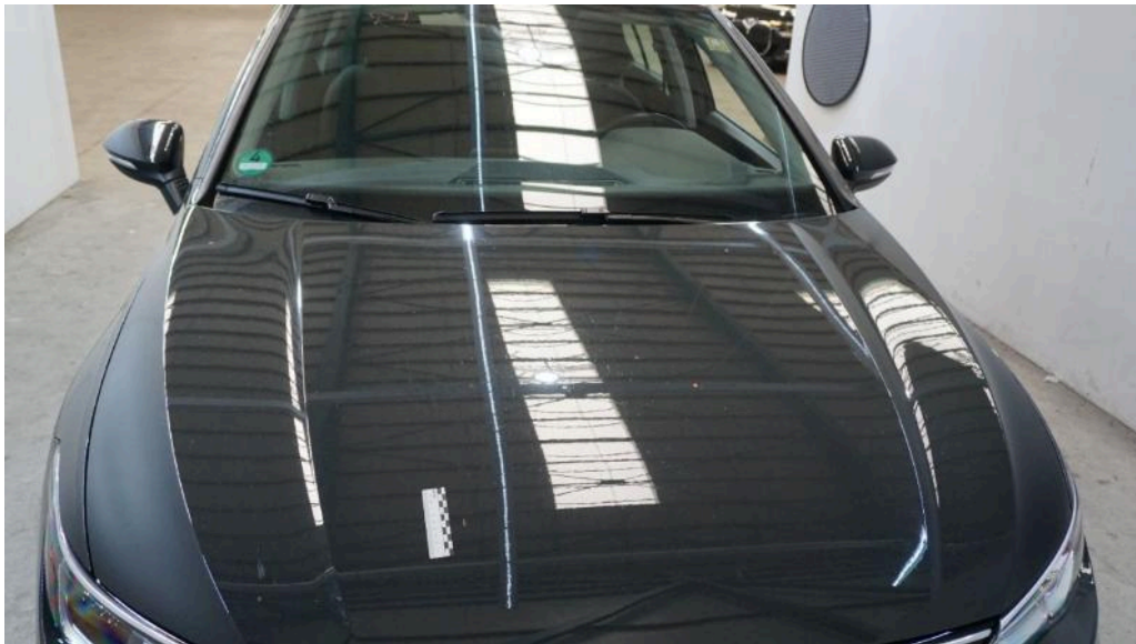
Bild 18 Fahrzeug Hagelschaden Motorhaube 5/20; Dach 250 / 20; Holm links 5/20; Holm rechts 10 / 20 - Kostenerweiterung möglich
