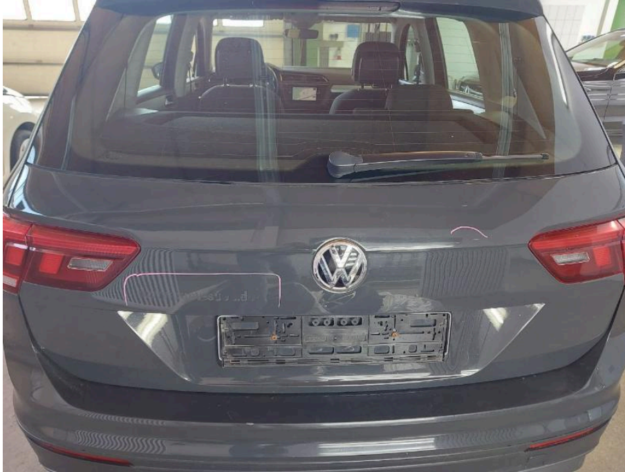
Bild 17 Fahrzeugheck Heckklappe Klebereste
