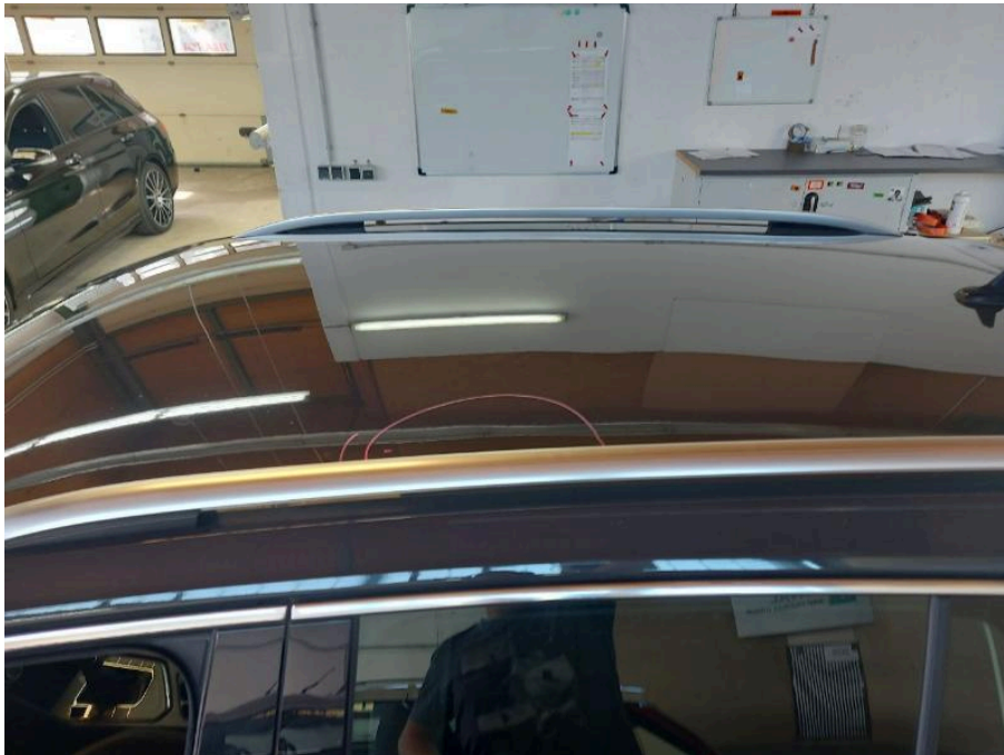
Bild 22 Dach Dachhaut Dellen
