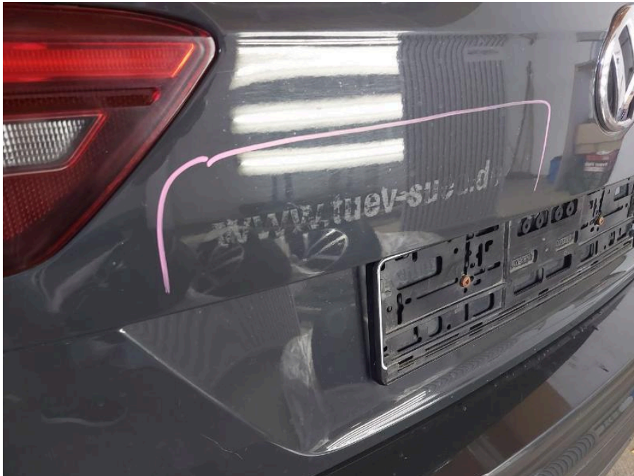
Bild 18 Fahrzeugheck Heckklappe Klebereste
