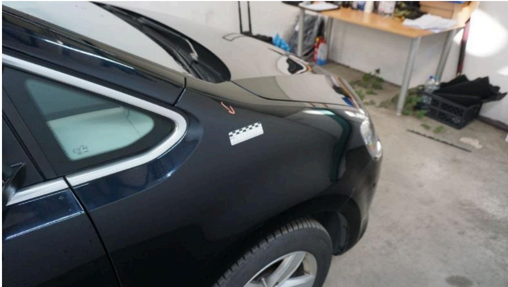
Bild 24 rechte Seite Kotflügel vorne rechts Kratzer
