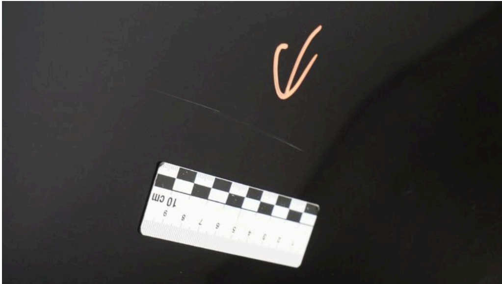
Bild 21 linke Seite Kotflügel vorne links Kratzer
