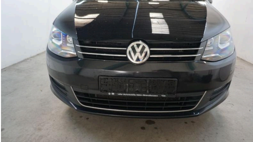
Bild 17 Fahrzeugfront Stoßfänger vorne Steinschlag / -schläge
