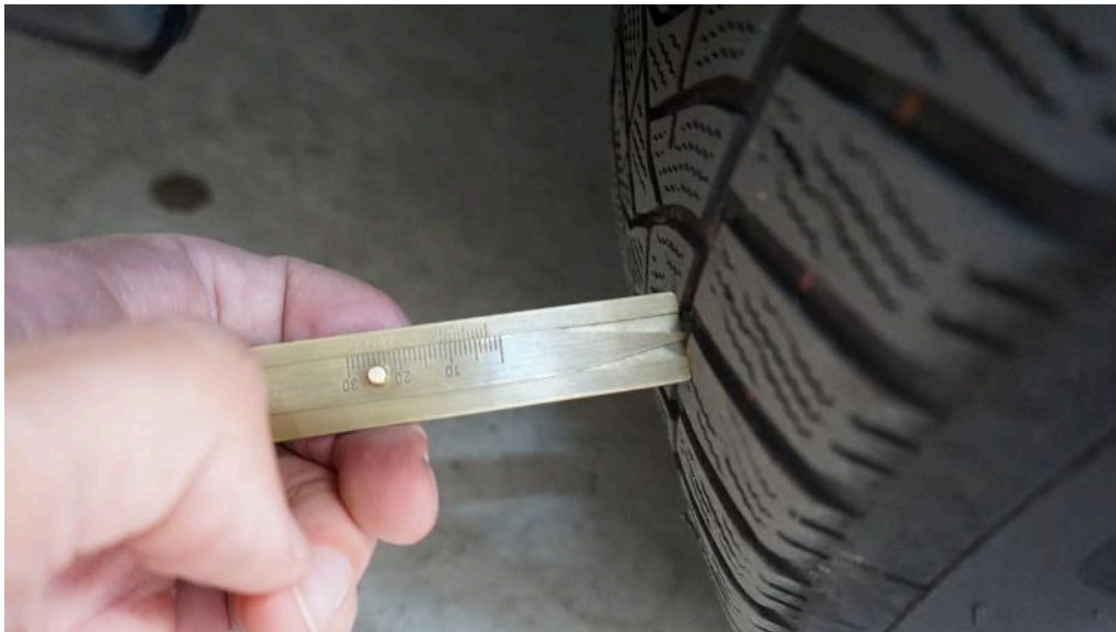
Bild 22 Vorderachse Reifen vorne rechts Verschleißgrenze erreicht
