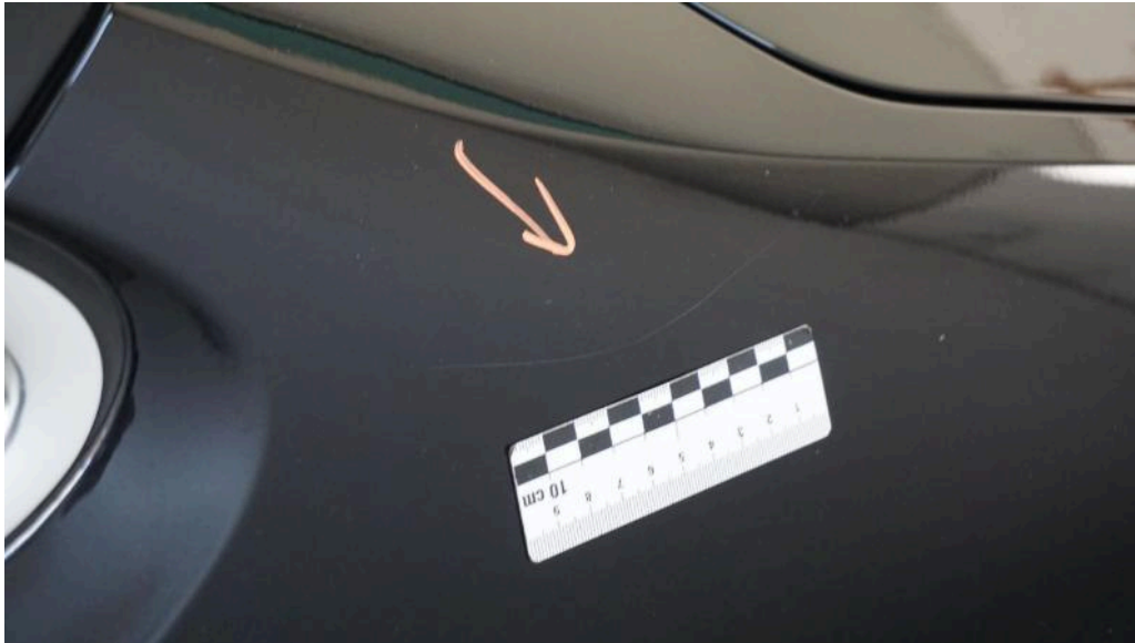
Bild 25 rechte Seite Kotflügel vorne rechts Kratzer
