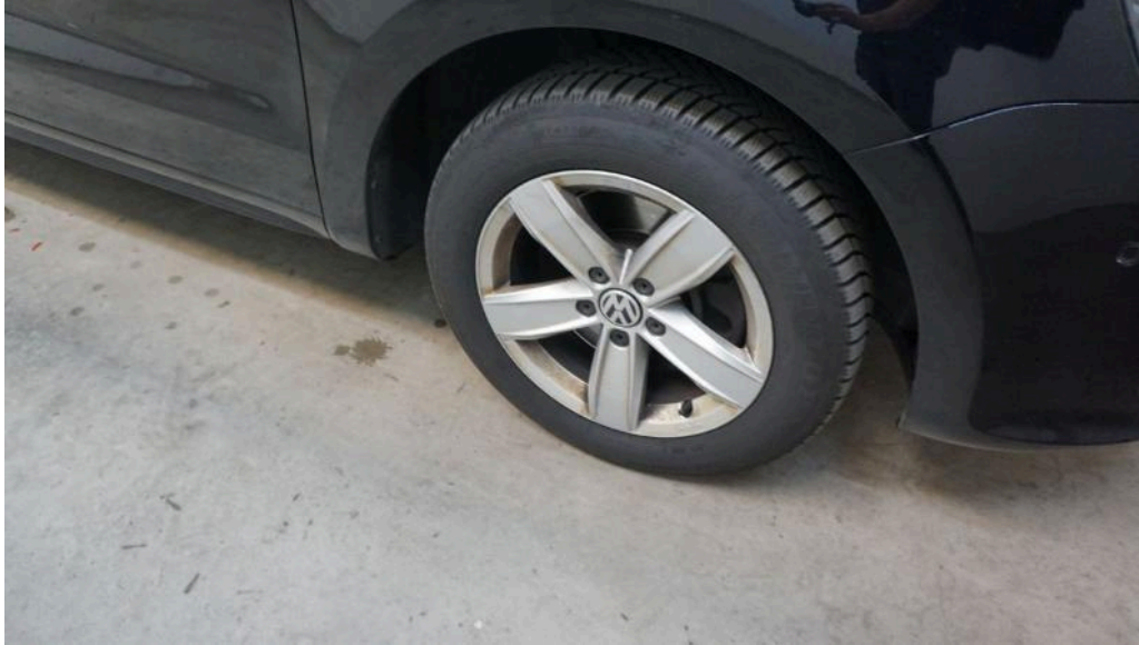
Bild 23 Vorderachse Reifen vorne rechts Verschleißgrenze erreicht
