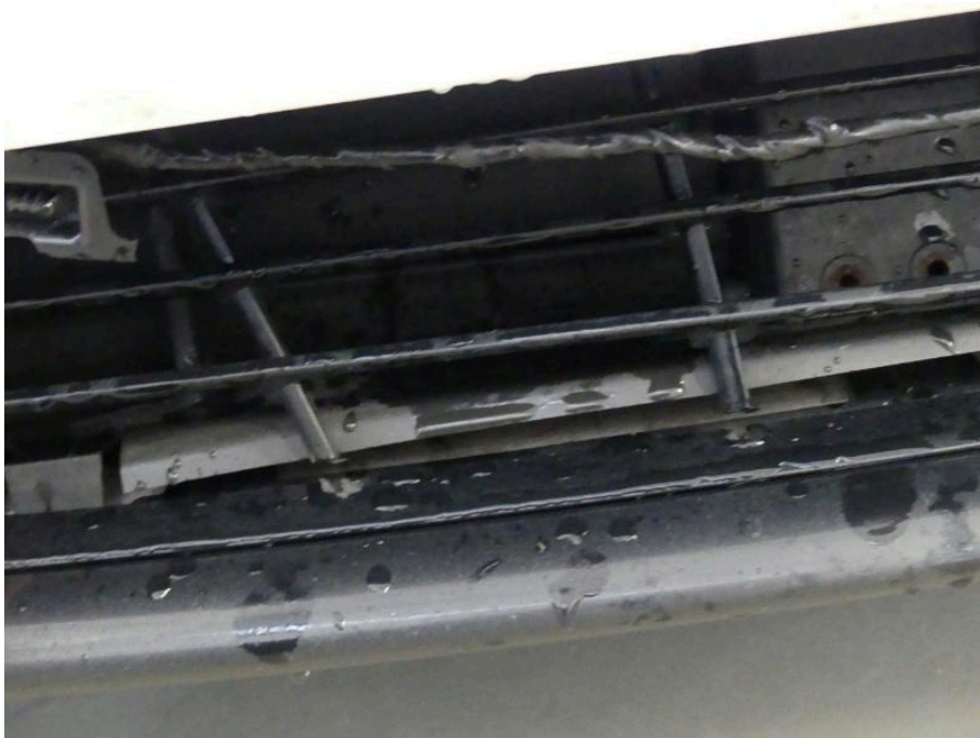
Bild 24 Fahrzeugfront Stoßfänger vorne Beschädigung Stoßfänger vorn / Luftführungsgitter / Kabel Parksensoren / Lüftungklappen beschädigt ( Unfallschaden ), Schadenerweiterung möglich
