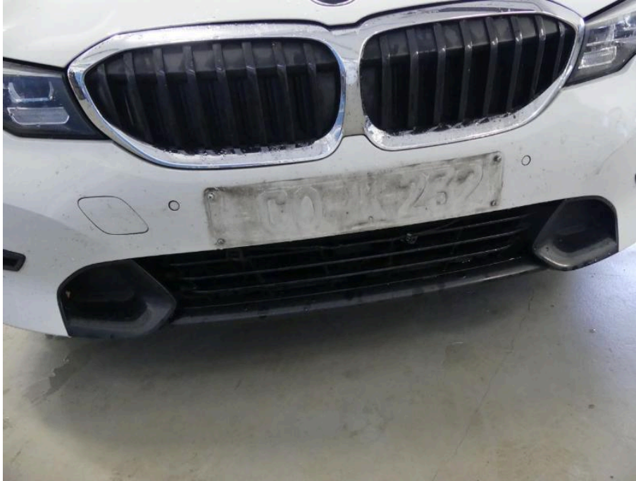
Bild 21 Fahrzeugfront Stoßfänger vorne Beschädigung Stoßfänger vorn / Luftführungsgitter / Kabel Parksensoren / Lüftungklappen beschädigt ( Unfallschaden ), Schadenerweiterung möglich
