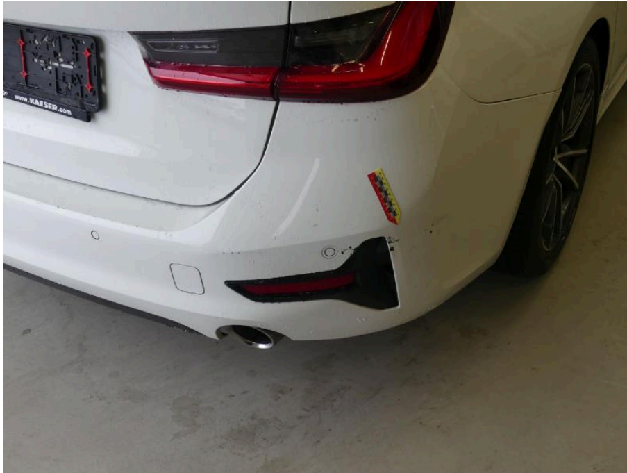
Bild 37 Fahrzeugheck Stoßfänger hinten angestoßen verformt
