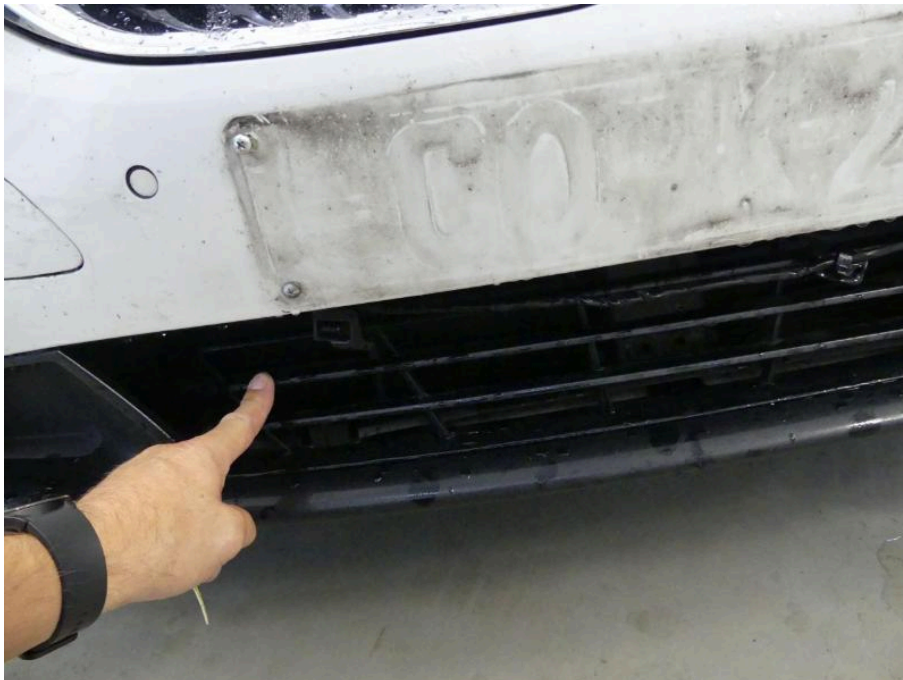
Bild 22 Fahrzeugfront Stoßfänger vorne Beschädigung Stoßfänger vorn / Luftführungsgitter / Kabel Parksensoren / Lüftungklappen beschädigt ( Unfallschaden ), Schadenerweiterung möglich
