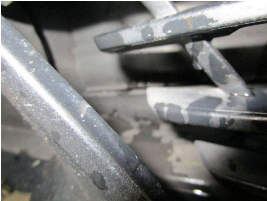
Bild 28 Fahrzeugfront Stoßfänger vorne Beschädigung Stoßfänger vorn / Luftführungsgitter / Kabel Parksensoren / Lüftungklappen beschädigt ( Unfallschaden ), Schadenerweiterung möglich
