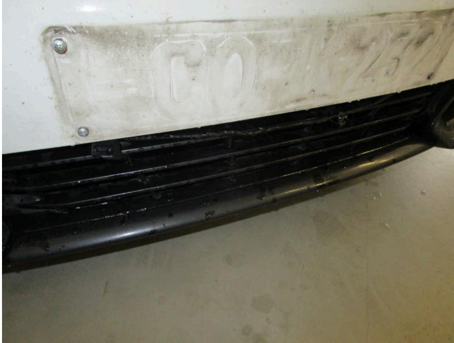
Bild 29 Fahrzeugfront Stoßfänger vorne Beschädigung Stoßfänger vorn / Luftführungsgitter / Kabel Parksensoren / Lüftungklappen beschädigt ( Unfallschaden ), Schadenerweiterung möglich
