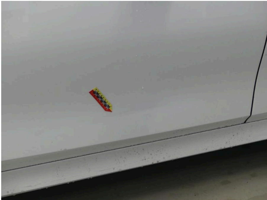
Bild 48 rechte Seite Tür hinten rechts Tür HR instandsetzen / Tür VR erneuern beschädigt
