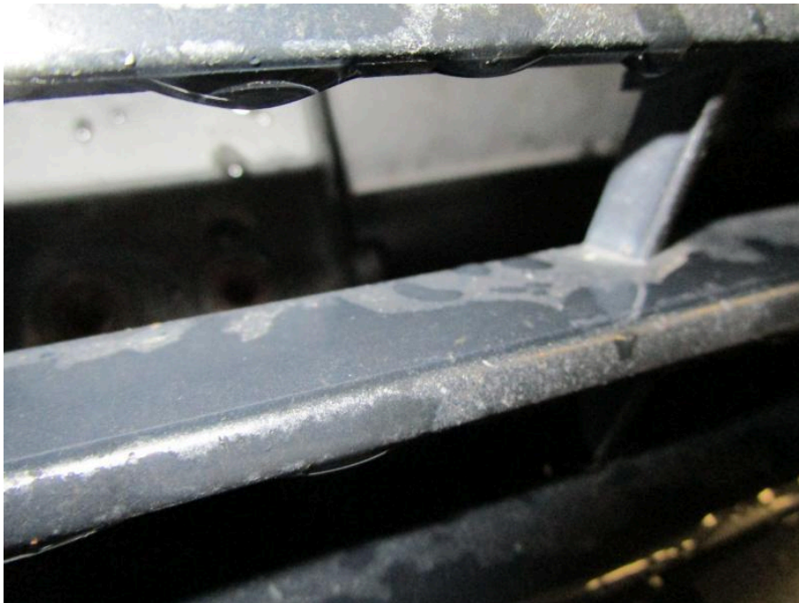
Bild 30 Fahrzeugfront Stoßfänger vorne Beschädigung Stoßfänger vorn / Luftführungsgitter / Kabel Parksensoren / Lüftungklappen beschädigt ( Unfallschaden ), Schadenerweiterung möglich
