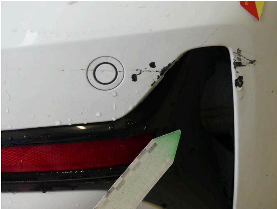
Bild 40 Fahrzeugheck Stoßfänger hinten angestoßen verformt
