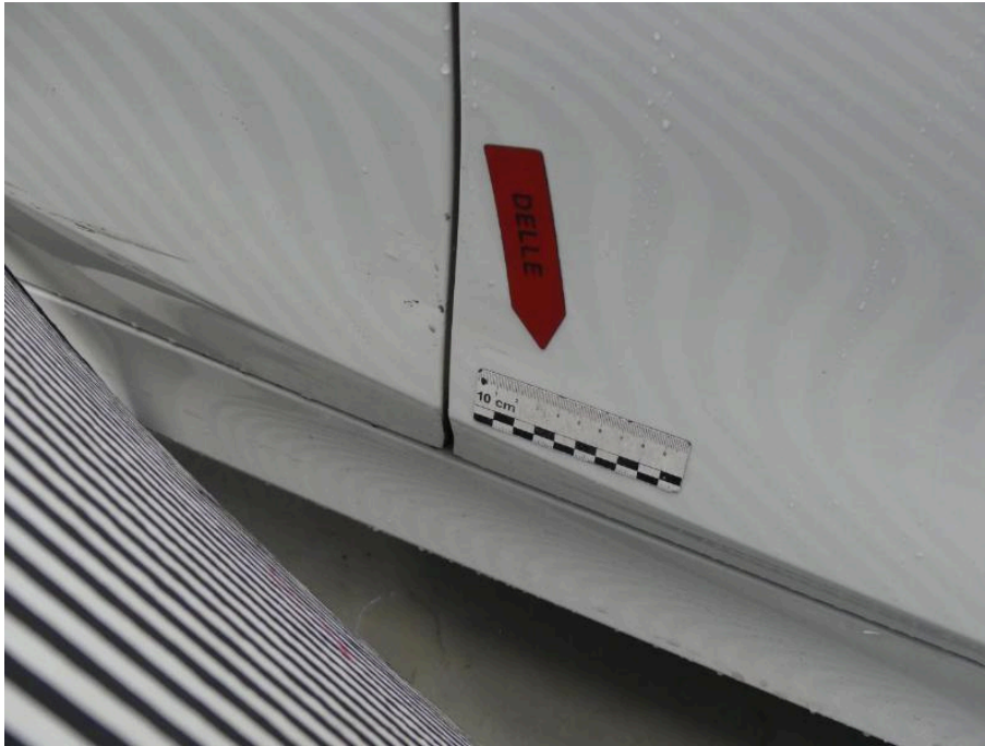
Bild 51 rechte Seite Tür hinten rechts Tür HR instandsetzen / Tür VR erneuern beschädigt
