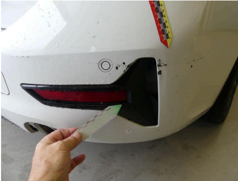
Bild 39 Fahrzeugheck Stoßfänger hinten angestoßen verformt
