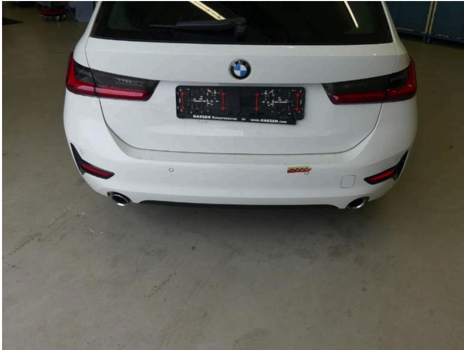
Bild 35 Fahrzeugheck Stoßfänger hinten angestoßen verformt
