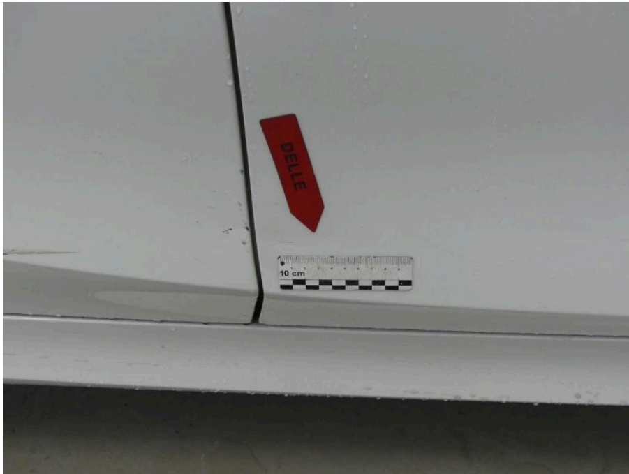
Bild 50 rechte Seite Tür hinten rechts Tür HR instandsetzen / Tür VR erneuern beschädigt
