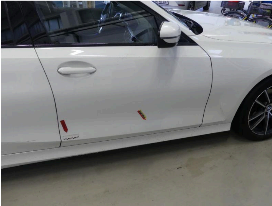
Bild 47 rechte Seite Tür hinten rechts Tür HR instandsetzen / Tür VR erneuern beschädigt
