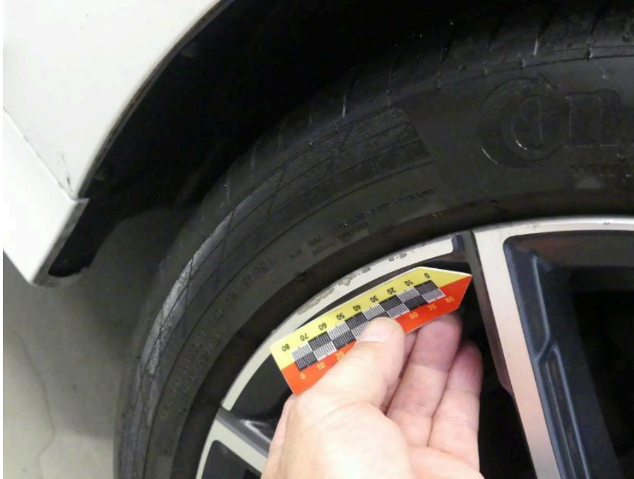
Bild 57 Vorderachse Felge vorne rechts Materialabtrag
