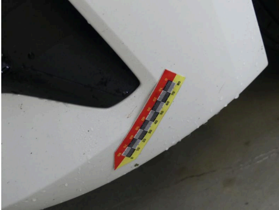
Bild 27 Fahrzeugfront Stoßfänger vorne Beschädigung Stoßfänger vorn / Luftführungsgitter / Kabel Parksensoren / Lüftungklappen beschädigt ( Unfallschaden ), Schadenerweiterung möglich
