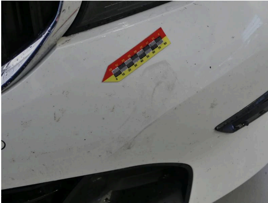
Bild 25 Fahrzeugfront Stoßfänger vorne Beschädigung Stoßfänger vorn / Luftführungsgitter / Kabel Parksensoren / Lüftungklappen beschädigt ( Unfallschaden ), Schadenerweiterung möglich
