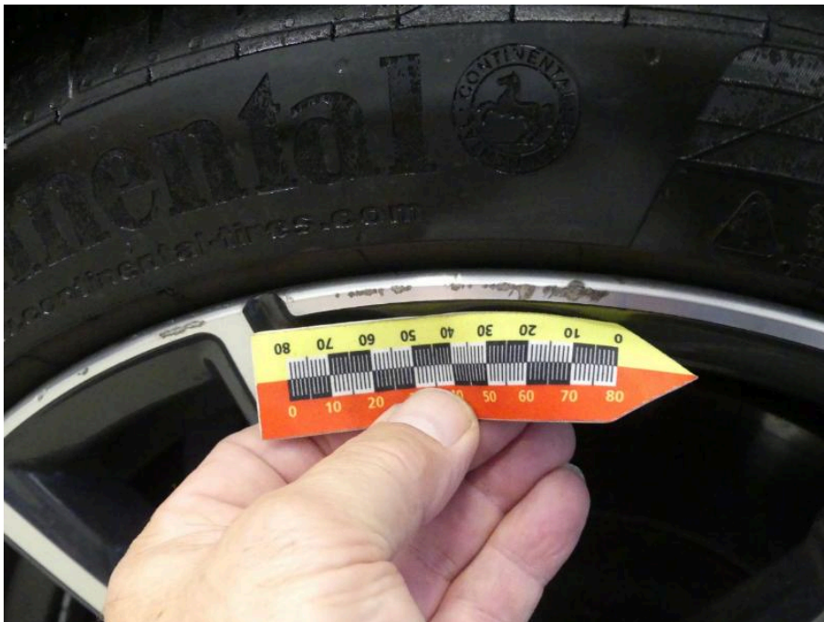
Bild 56 Vorderachse Felge vorne rechts Materialabtrag
