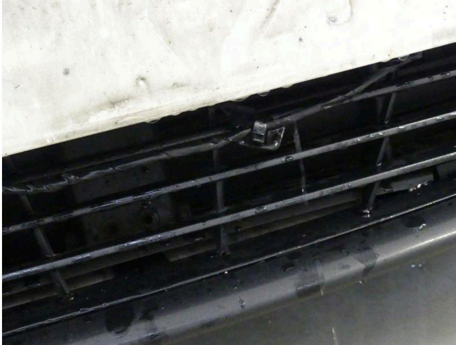
Bild 23 Fahrzeugfront Stoßfänger vorne Beschädigung Stoßfänger vorn / Luftführungsgitter / Kabel Parksensoren / Lüftungklappen beschädigt ( Unfallschaden ), Schadenerweiterung möglich
