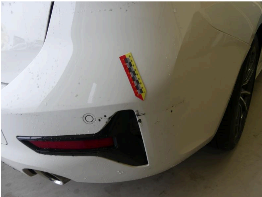
Bild 38 Fahrzeugheck Stoßfänger hinten angestoßen verformt
