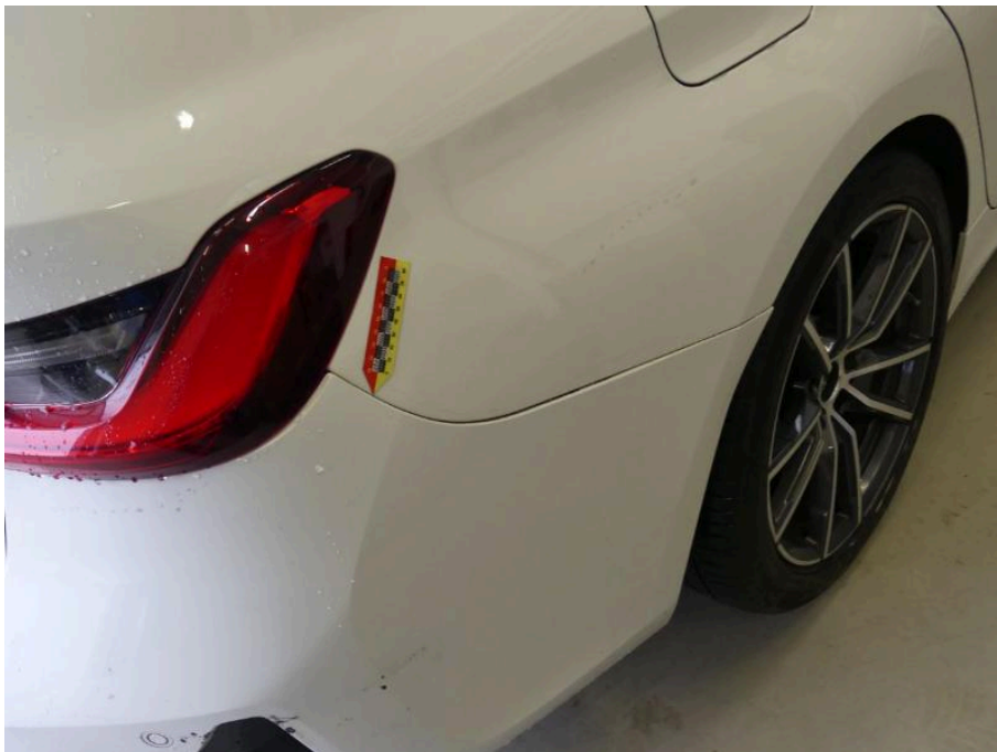
Bild 42 Fahrzeugheck Stoßfänger hinten angestoßen verformt
