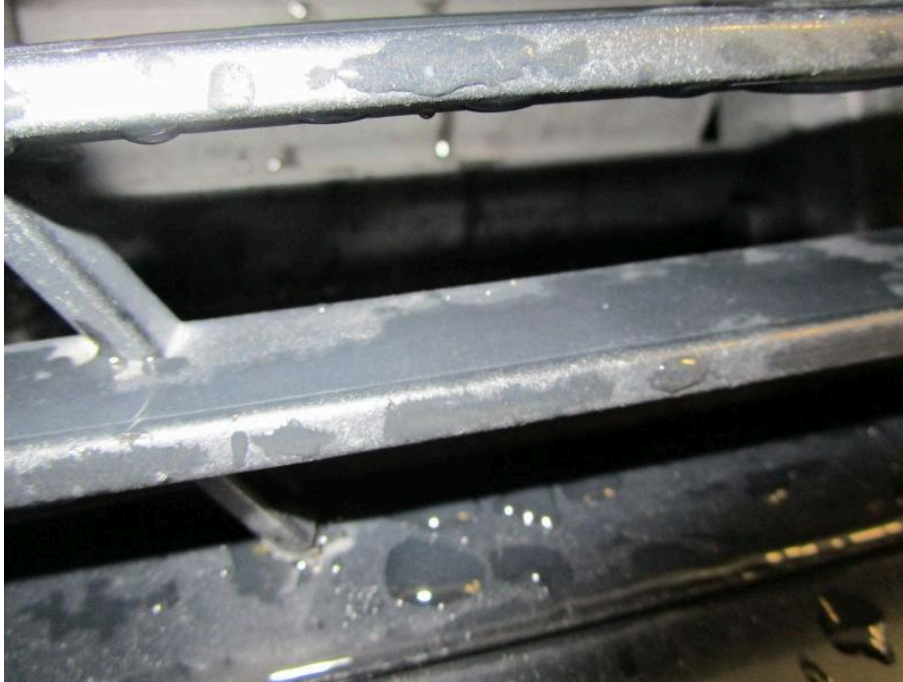
Bild 31 Fahrzeugfront Stoßfänger vorne Beschädigung Stoßfänger vorn / Luftführungsgitter / Kabel Parksensoren / Lüftungklappen beschädigt ( Unfallschaden ), Schadenerweiterung möglich
