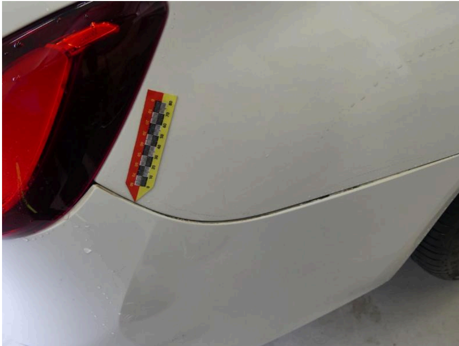
Bild 43 Fahrzeugheck Stoßfänger hinten angestoßen verformt
