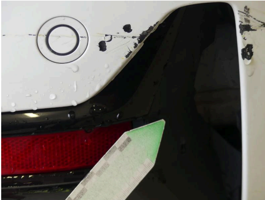
Bild 41 Fahrzeugheck Stoßfänger hinten angestoßen verformt
