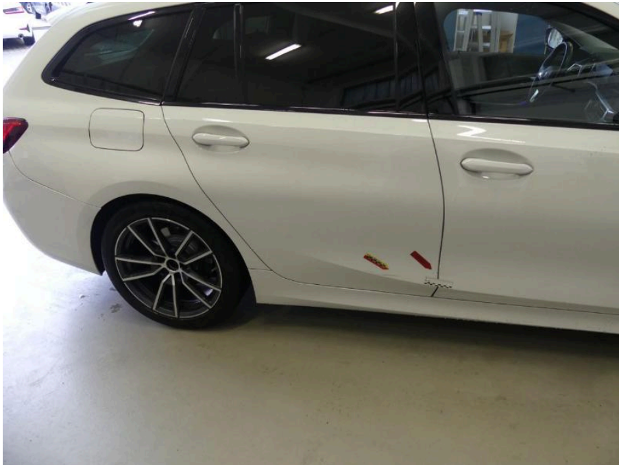
Bild 44 rechte Seite Tür hinten rechts Tür HR instandsetzen / Tür VR erneuern beschädigt
